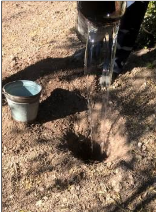
Foto 2 Vertiendo agua en la calicata para empezar el ensayo
