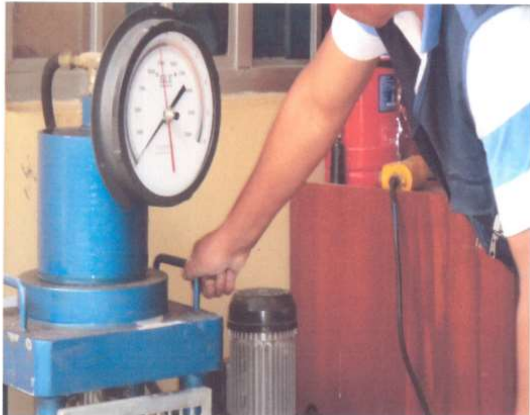
LABORATORIO DE ENSAYOS: ROTURA DE PROBETAS DE CONCRETO DE LOSA RIGIDA Y MUROS DE CONTENCIÓN CON ENSAYOS DE COMPRESIÓN SIMPLE, EJECUTADOS EN PRESENCIA DEL RESIDENTE DE OBRA.
