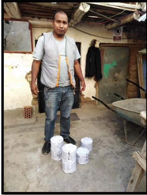
**Descripcion.** Luego de realizar el ensayo de CBR las muestras se dejan secar y se cubren de tal manera que no se deterioren por el medio ambiente para poder ensayar mediante Guilow.
