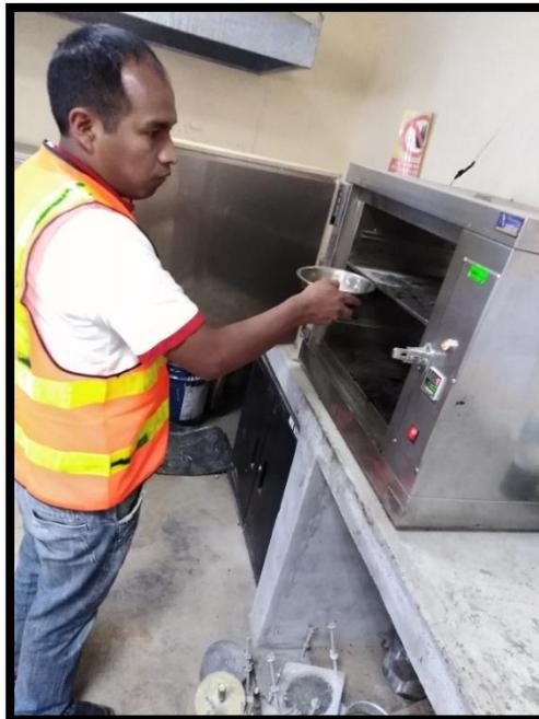
**Descripcion.** Para el contenido de humedad se utilizó el horno electrónico el cual garantiza una mejor precisión de los datos obtenidos.
