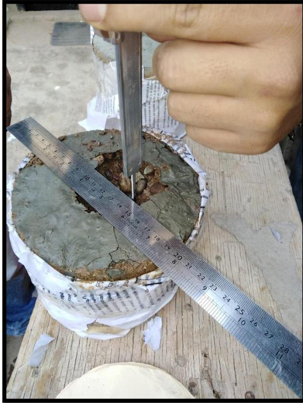
**Descripcion.** Luego de producirse la erosión se procede a medir la profundidad y el radio de la erosión.
