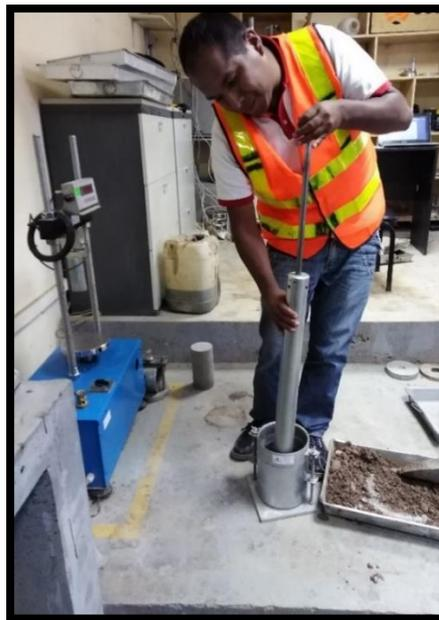
**Descripcion.** Para el ensayo de CBR es necesario compactar en 5 capas con 56 golpes por cada capa o estrato.
