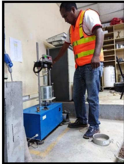
**Descripcion.** Se puede observar el ensayo de CBR en la prensa de Marshall el cual nos da los datos de esfuerzo y penetración.
