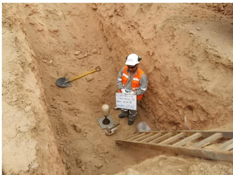
*Figura 16. Sondeo de densidad de campo de la muestra en cada una de las calicatas*
