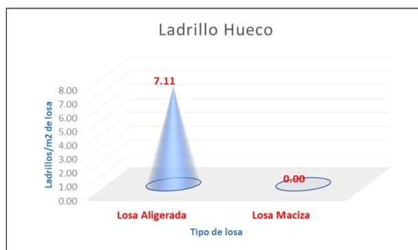
**Figura 63: Cantidad de ladrillo hueco en losas**
