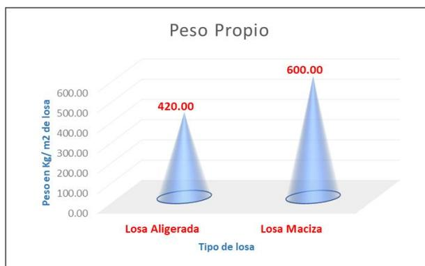
**Figura 67: Peso propio en losas**
