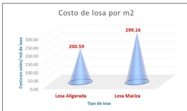
**Figura 70: Costo de losas por m<sup>2</sup>**
