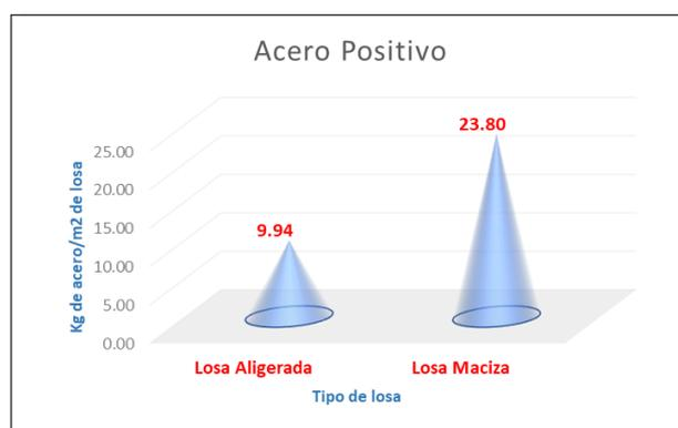
**Figura 64: Cantidad de acero positivo en losas**
