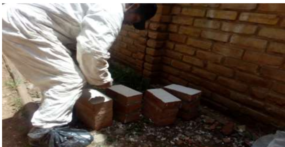
Figura 78. Recubrimiento con yeso de los prismas de ladrillos FUENTE: Elaboración Propia
