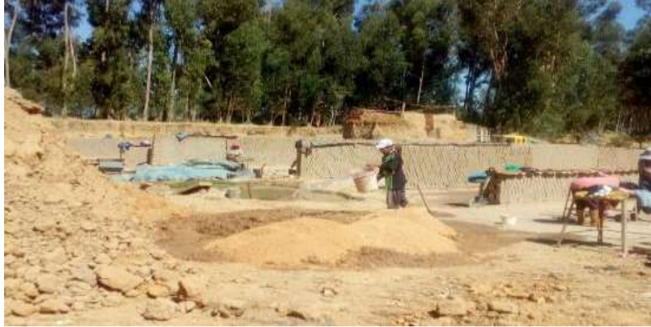
Figura 13. Dosificación para el ladrillo artesanal FUENTE: Imagen Propia
