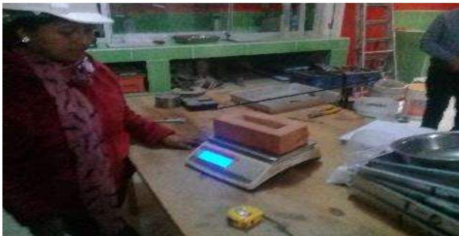
Figura 73. Pesaje de muestras y de ensayo de absorción FUENTE: Imagen Propia
