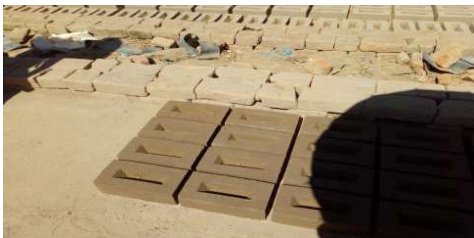
Figura 50. Secado de ladrillo puzolánico FUENTE: Imagen Propia
