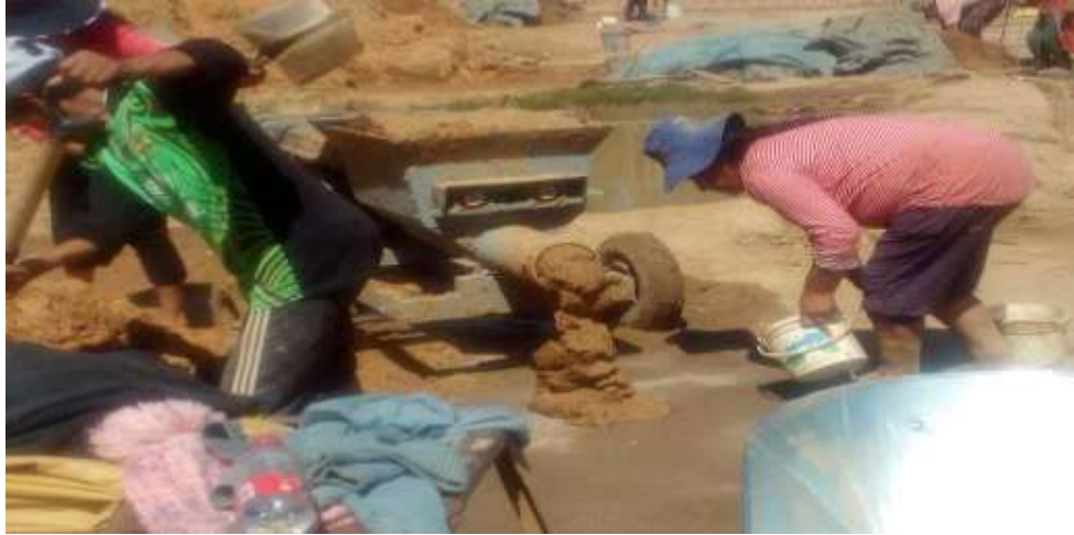
Figura 42. Mezclado de masa cerámica con ayuda de equipo FUENTE: Imagen Propia
