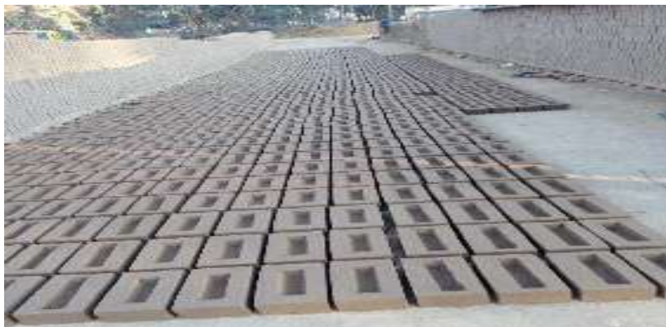
Figura 16. Secado del ladrillo artesanal al ambiente FUENTE: Imagen Propia
