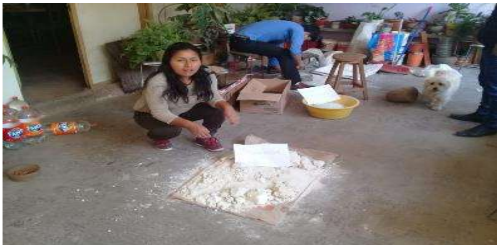
Figura 47. Secado de la puzolana recolectada FUENTE: Imagen Propia
