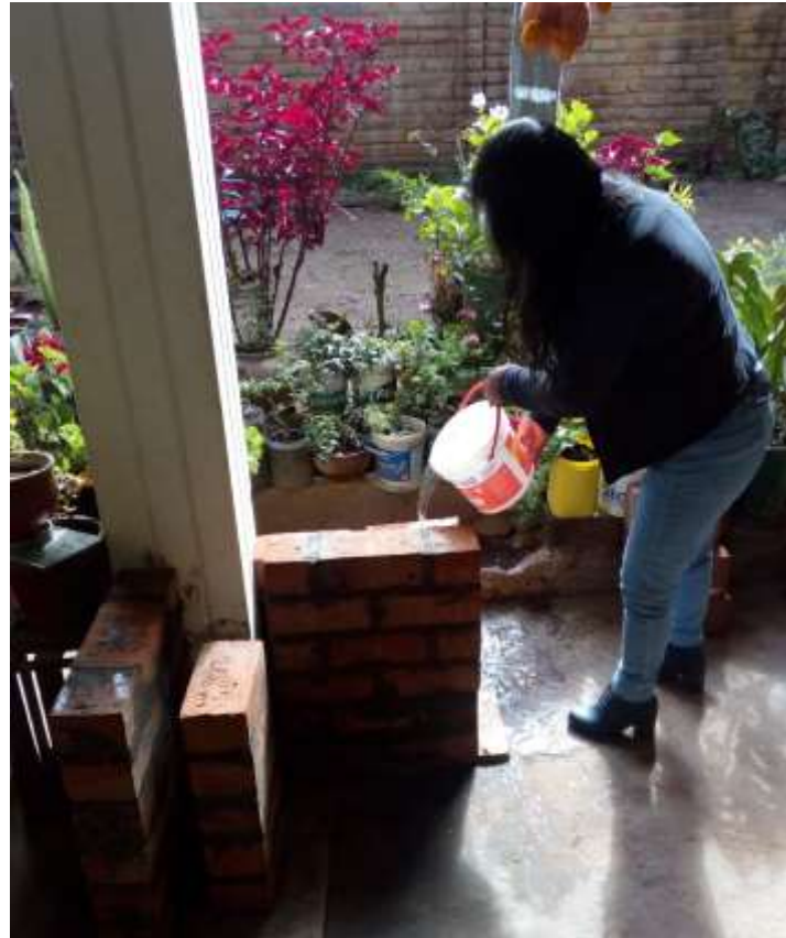
Figura 66. Curado de Muretes FUENTE: Elaboración Propia
