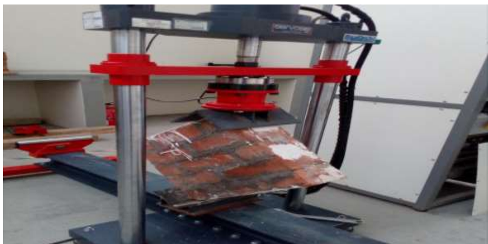
Figura 85. Murete de ladrillo artesanal en la máquina de compresión diagonal FUENTE: Imagen Propia
