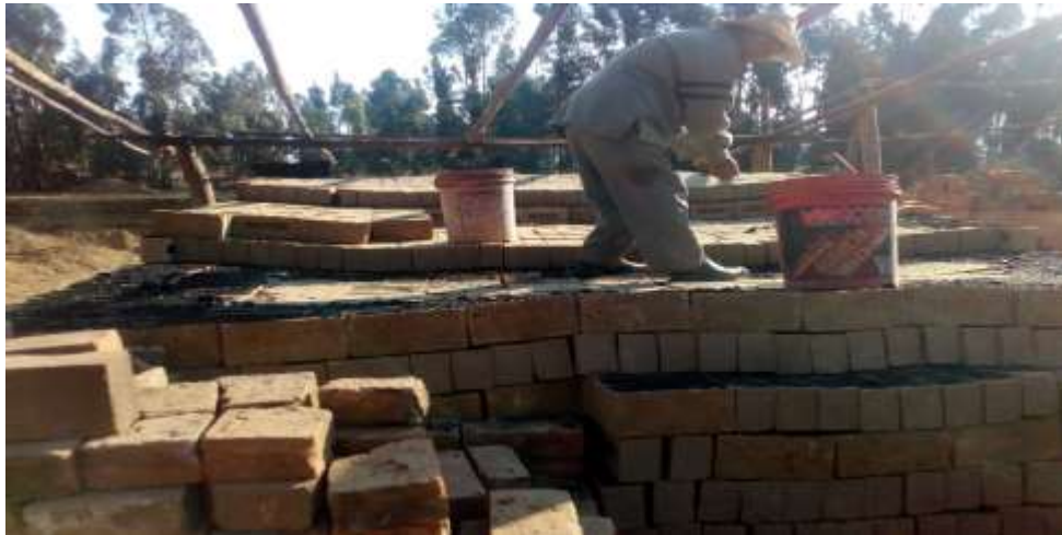
Figura 17. Preparación del horno para calcinado de ladrillos FUENTE: Imagen Propia
