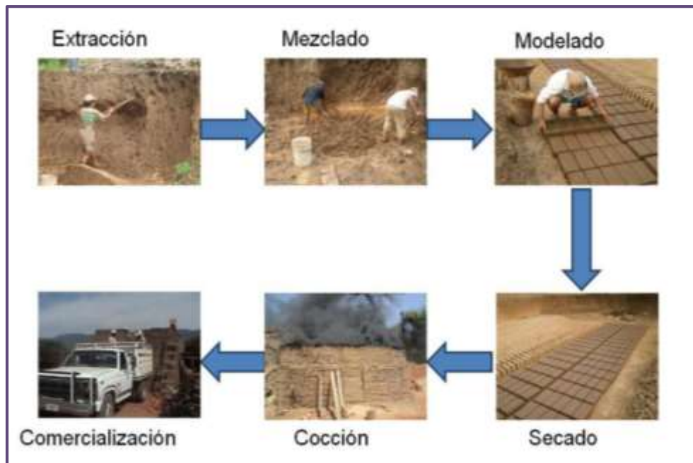
Figura 11. Proceso de fabricación del ladrillo FUENTE: Guía De Proceso de Fabricación
