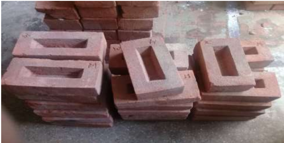
Figura 67. Muestras para los ensayos físicos FUENTE: Elaboración Propia
