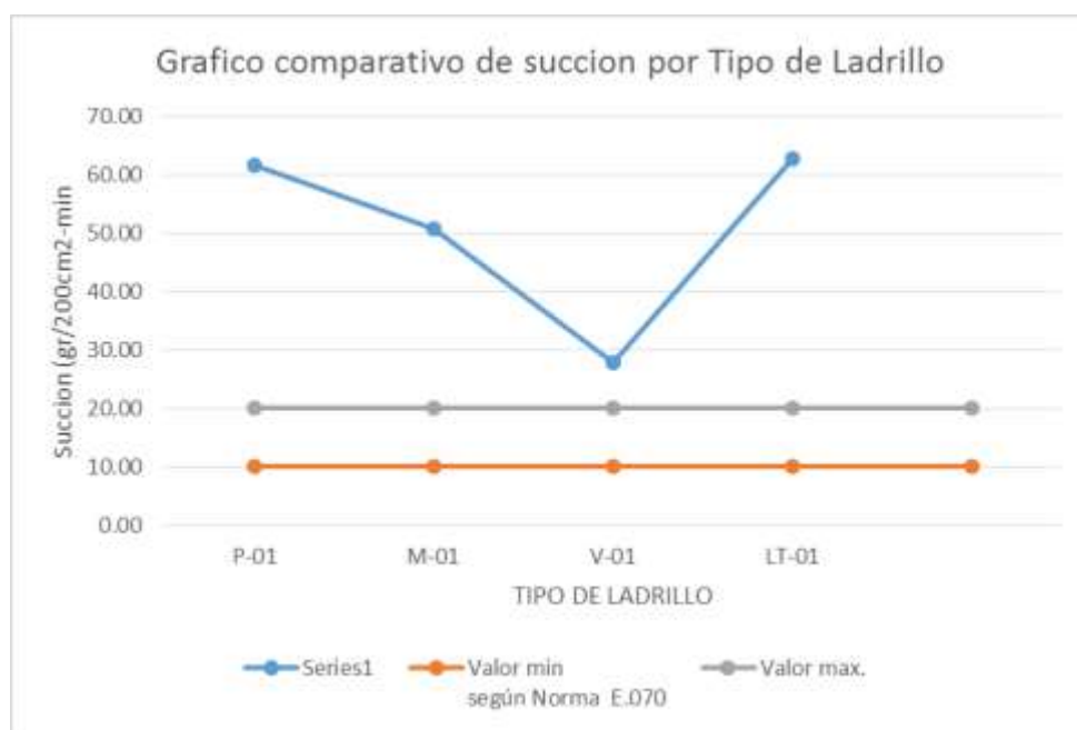
Figura 105. Gráfico comparativo de succión por cada tipo de ladrillo FUENTE: Elaboración Propia
