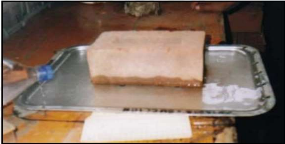
Figura 75. Proceso de Succión de los ladrillos de arcilla FUENTE: Imagen Propia
