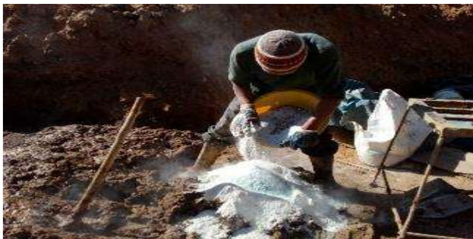
Figura 54. Incorporación del vidrio triturado en la masa cerámica FUENTE: Imagen Propia
