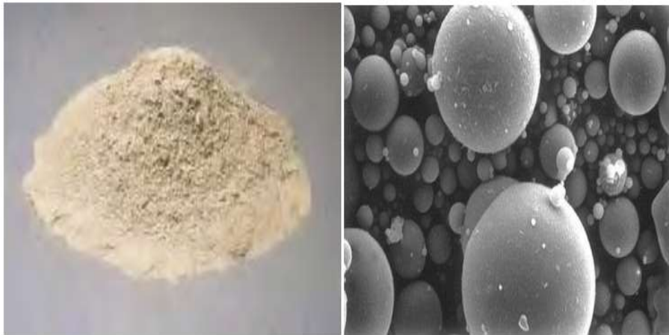
Figura 5. Ceniza volante y micrografía de partículas de ceniza volante Fuente: Villegas Martínez 2012
