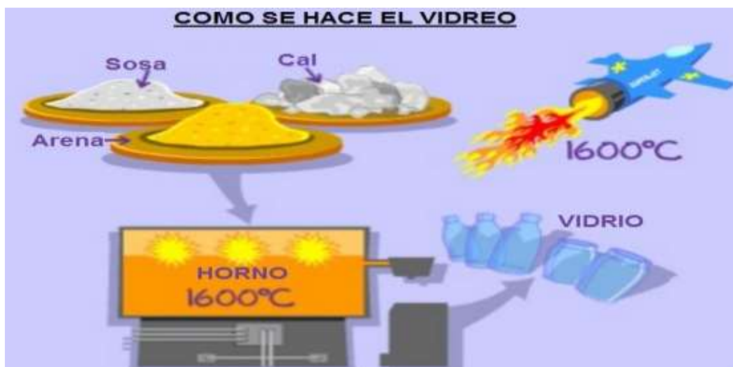
Figura 7. Insumos requeridos para la fabricación del vidrio FUENTE: Imágenes Google
