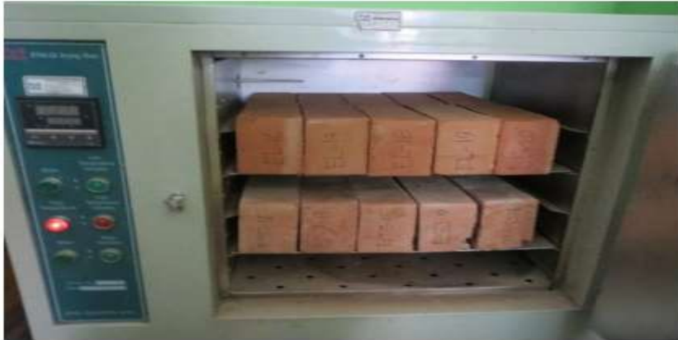
Figura 77. Muestras puestas al horno para ser secadas FUENTE: Imagen Propia
