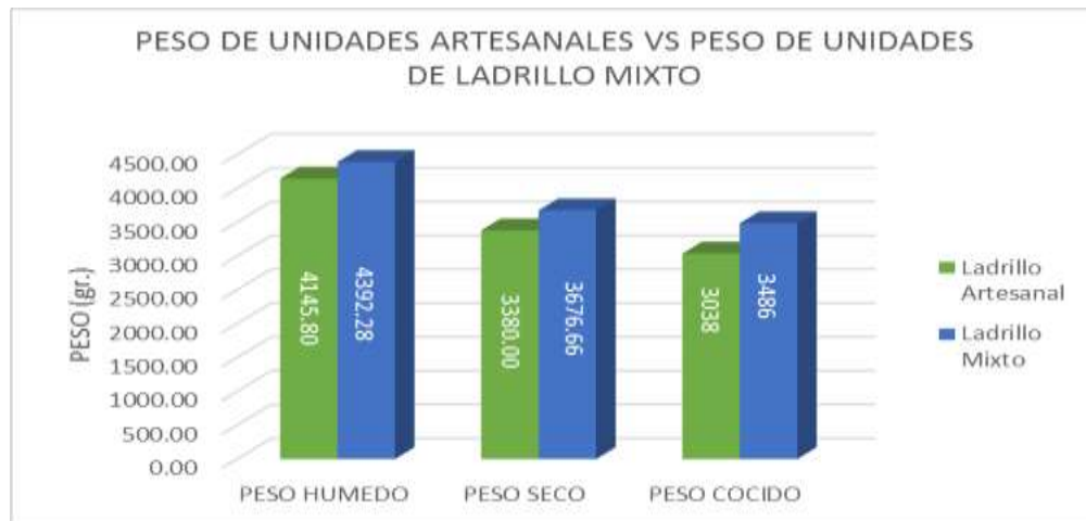
Figura 56. Comparación de pesajes del ladrillo artesanal con el ladrillo mixto FUENTE: Elaboración Propia
