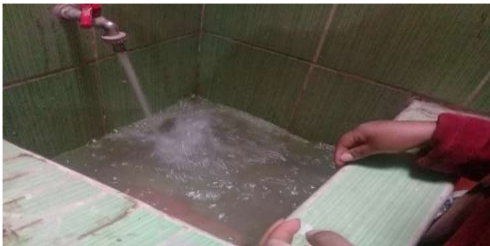
Figura 76. Muestras sumergidas en agua para ensayo de absorción FUENTE: Imagen Propia
