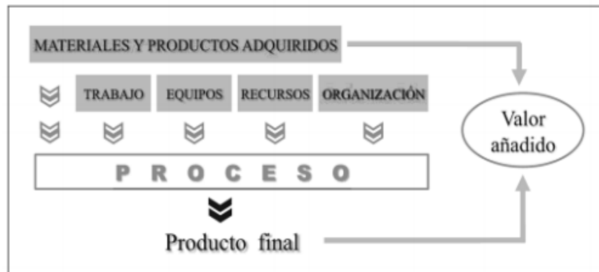
Figura N°07 - Componentes de un sistema de producción
