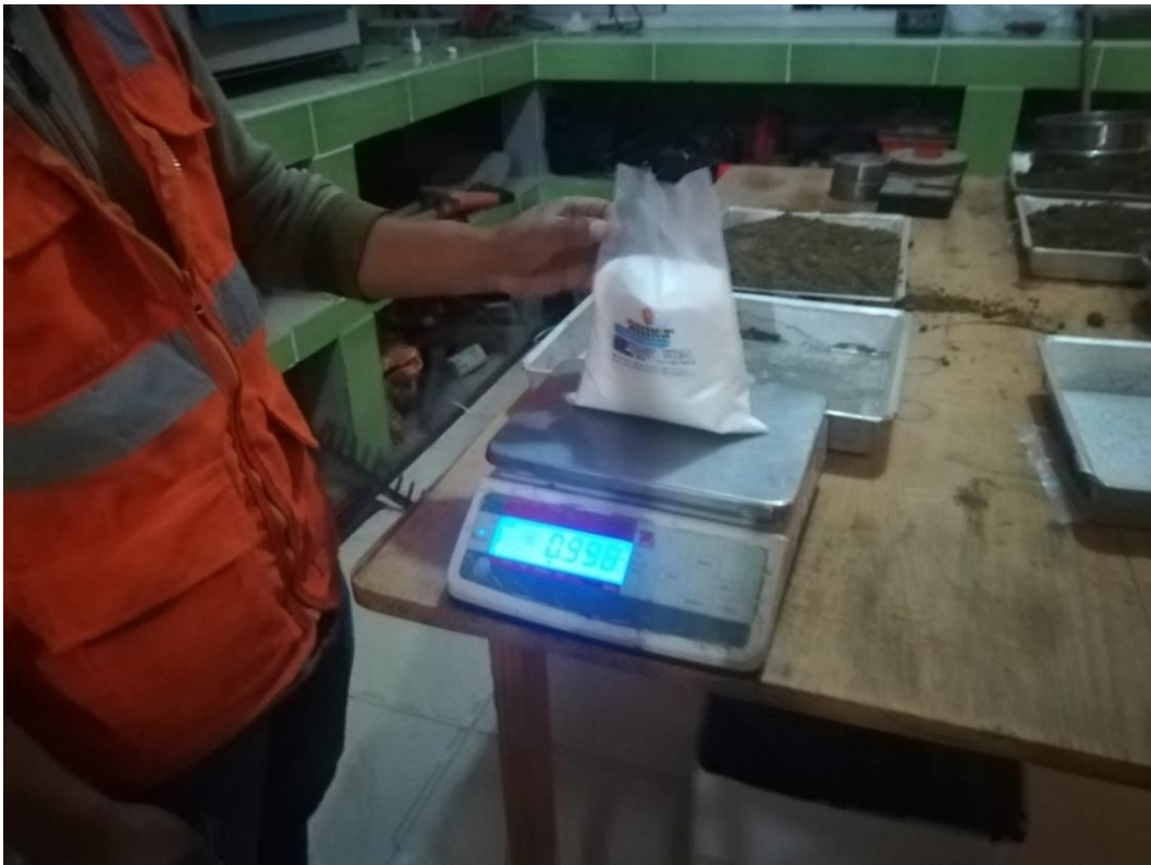
Fotografía 10. Pesaje de la cantidad de cloruro de magnesio hexahidratado.
