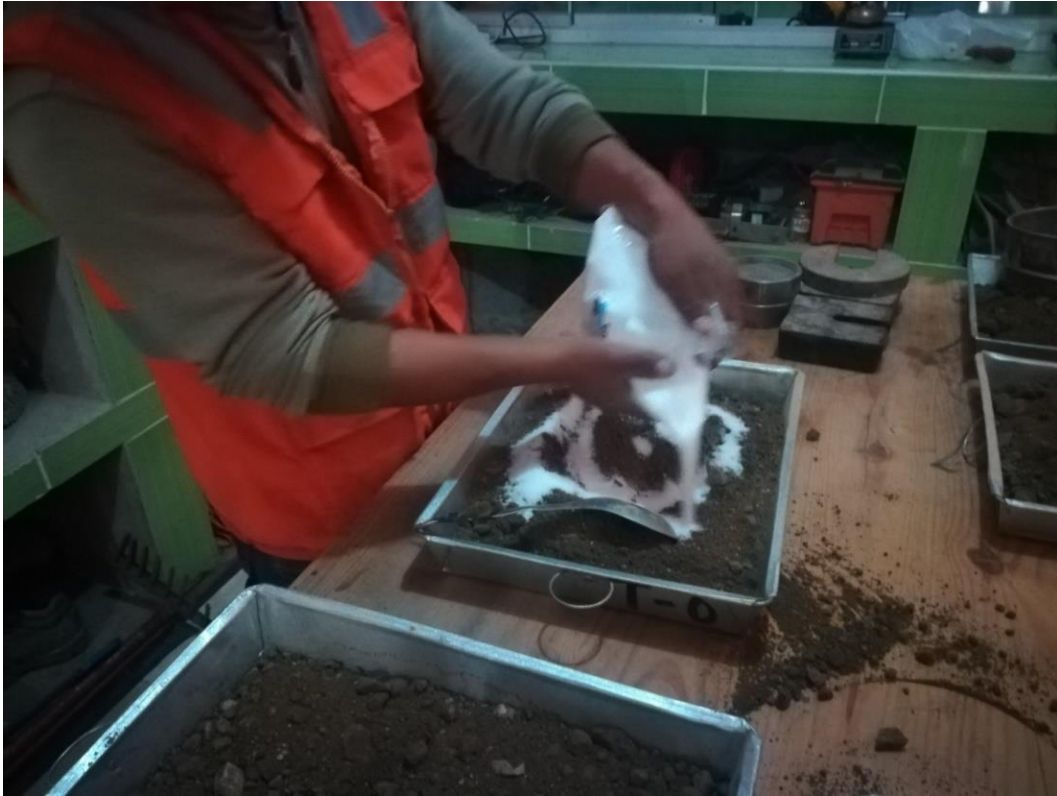
Fotografía 11. Mezcla del cloruro de magnesio hexahidratado con las muestras al 2 %.
