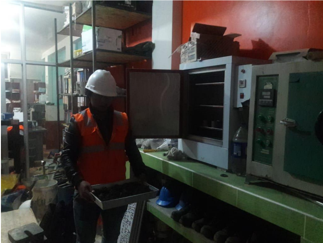
Fotografía 7. Extracción de muestras de suelo de horno
