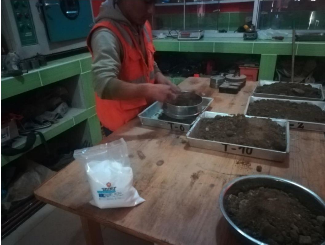
Fotografía 9. Preparación de suelo para su posterior mezcla con el cloruro de magnesio hexahidratado.
