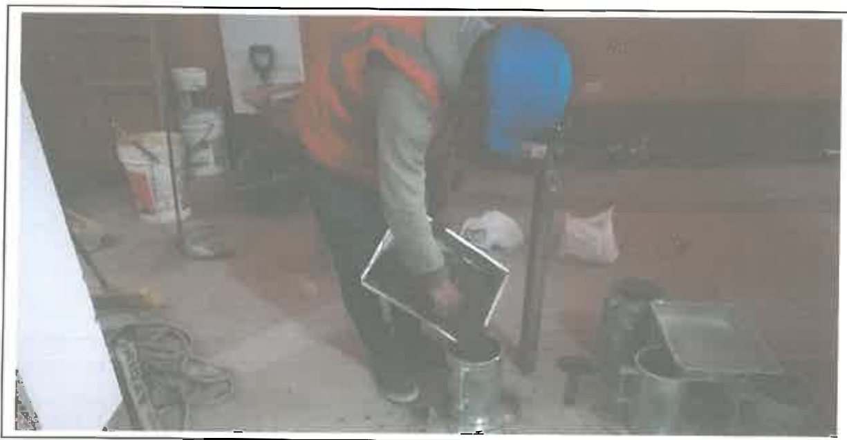
FOTO 19.- INFLUENCIA DEL CLORURO DE MAGNESIO HEXAHIDRATADO EN LAS PROPIEDADES DE LA SUBRASANTE EN CARRETERAS NO PAVIMENTADAS – BASEANDO LA MUESTRA MEZCLADA EN EL MOLDE PARA EL ENSAYO DE CBR.
