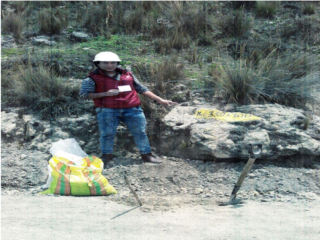
Fotografía 1. Extracción de muestras de suelo en la muestra de suelo 339+100.
