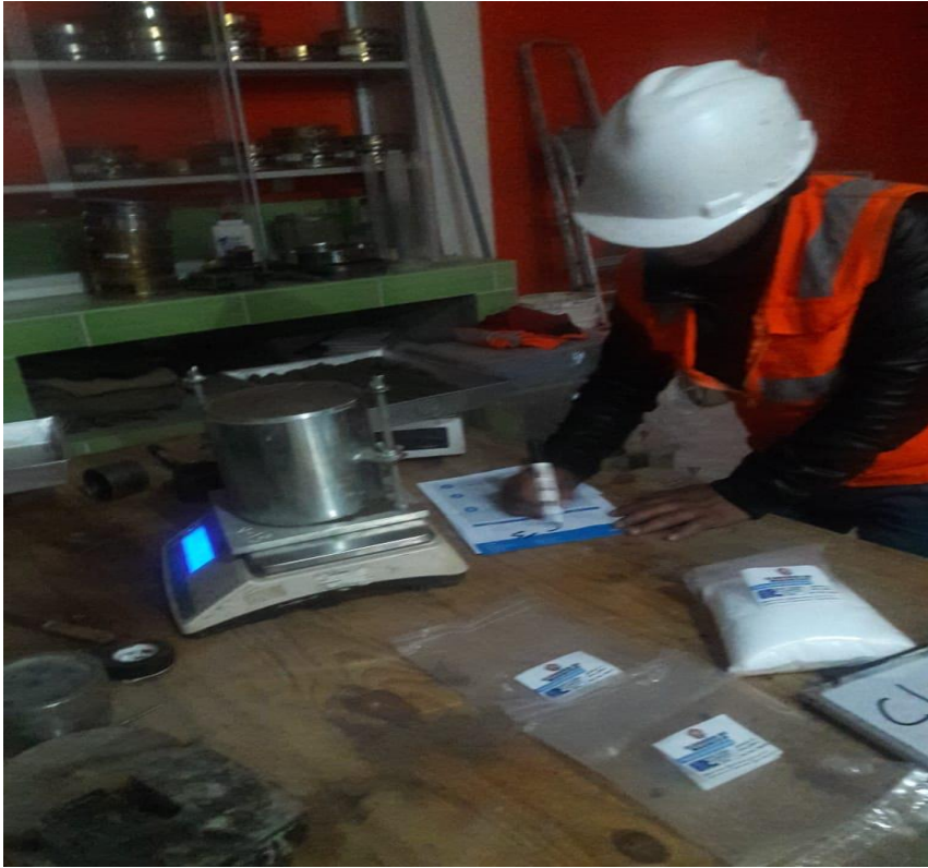
Fotografía 15. Pesaje de muestras para el ensayo Proctor modificado
