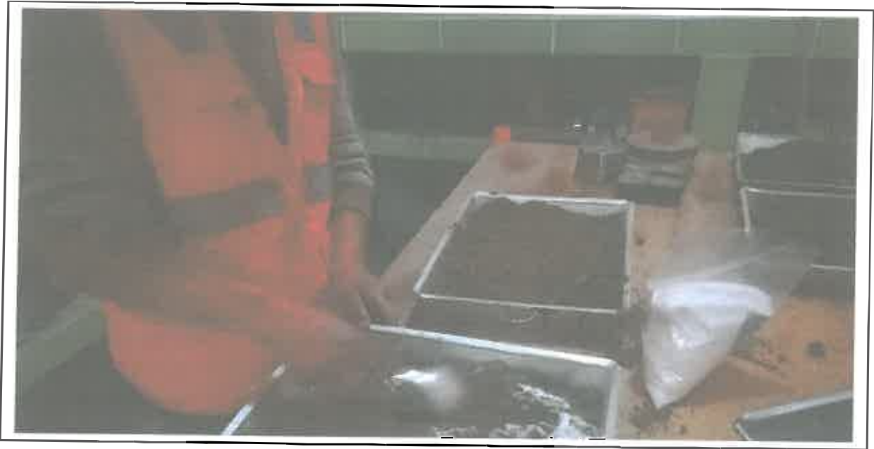
FOTO 09.- INFLUENCIA DEL CLORURO DE MAGNESIO HEXAHIDRATADO EN LAS PROPIEDADES DE LA SUBRASANTE EN CARRETERAS NO PAVIMENTADAS – MEZCLANDO EL CLORURO DE MAGNESIO CON LA MUESTRA.
