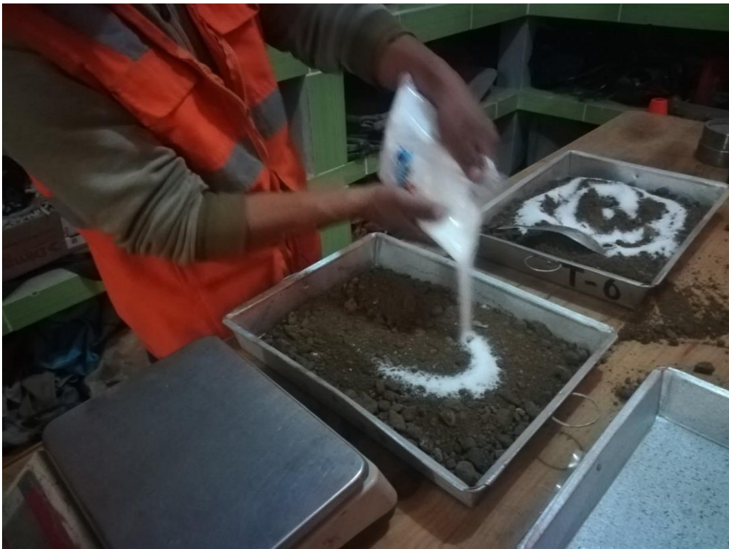
Fotografía 12. Mezcla del suelo en porcentaje del 3% de cloruro de magnesio hexahidratado.
