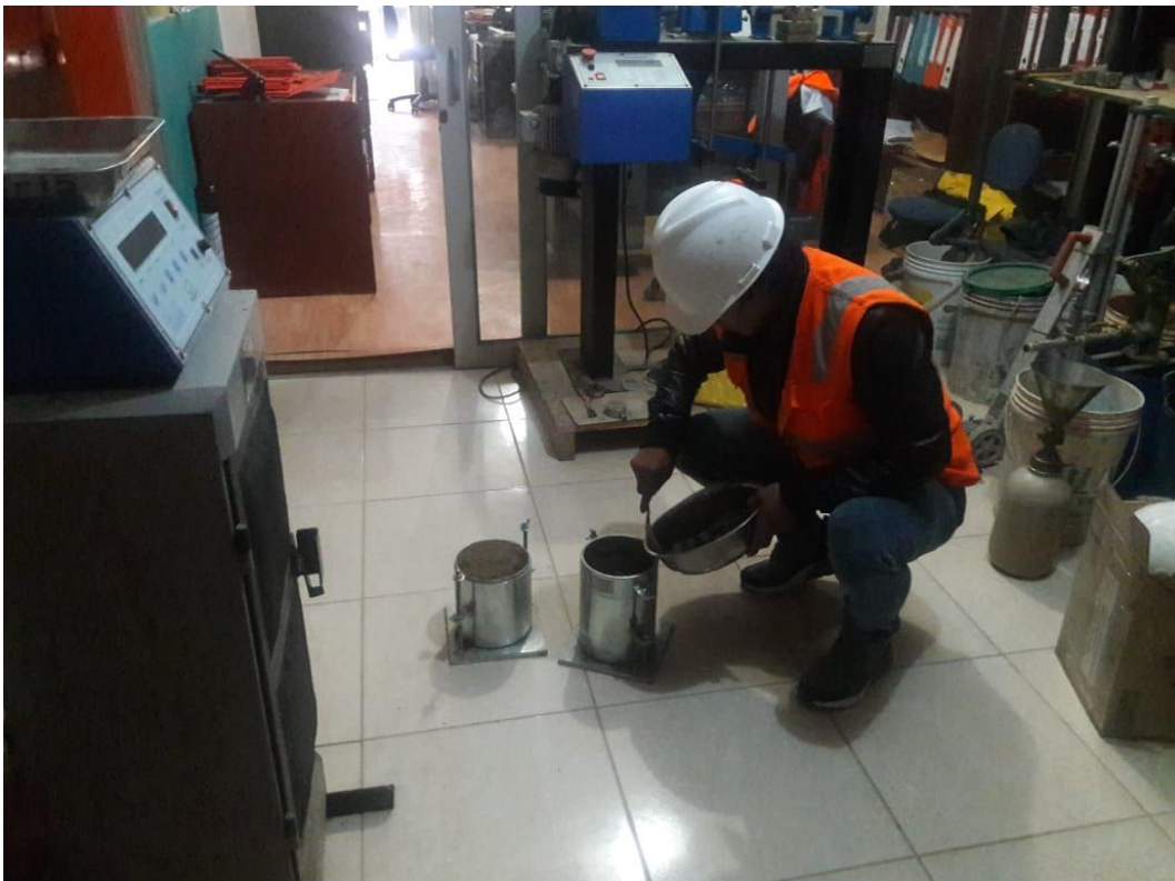
Fotografía 14. Preparación de muestras para ensayo Proctor modificado.
