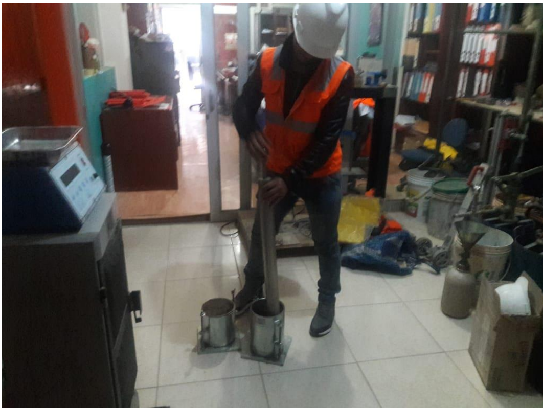
Fotografía 16. Ejecución del ensayo Proctor modificado.
