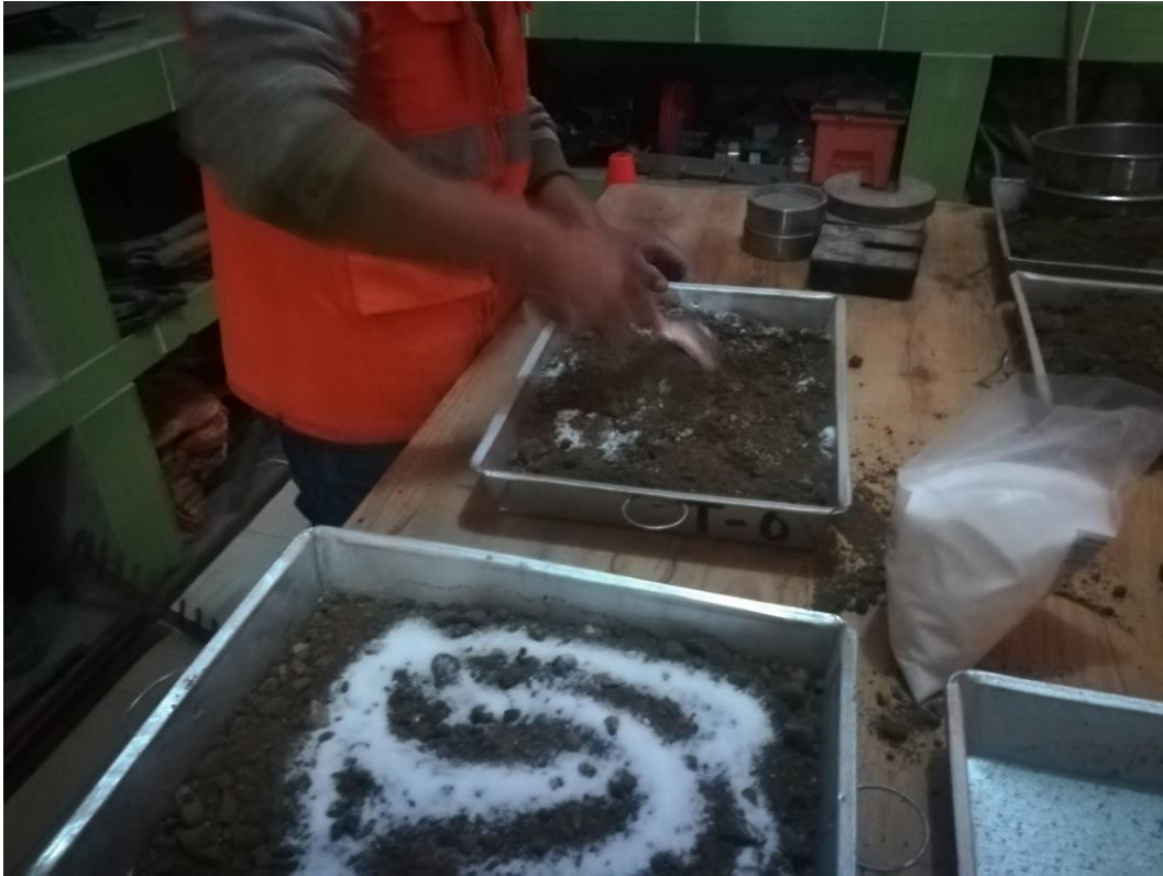
Fotografía 13. Mezclado uniforme del cloruro de magnesio con el suelo.
