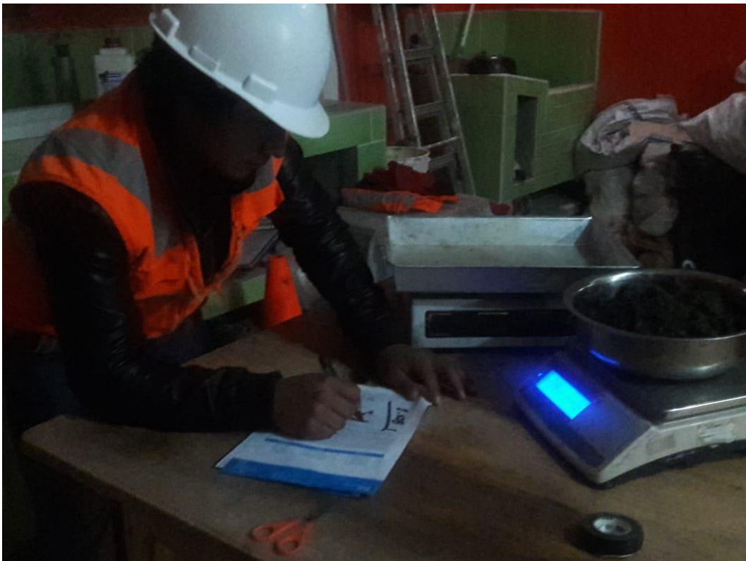
Fotografía 8. Pesaje de muestras de suelo.
