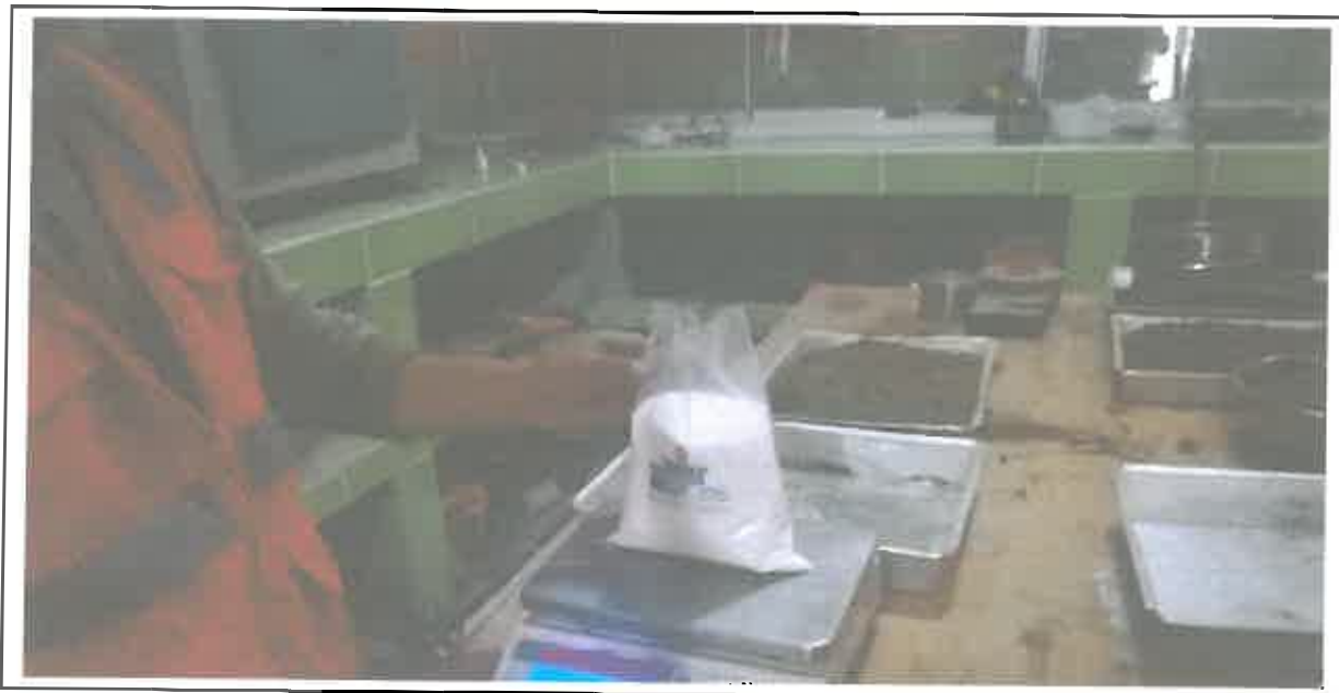
FOTO 03.- INFLUENCIA DEL CLORURO DE MAGNESIO HEXAHIDRATADO EN LAS PROPIEDADES DE LA SUBRASANTE EN CARRETERAS NO PAVIMENTADAS – PESANDO EL CLORURO DE MAGNESIO.
