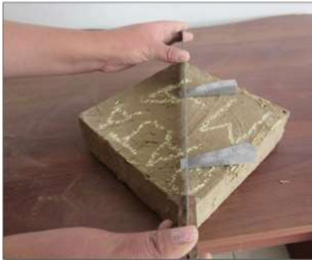
Fig. N° 3-31 Medición de alabeo
