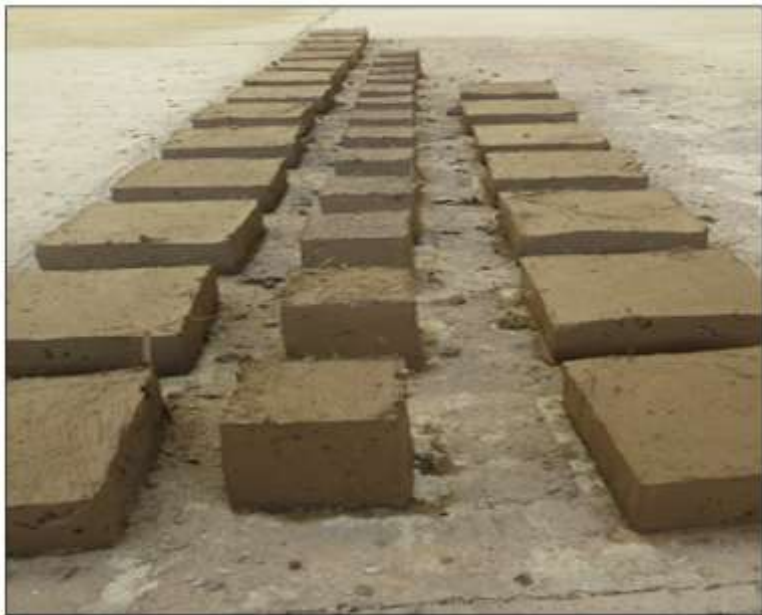
Fig. N° 3-26 Moldeado de adobe con paja
