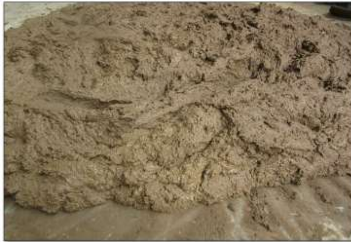
Fig. N° 3-18 Mezcla de barro reposado
