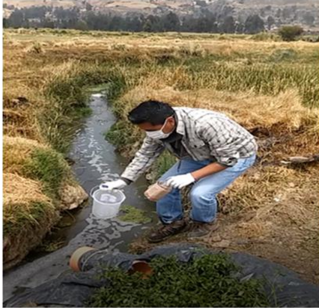
IMAGEN 11: TOMA DE MUESTRA . En esta imàgen se puede apreciar la toma de muestra para los respectivos análisis de ( DBO, DQO, COLIFORMES FECALES, SOLIDOS SUSPENDIDOS TOTALES) MUESTRA N°1,2, 3 y afluente.
