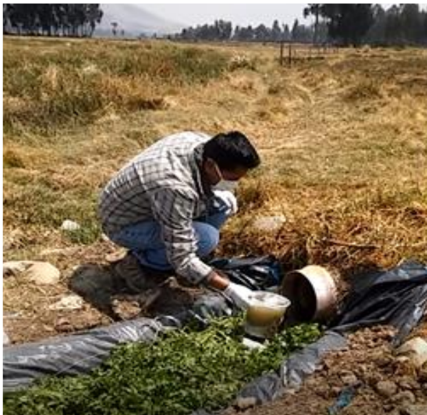
IMAGEN 12: TOMA DE MUESTRA . En esta imàgen se puede apreciar la toma de muestra para el respectos analisis de ( DBO, DQO, COLIFORMES FECALES, SOLIDOS SUSPENDIDOS TOTALES) MUESTRA N°3
