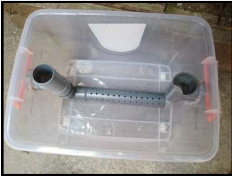
Figura 18. Construcciones de Cámara de filtro de arena de acuerdo a las especificaciones.
