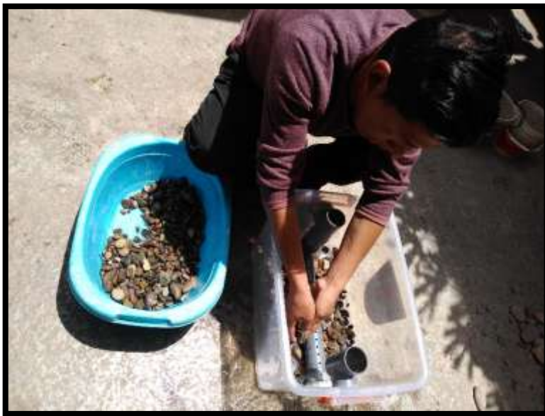
Figura 19. Colocación de los materiales grava y arena previamente lavados.
