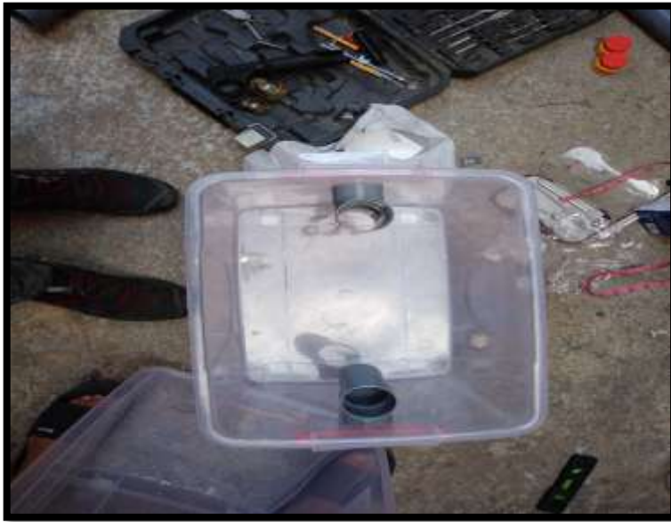
Figura 14. Trampa de grasa y sus componentes de entrada y salida según cálculos previos.
