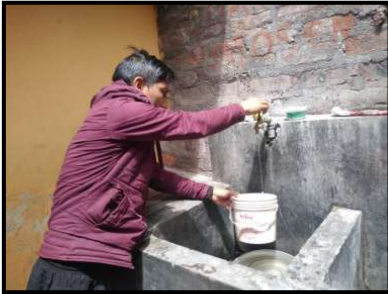
Figura 10. Aforo del caudal de lavaderos.
