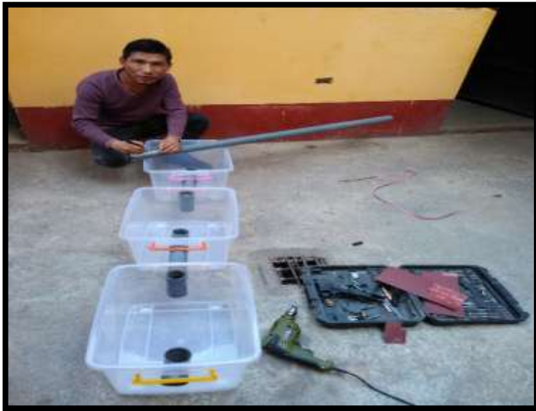
Figura 21. Diseño del esquema de proceso de filtración de aguas jabonosas.
