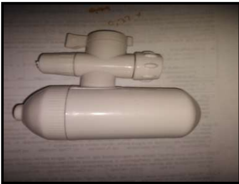
Figura 22. Filtro cerámico de fábrica, con capacidad de filtrado 2 litros por minuto
