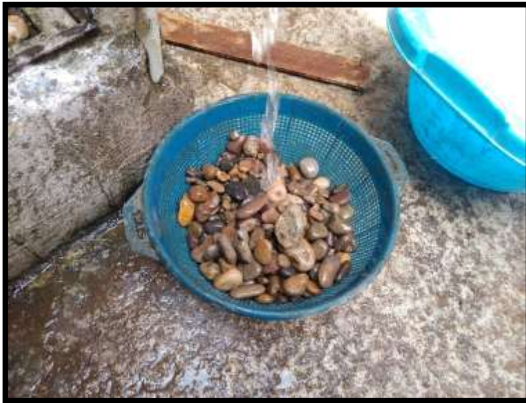
Figura 16. Lavado del material grava tal como indica las especificaciones.
