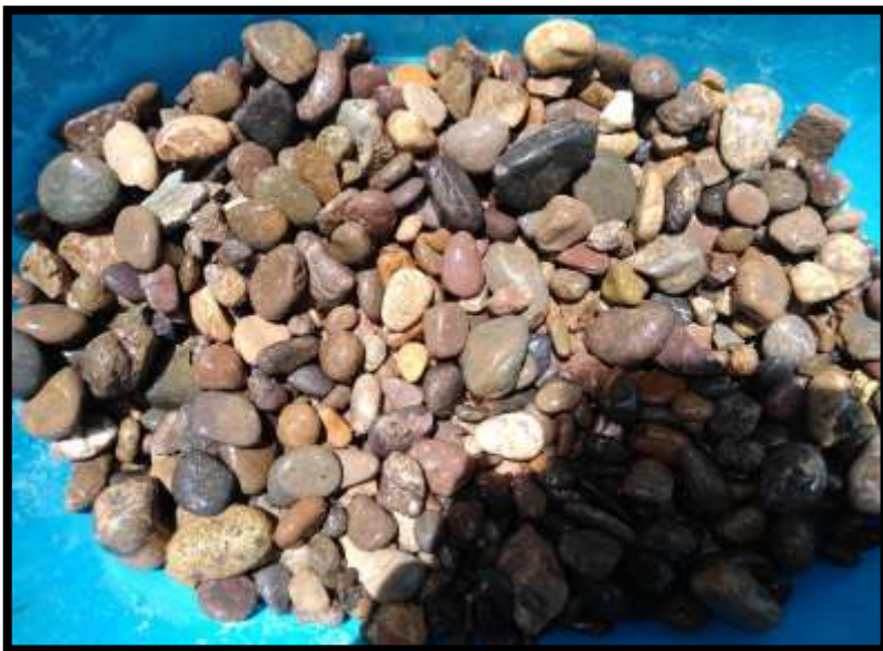
Figura 15. Selección de grava para la primera capa del filtro.
