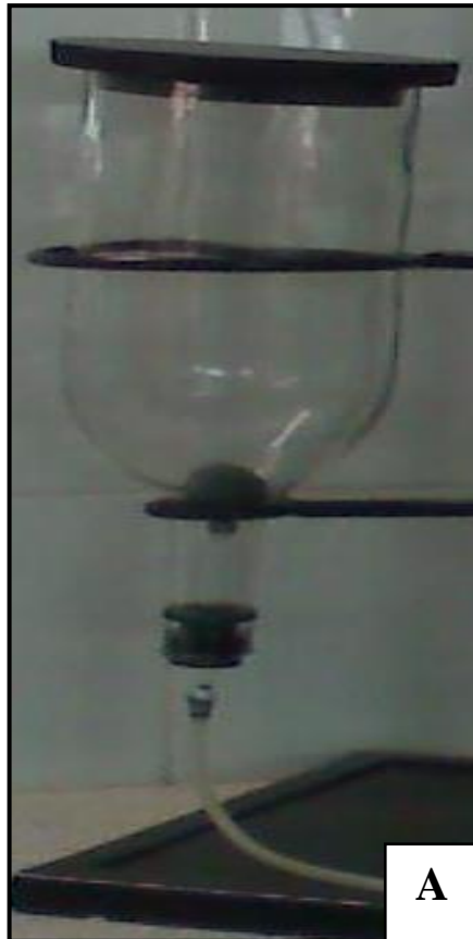
A: Biorreactor aireado permanentemente B: Biorreactor agitado mecánicamente
