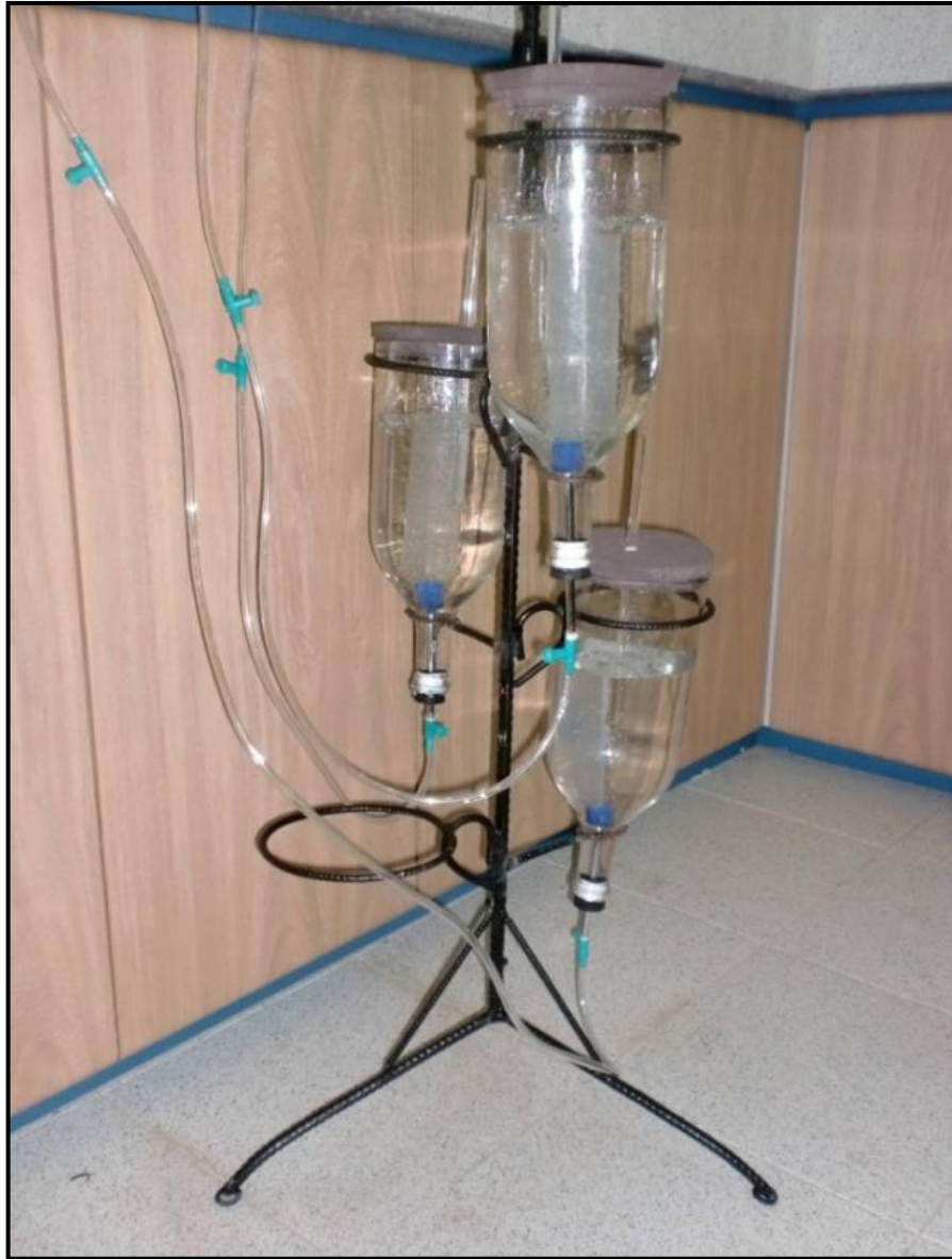
Detalle de la operación de tres biorreactores air lift de aireación interna
