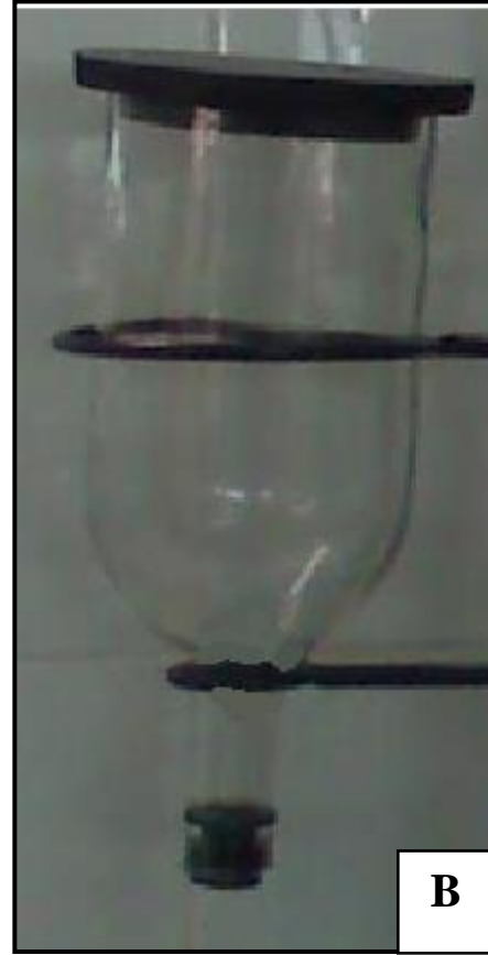
A: Biorreactor con aireación y agitación permanente B: Biorreactor sin aireación ni agitación
