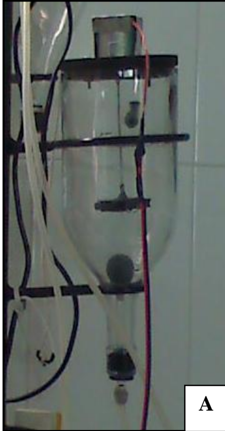
A: Biorreactor con aireación y agitación permanente B: Biorreactor sin aireación ni agitación
