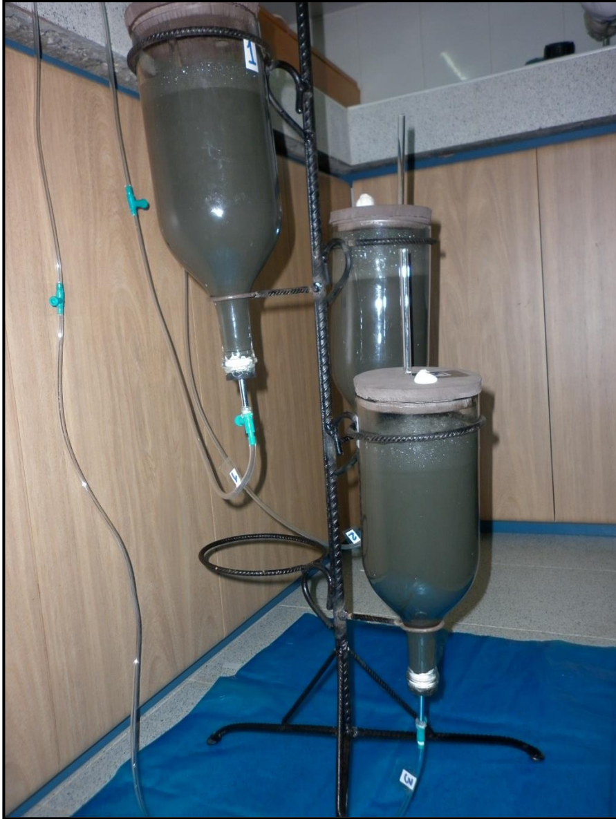
Detalle de la operación empleando tipos de biorreactores cilíndricos
