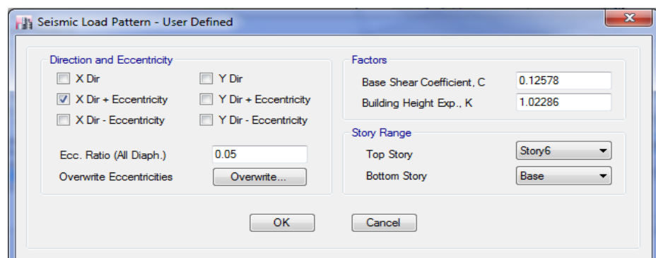
Fig. N° 3. 42 Parámetros para el análisis estático – Sismo X
