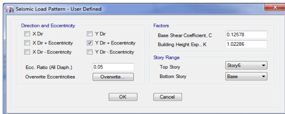
Fig. N° 3. 43 Parámetros para el análisis estático – Sismo Y
