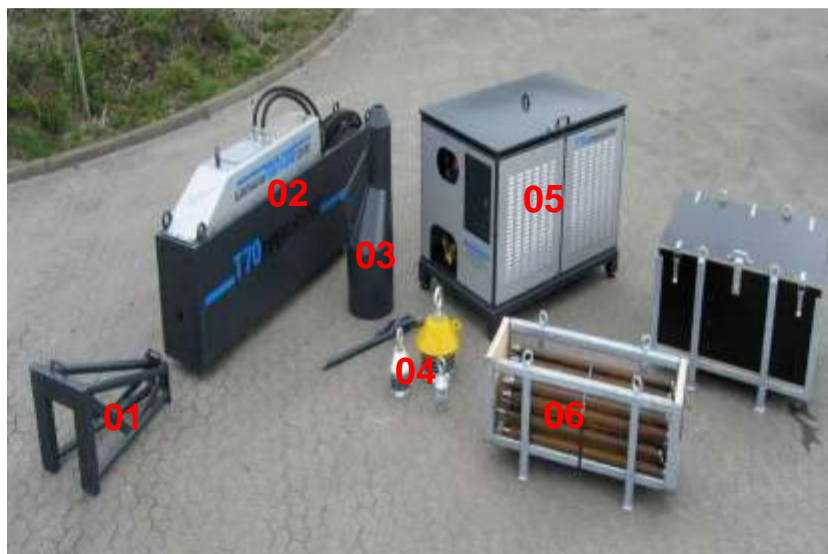
Figura N° 7: Equipos – Pipe Bursting estático.
