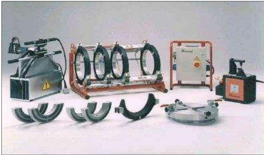
Figura N° 13: Equipos de termofusión y electrofusión.
