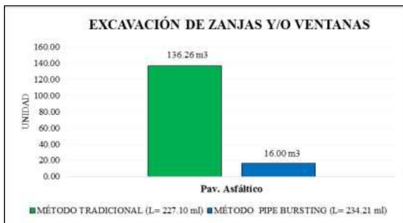
Gráfico N° 4: Excavación de zanja y/o ventanas de ambos métodos.
