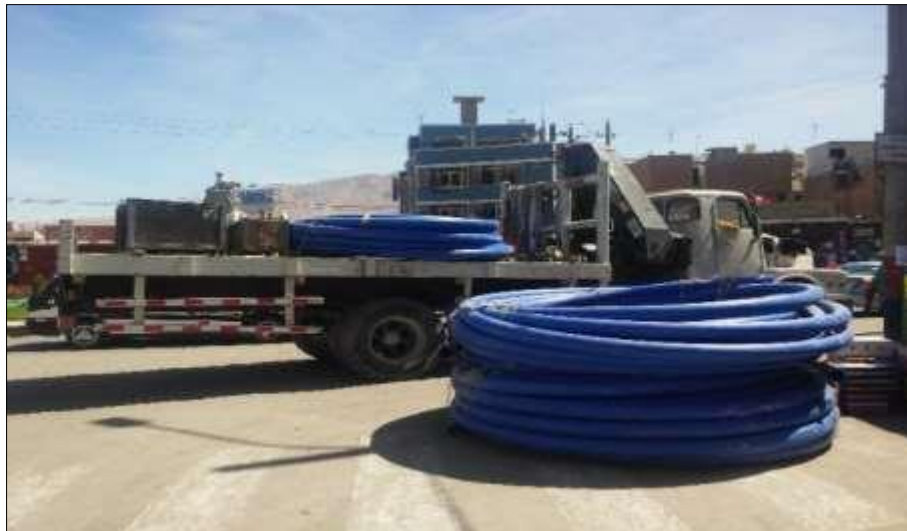
Figura N° 10: Tubería PE –100, Ø110mm.
