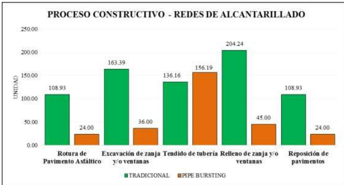
Gráfico N° 14: Proceso Constructivo - Alcantarillado
