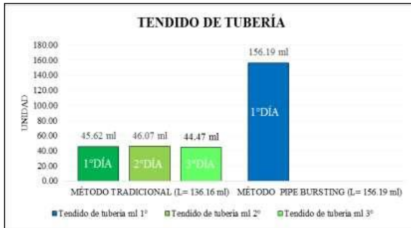
Gráfico N° 11: Tendido de tuberías de ambos métodos.
