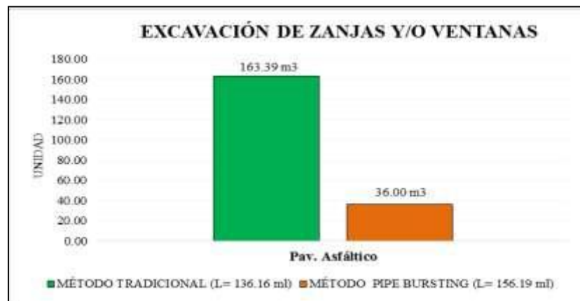
Gráfico N° 10: Excavación de zanjas y/o ventanas de ambos métodos.
