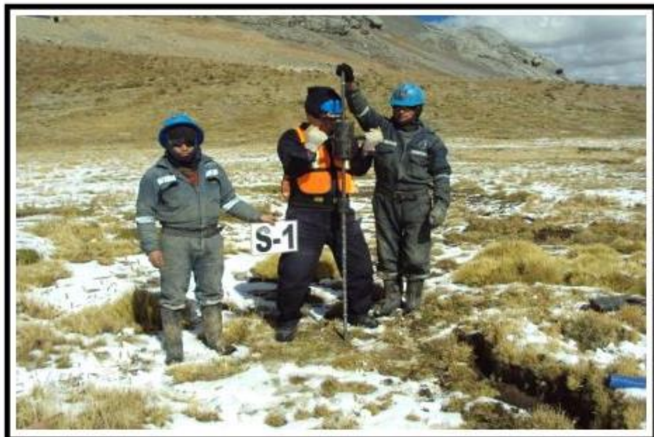
Fotografía 02 : Vista Mostrando el Sondaje (S-1), Realizado con Equipo de Penetración Dinámico (Cono de Peck) en la Cimentación de Depósito de Relaves "SANSIL" – Primera Etapa.
