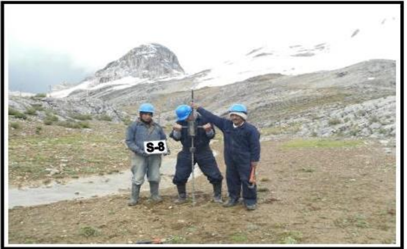
Fotografía 09 : Vista Mostrando el Sondaje (S-8), Realizado con Equipo de Penetración Dinámico (Cono de Peck) en la Cimentación del Dique del Depósito de Relaves "SANSIL" - Primera Etapa.
