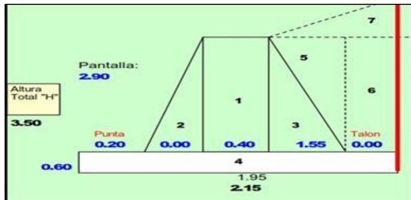
Figura N° 36: Sección A-A para M-5 Fuente: (Elaboracion propia)
