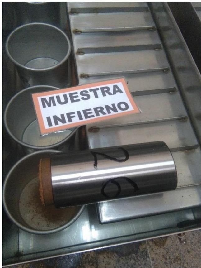
Figura 163:Primer cuerpo sumergido de la muestra Infierno.
