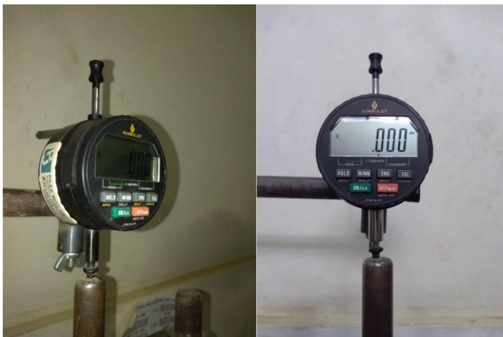
Figura 76: Posición del dial para empezar el ensayo Mini-Proctor.
