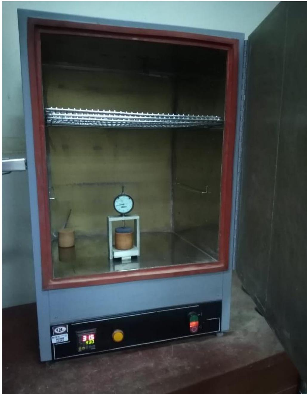
Figura 108: Ensayo de contracción en el horno.
