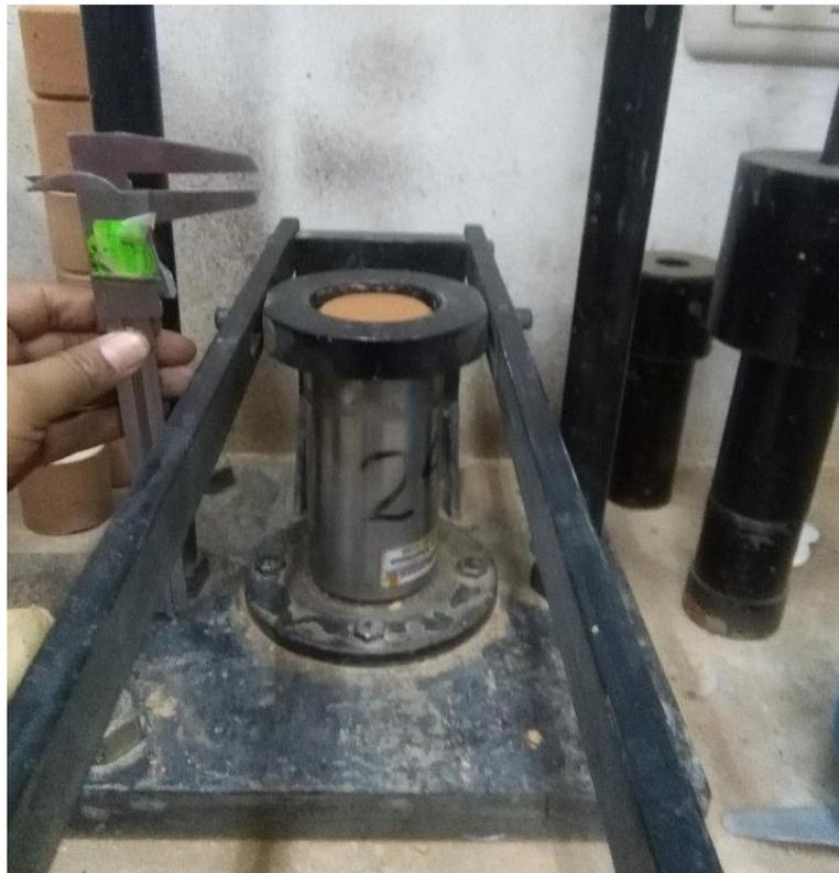
Figura 155: Procediendo a expulsar el cuerpo de prueba.
