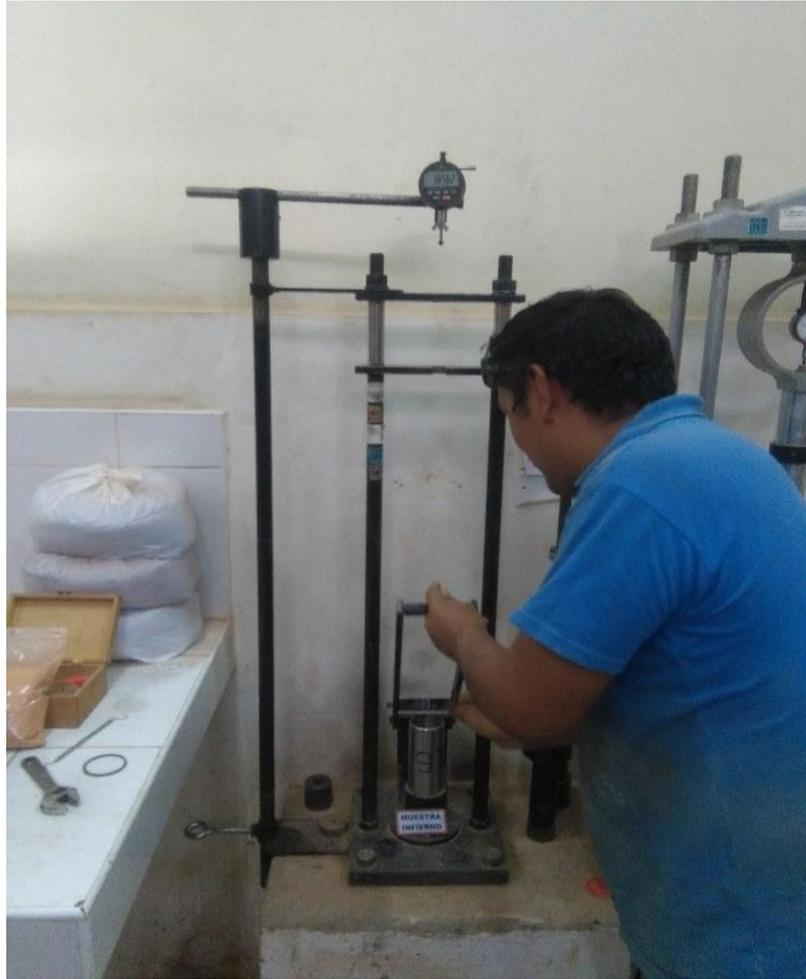
Figura 37:Empujando la muestra con la ayuda del extractor
