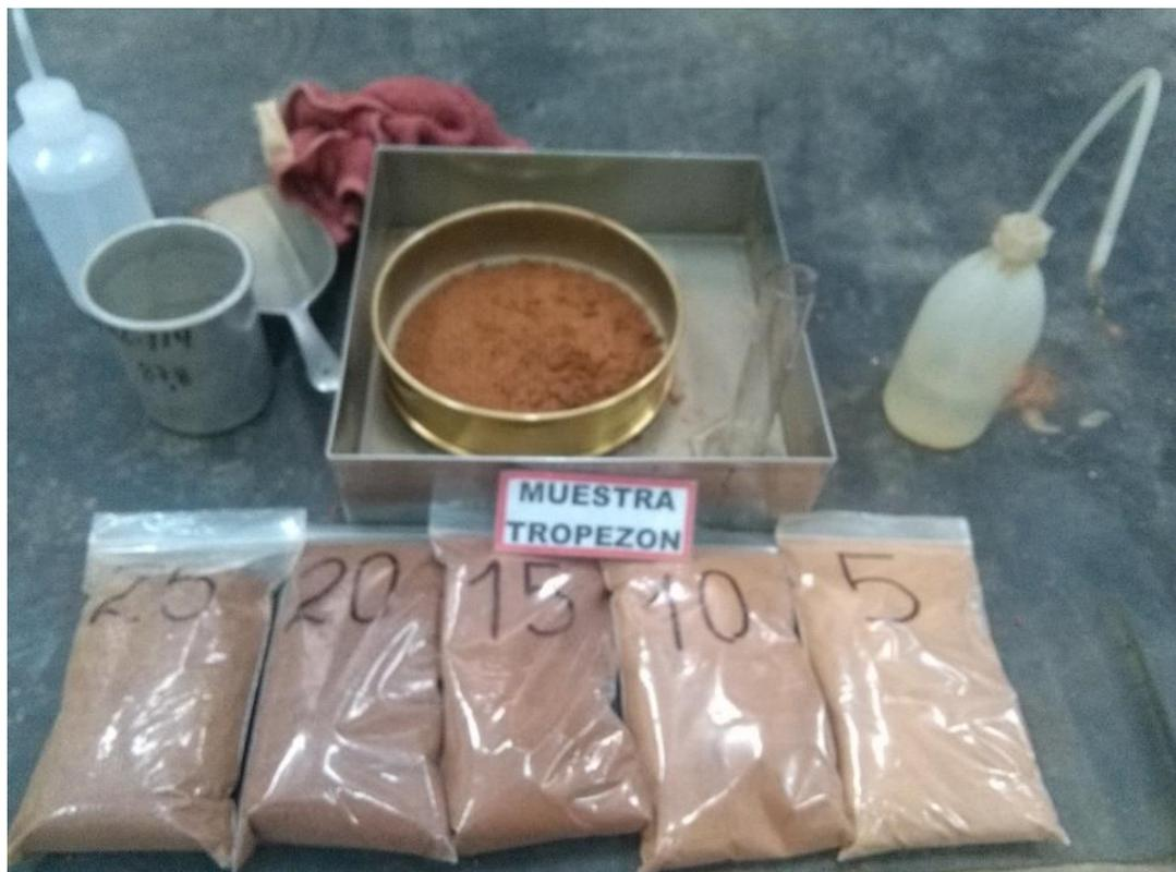
Figura 71: Muestras húmedas que tengan grumos deberán ser repasados en el tamiz.
