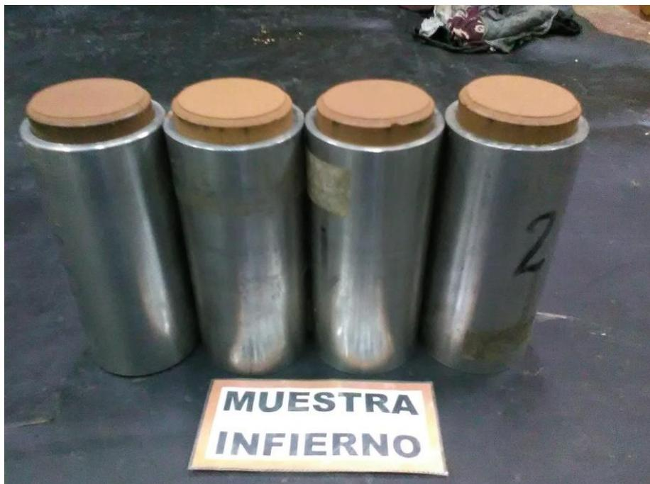
Figura 161: Cuerpos de prueba Infierno listas para sumergir.
