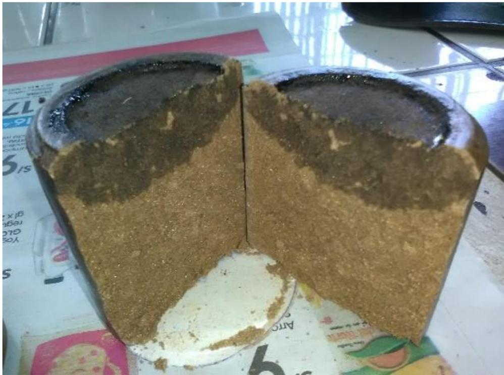
Figura 146: Penetración de la muestra de Noaya.
