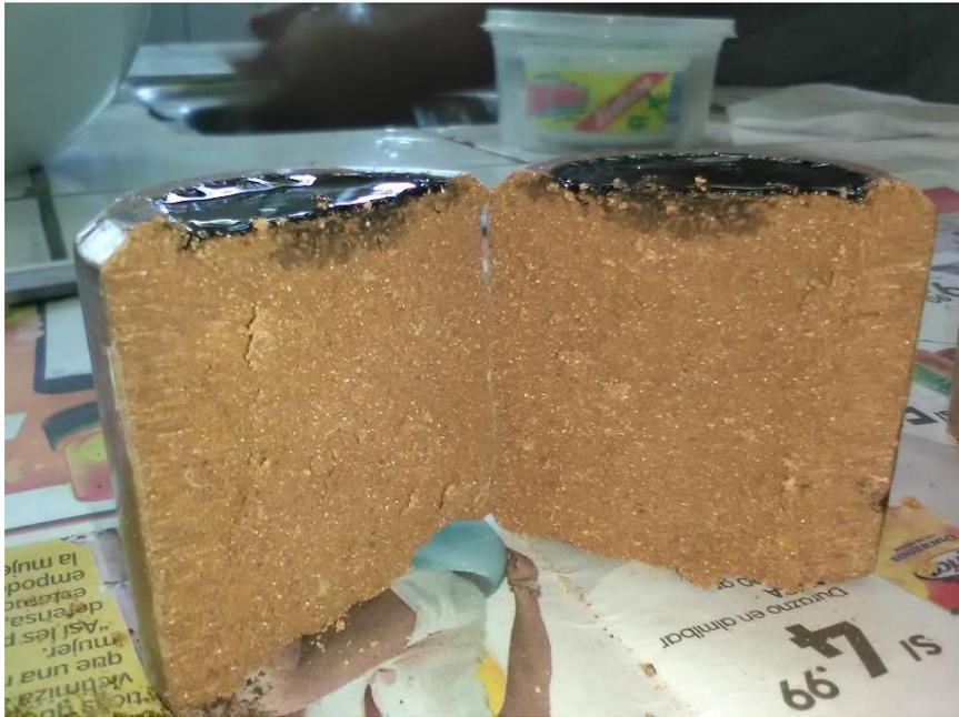
Figura 147: Medición de la penetración de la muestra de Tropezón.
