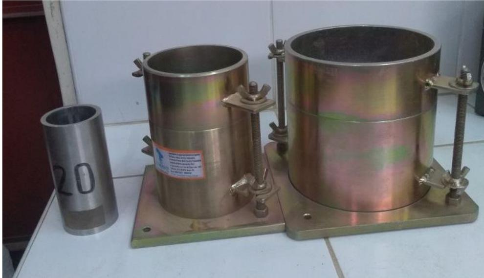
Figura 39: Moldes de Mini-Proctor, Proctor modificado de 4" y 6"
