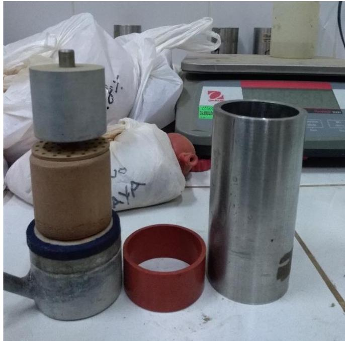
Figura 113:Equipos y materiales en el orden que se coloca antes del ensayo
