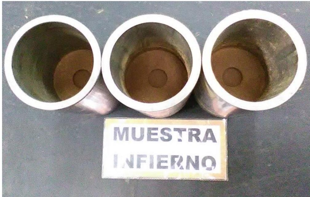
Figura 103: Cp cuerpos de prueba penetrados con el pistón de 16 mm.
