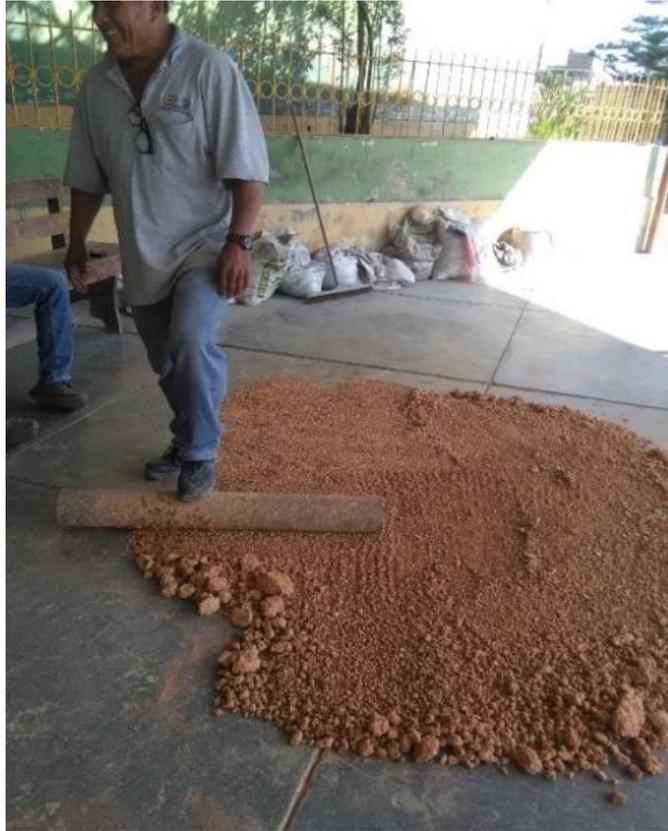
Figura 60: Degradación de los terrones de arcilla.
