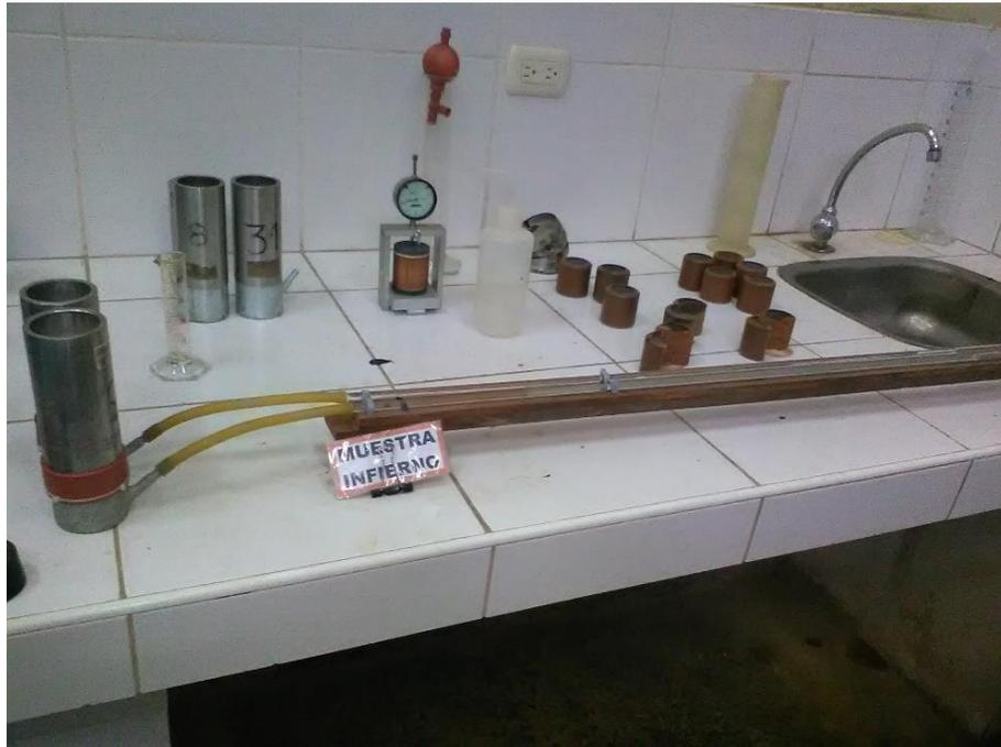
Figura 119: Ejecución de infiltrabilidad de la muestra Infierno.
