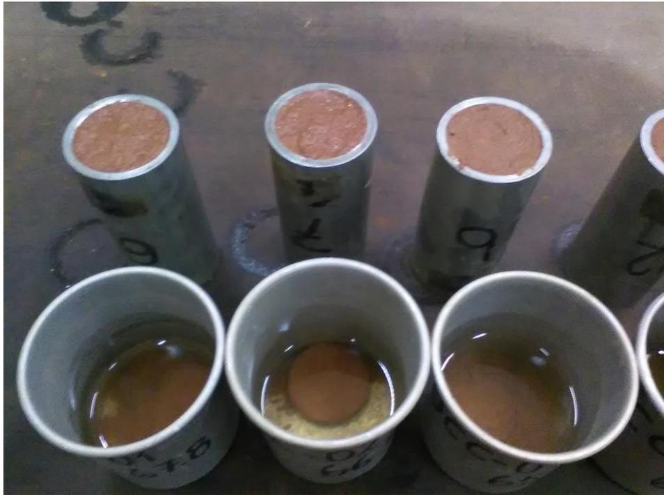
Figura 166: Muestras extraídas desprendidas después de estar sumergidas 24 horas
