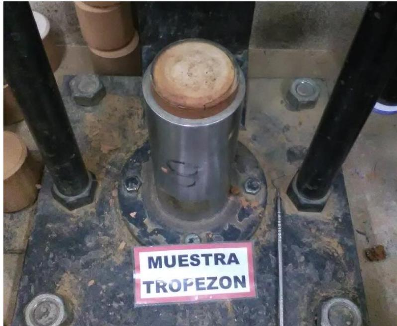
Figura 158:Expulsión de la muestra de la cantera Tropezón.
