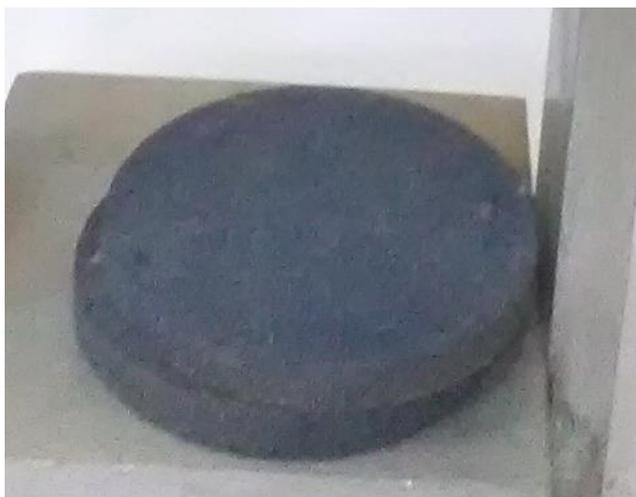
Figura 110: Piedra porosa que se coloca entre el recipiente base y el molde con el cp.
