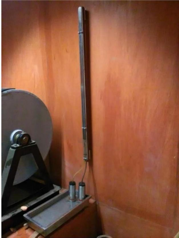
Figura 121: Ejecución del ensayo de Permeabilidad con tubos de 5 mm  $\varnothing$
