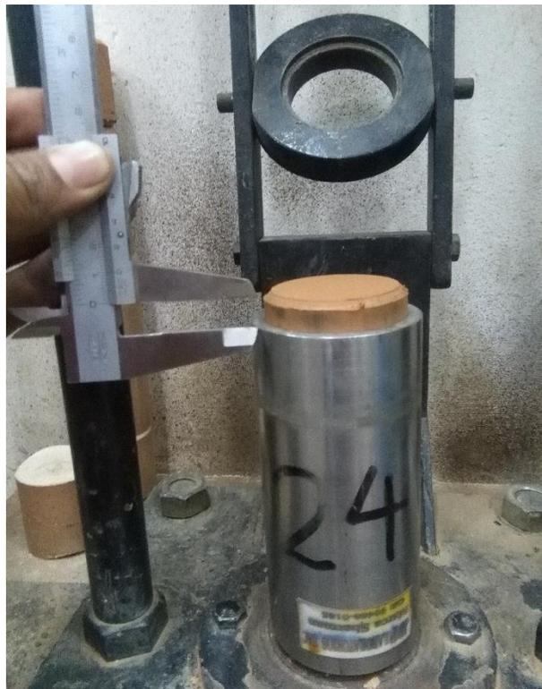
Figura 157: Medición del cuerpo parcialmente expulsado con un vernier.
