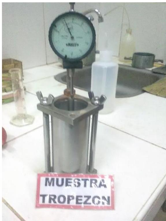
Figura 87: Armazón para determinar la expansión Conforme a la norma DER o la DNIT.
