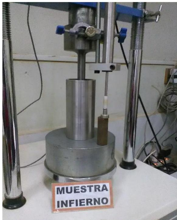
Figura 85: Instalación final del equipo con todos los sensores electrónicos penetración Mini-CBR de la muestra Infierno.
