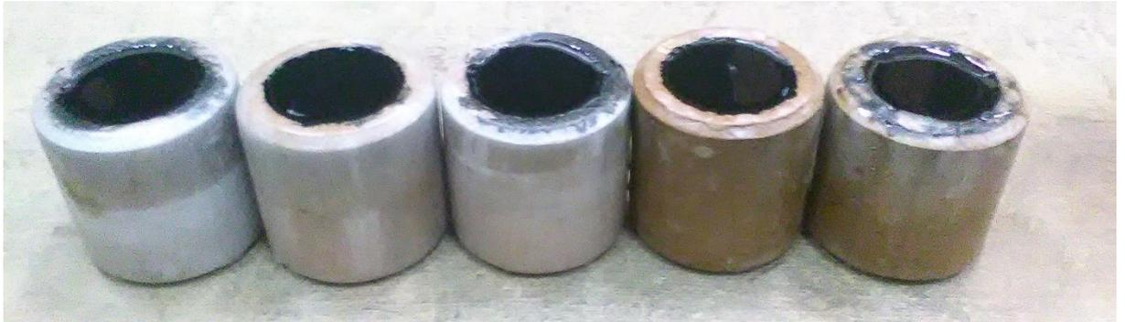
Figura 145: Preparación para la penetración con cada punto de humedad de la muestra Noaya.
