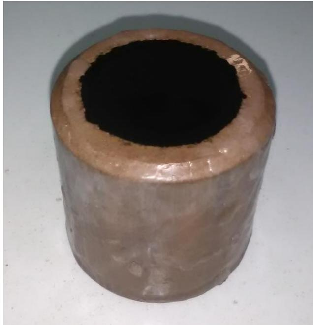
Figura 143: Muestra con imprimación bituminosa, mezcla de Infierno.
