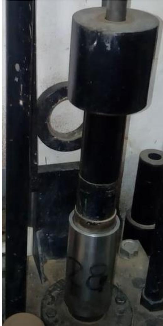
Figura 136: Compactación del Cp con el martillo intermedio.
