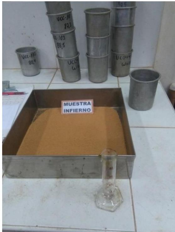
Figura 67: Muestra de 500 gr preparada para el primer punto del ensayo mini Proctor.
