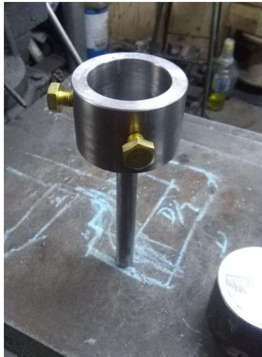
Figura 97: Acabado final del accesorio DM 5016 con tornillos de bronce para el ajuste
