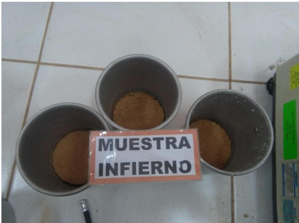
Figura 167: Una vez extraídas ponerlas en el horno hasta que seque toda el agua
