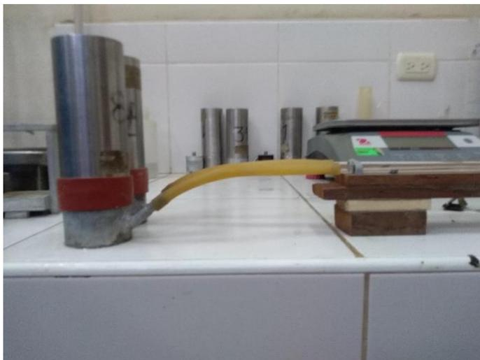
Figura 112: Soporte de madera que nivela el tubo de vidrio con el cuerpo de prueba.
