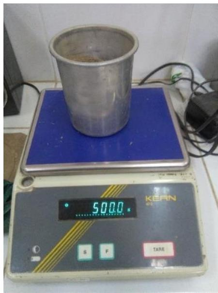
Figura 74:Pesado de una porción para determinar el contenido de humedad.
