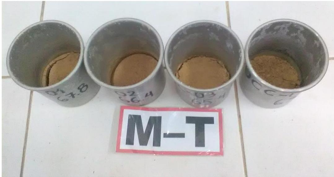
Figura 168: Muestras salidas de horno y listas para calcular la Pi.
