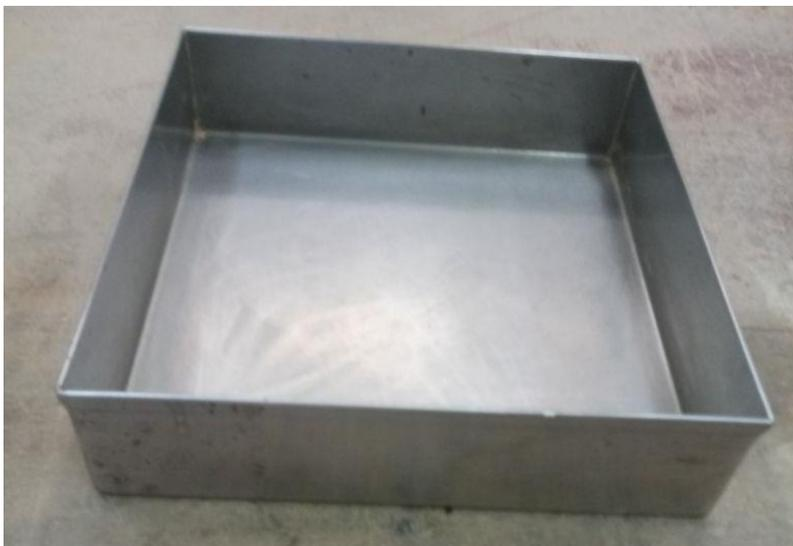
Figura 53: Bandeja de acero inoxidable para el mezclado de muestras y agua
