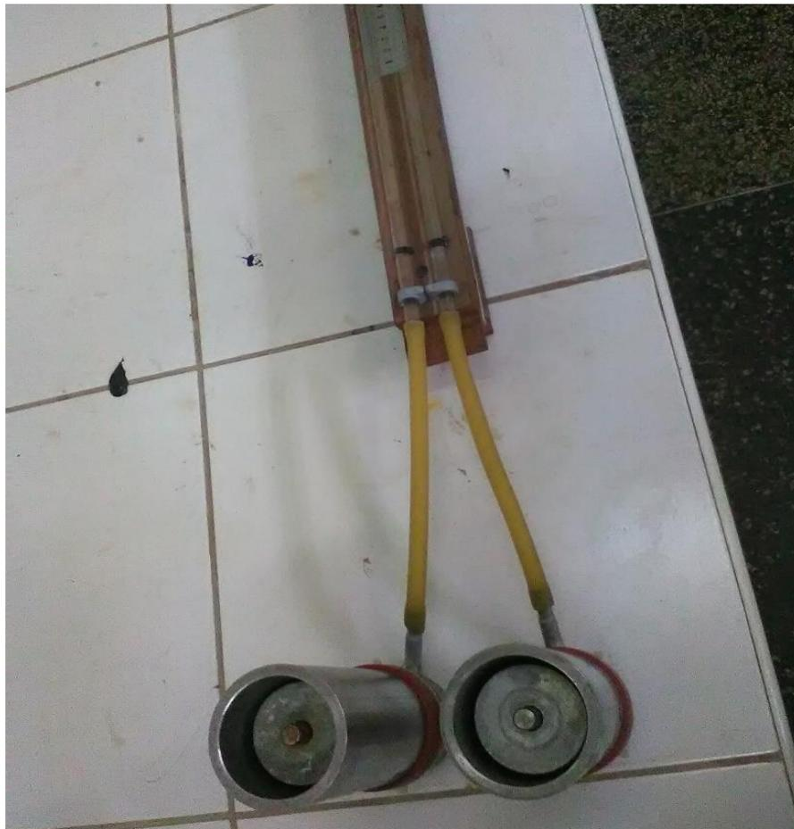
Figura 118: Colocación de las sobre cargas de 490 g encima del Cp.
