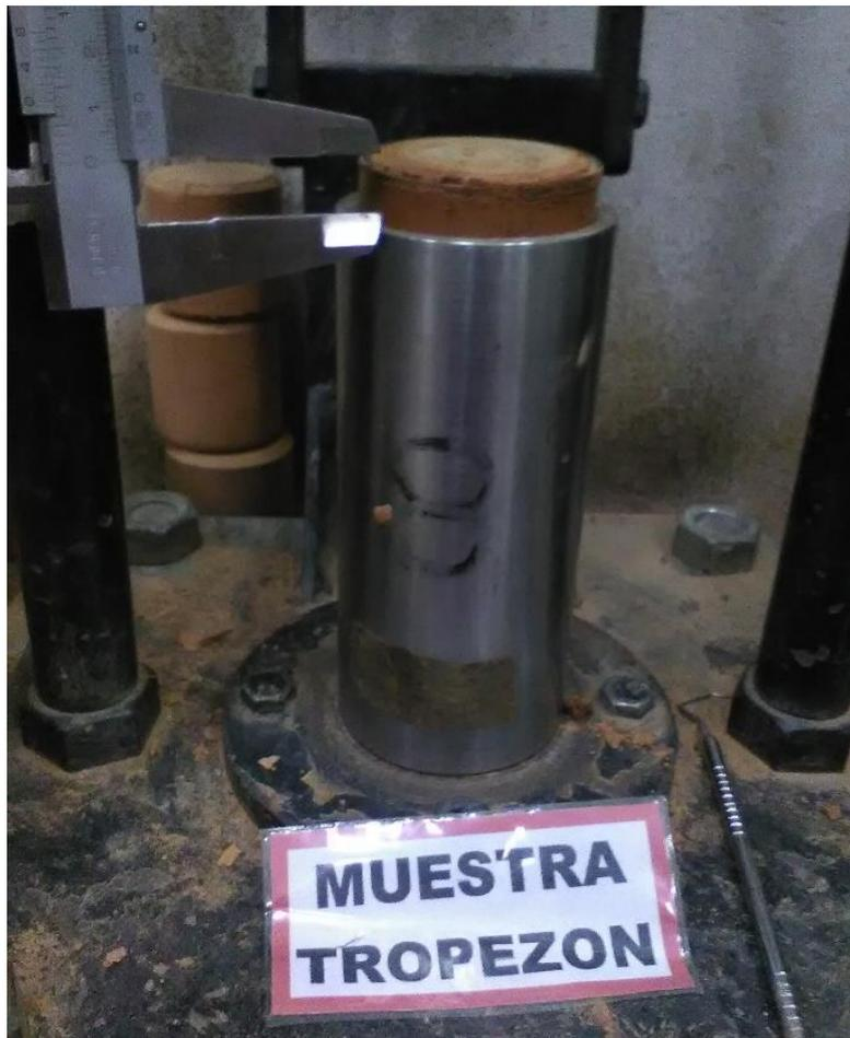
Figura 159:Medición con vernier de la muestra Tropezón.
