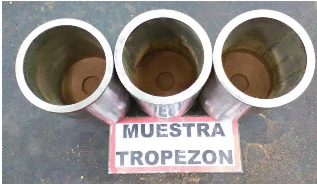
Figura 104: Penetración Mini-CBR.
