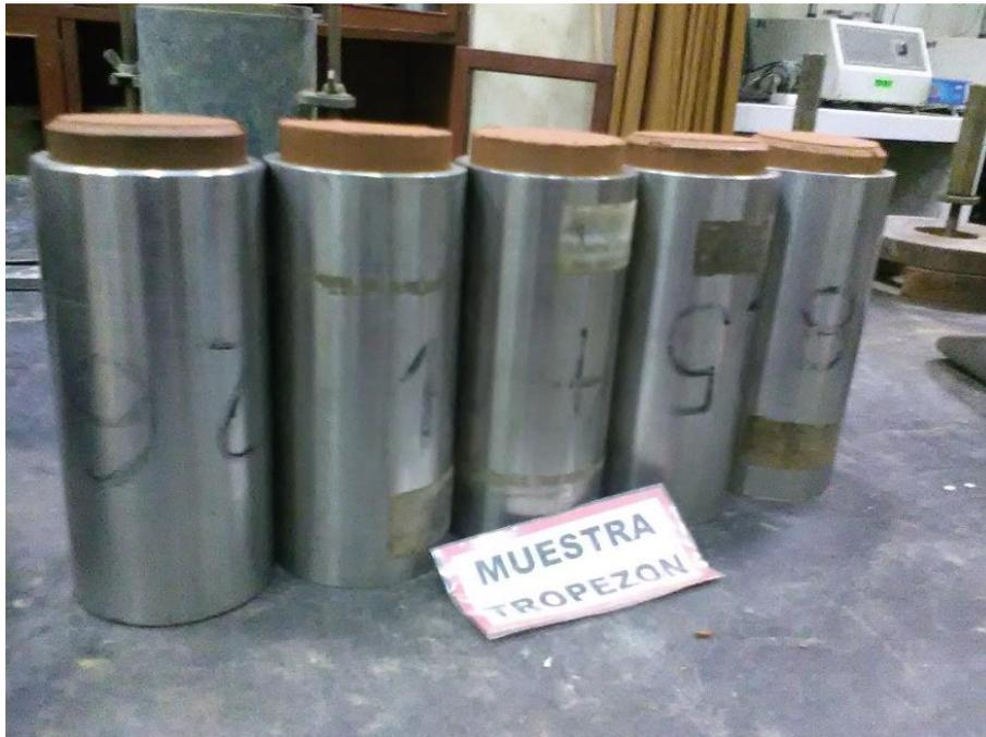
Figura 160: Los 5 cuerpos de prueba del ensayo Mini-MCV con expulsión de 1 cm cada una con distintas humedades.
