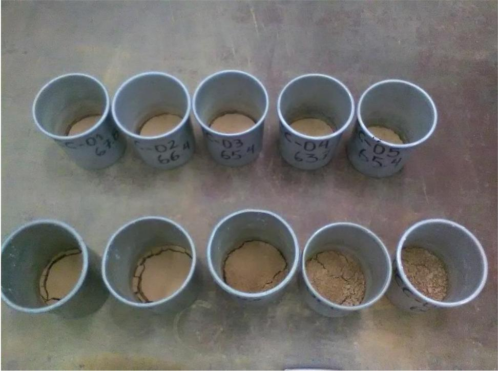
Figura 169: Muestras salidas del horno listas para el cálculo Pi.
