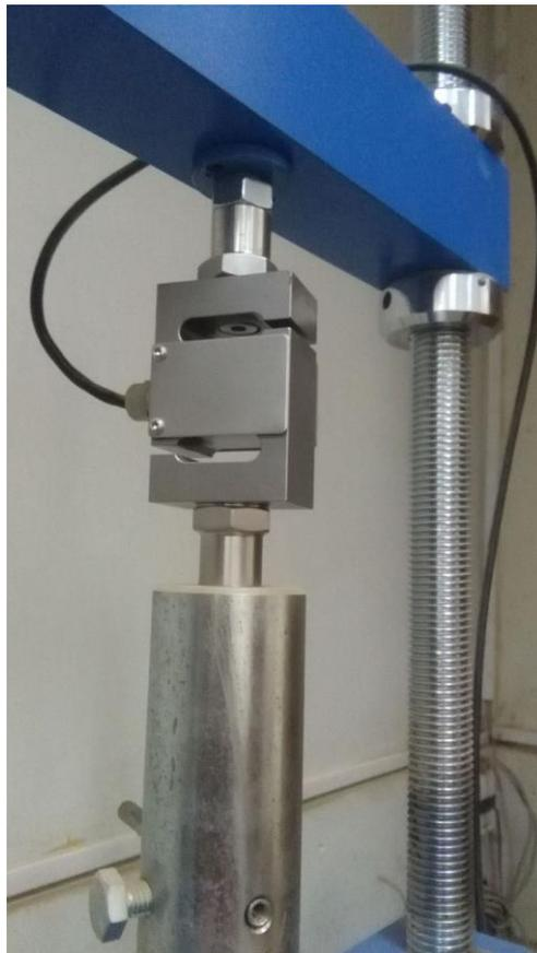
Figura 81: Al no tener anillo dinamométrico se contaba con una celda S con capacidad de carga de 500kgm.
