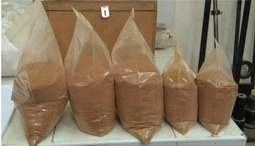
Figura 64: Porciones de 15 kg, guardadas en bolsas de polietileno.
