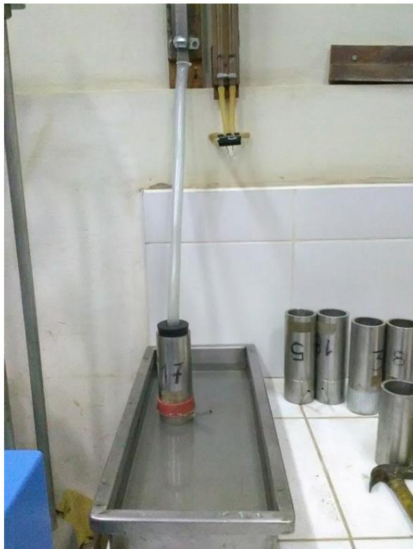
Figura 124: Instalación de la manguera de silicona de 16 mm de Ø interior.
