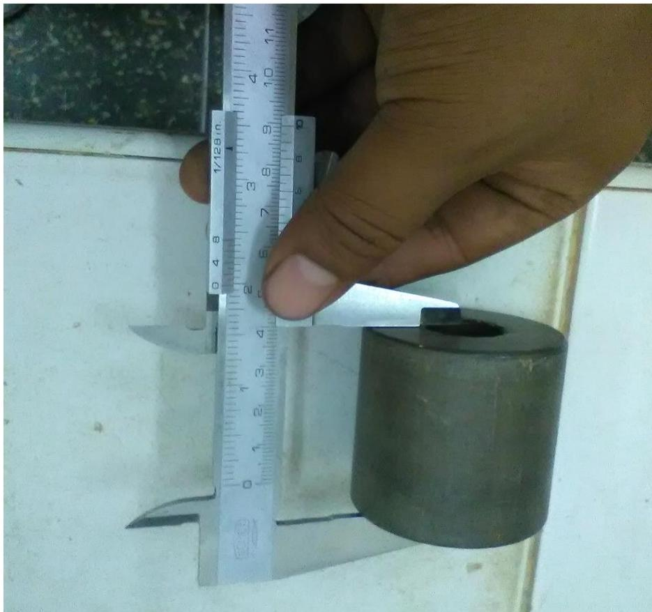
Figura 75: Medición del cilindro patrón.
