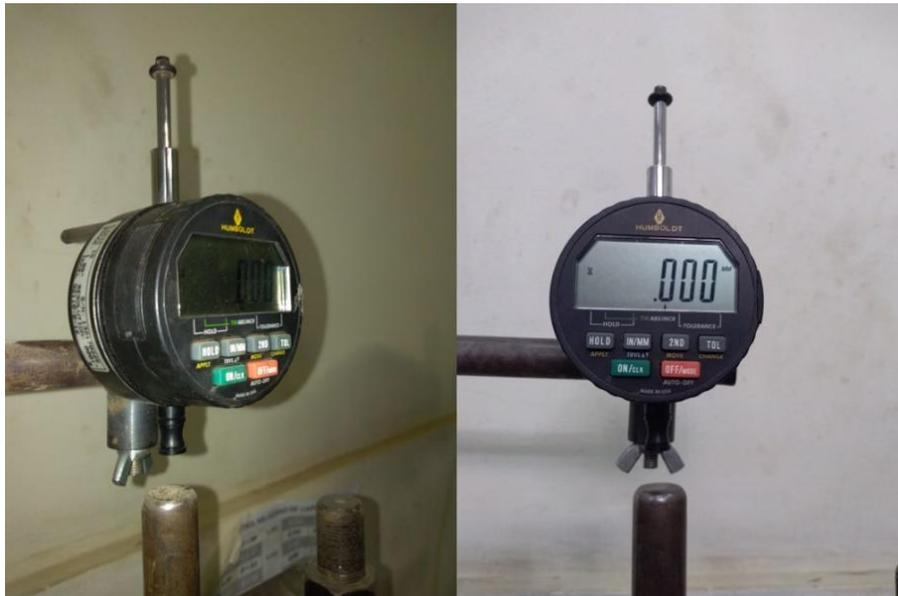
Figura 131: Posición del dial para empezar el ensayo Mini-MCV
