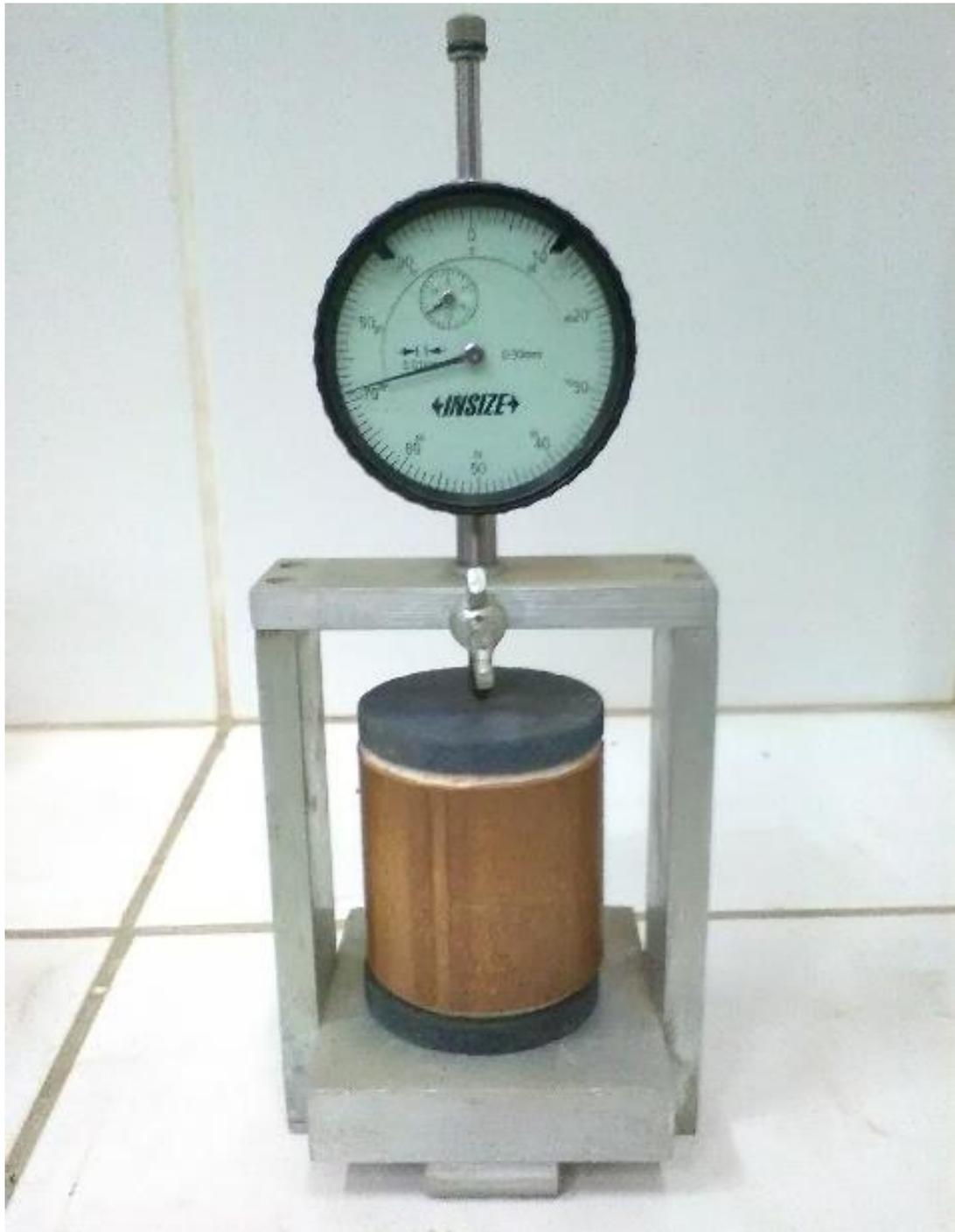
Figura 106: Contracción de la muestra Tropezón sin sobre carga.
