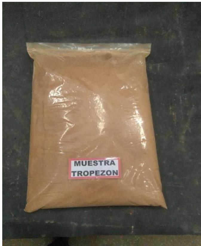
Figura 63:Pesado de una porción de 30 Kg en bolsa de polietileno para protegerlo de la humedad.
