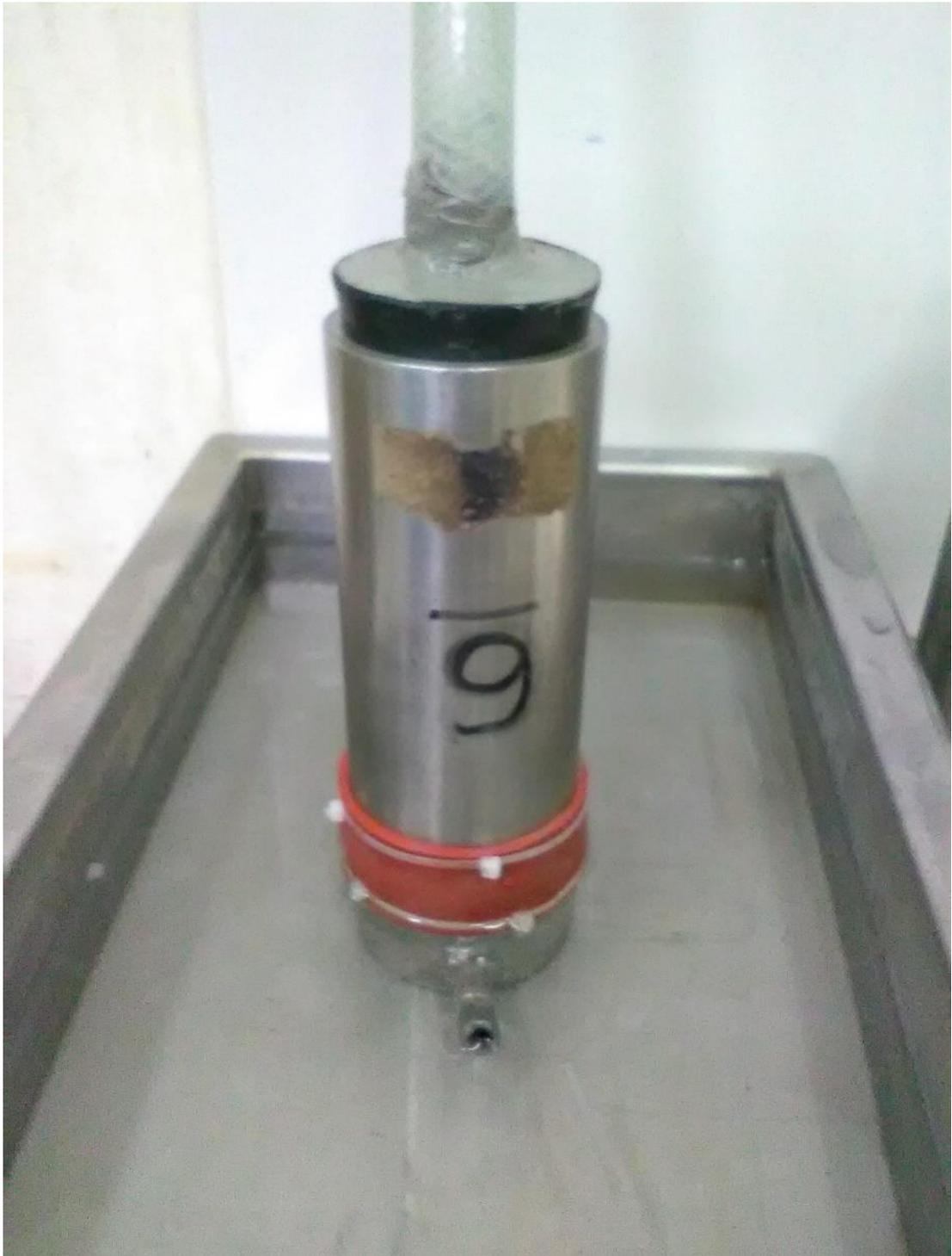
Figura 127: Sellado de la manguera y el tapón de jebe con silicona gris.
