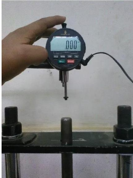
Figura 47: Dial electrónico, posición para medición de cp mini Proctor.
