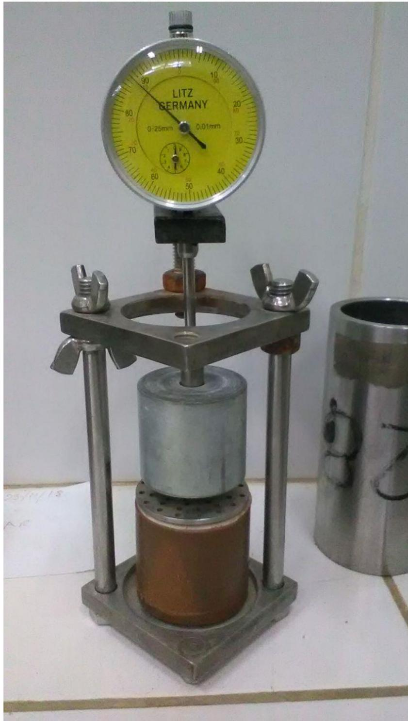
Figura 107: Contracción de la muestra tropezón con sobrecarga con una pesa de 420 g.
