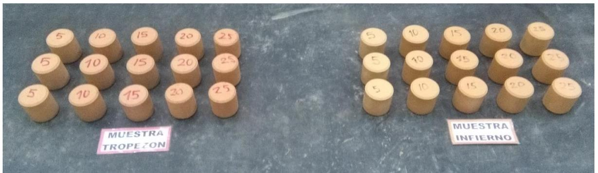
Figura 77: Expulsión del cuerpo compactado (CP) con cada porcentaje en forme ascendente en 5%.
