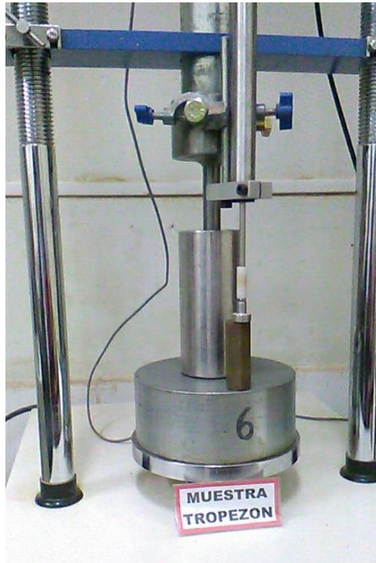
Figura 84: Instalación final del equipo con todos los sensores electrónicos penetración Mini-CBR de la muestra Tropezón.
