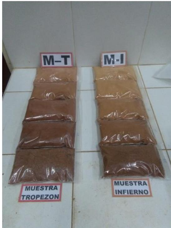
Figura 72: Muestras con diferentes cantidades de humedad de la muestra Tropezón y de Infierno, para su saturación se recomienda 12 horas con 500 g c/u.
