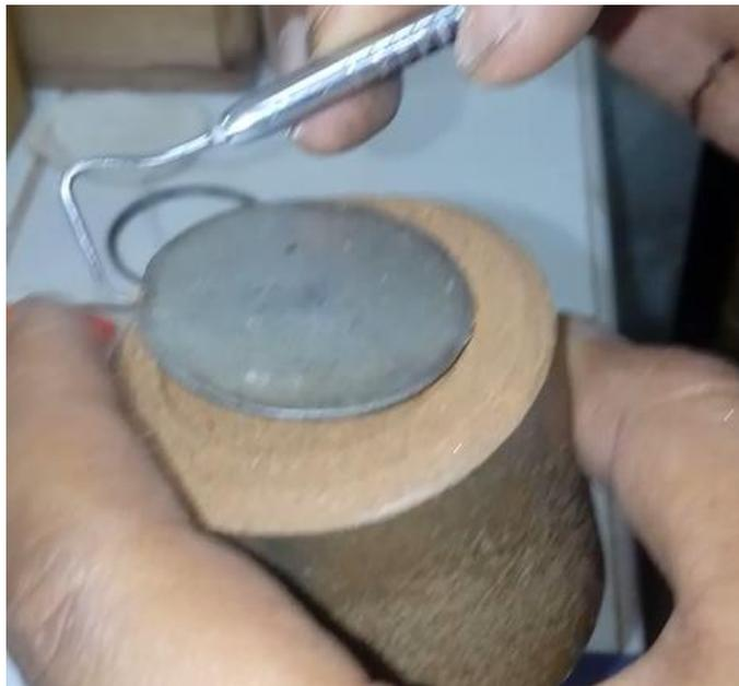
Figura 137: Expulsión del disco espaciador.
