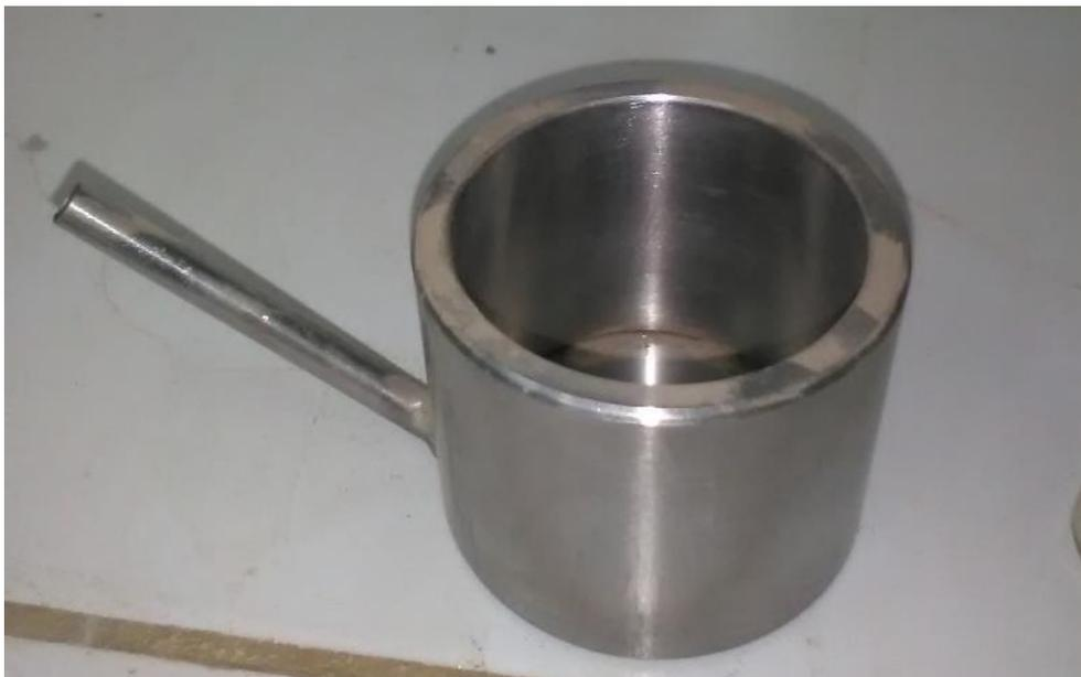
Figura 109: Recipiente base de 50.0 mm de diámetro interior.
