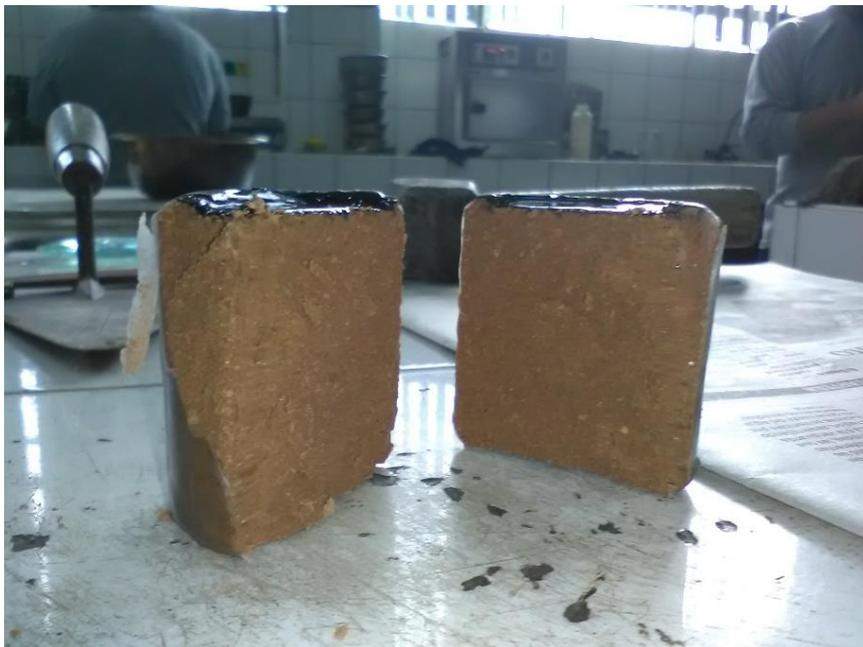
Figura 148: Penetración de la muestra infierno.
