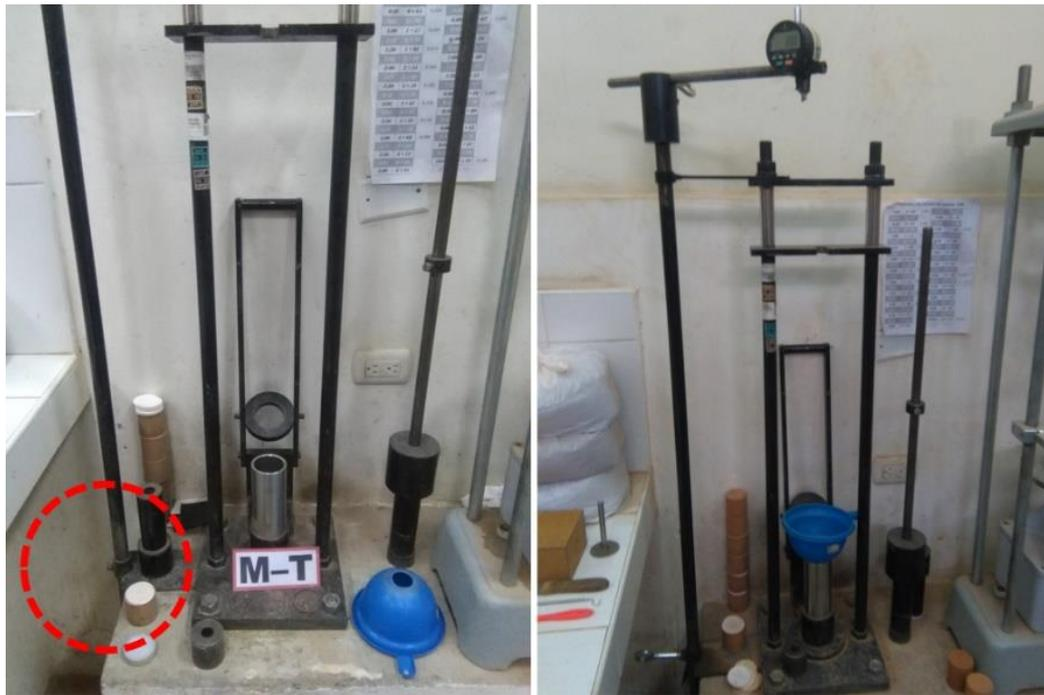
Figura 57: Colocación del sujetador de la barra vertical.
