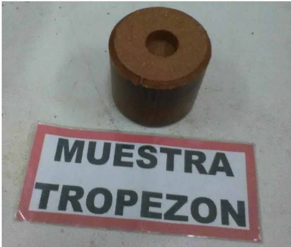
Figura 105: Cuerpo de prueba ya penetrado por el ensayo Mini-CBR.
