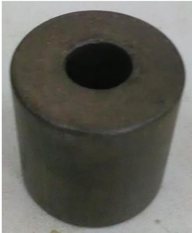
Figura 89: Sobrecarga perforada patrón de 50 mm de  $\varnothing$  la perforación es de diámetro es de 17 mm.
