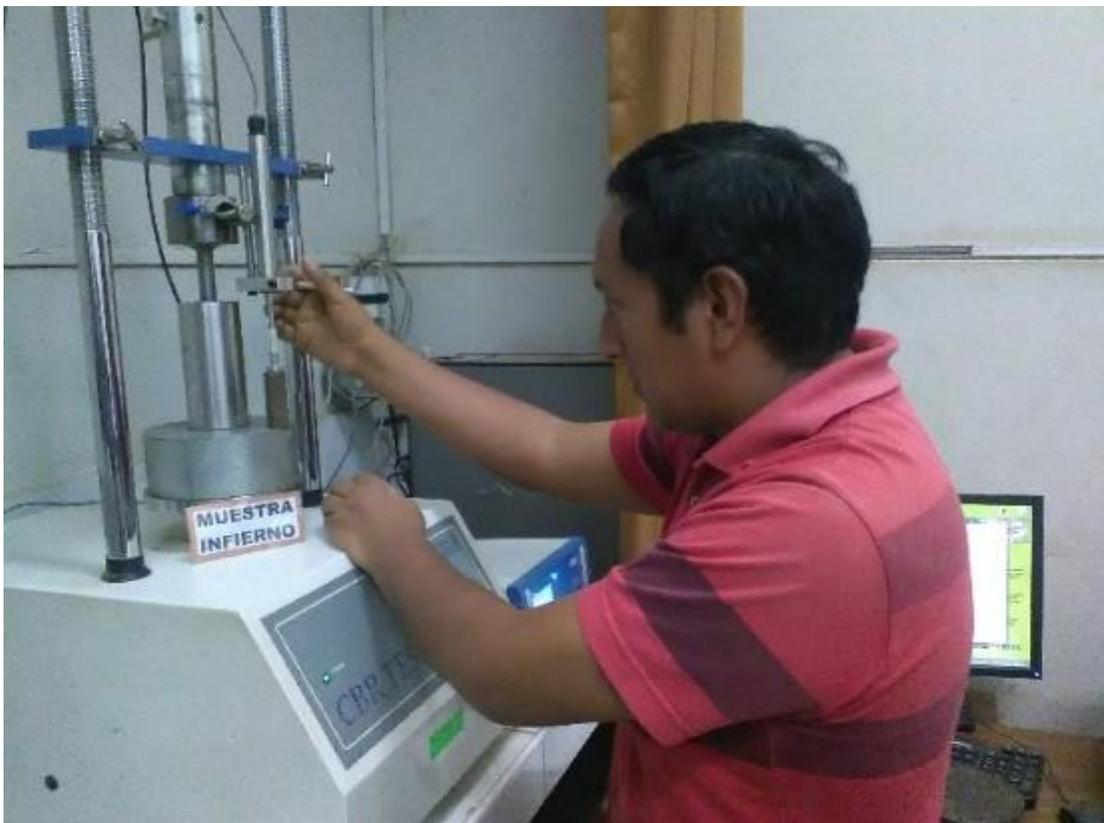
Figura 102:Instalación y habilitación para la penetración del Mini-CBR.
