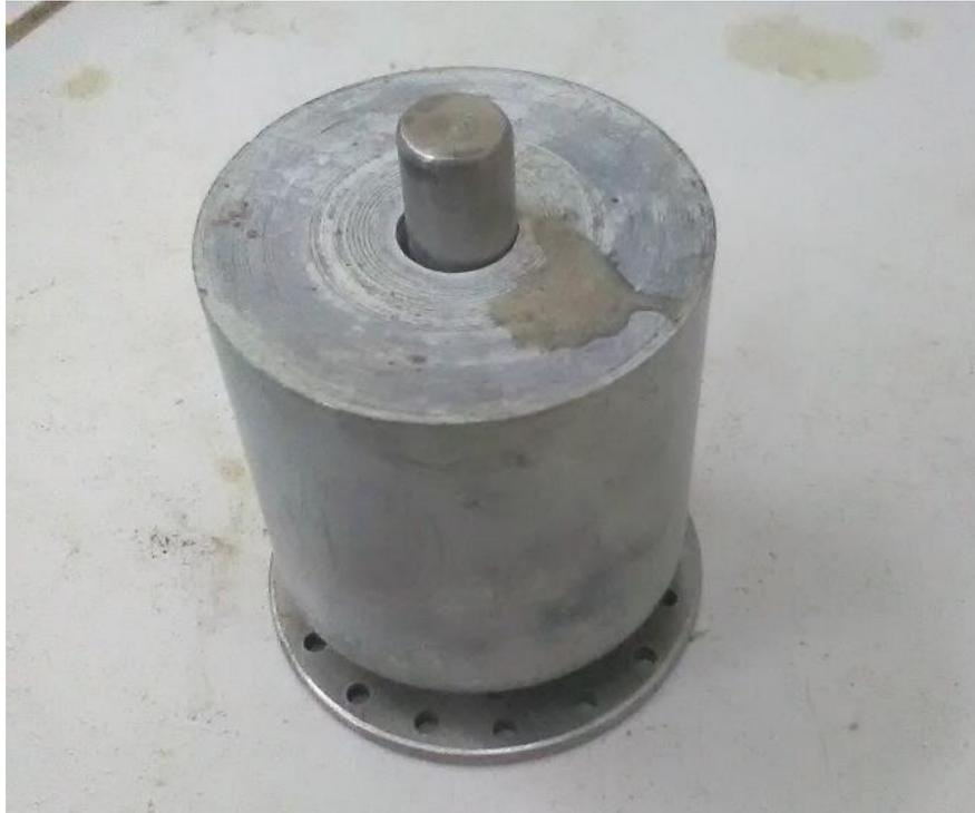
Figura 88: Sobre carga para el ensayo de expansión con carga
