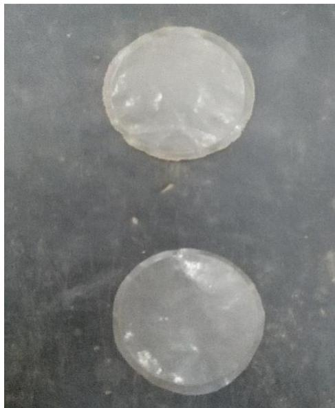
Figura 56:Discos de polietileno para uso en Mini Proctor y ensayos de mini MCV.
