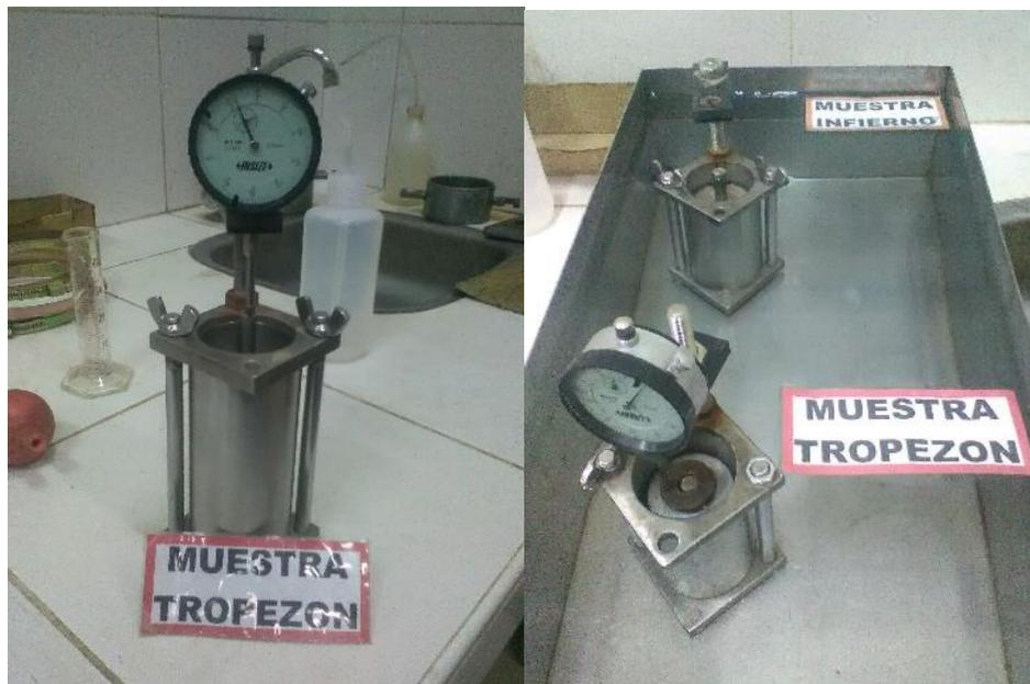
Figura 99: Expiación sumergida con carga de 490 gramos para penetración en Mini-CBR.
