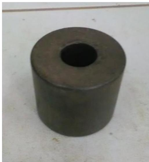
Figura 48: Cilindro perforado para uso de calibración y guía de penetración Mini-CBR.
