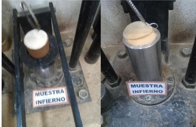
Figura 78:Expulsión del cuerpo prueba (Cp) con la palanca de extracción y retirada del anillo y el disco de polietileno.
