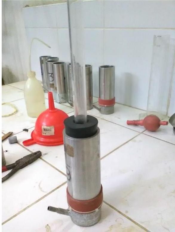
Figura 123: Preparación de un nuevo equipo de permeabilidad con tubo de 16 mm Ø
