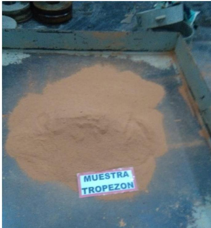
Figura 62:Disgregado al aire libre de la muestra Tropezón.
