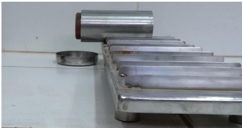
Figura 151: Soporte que mantiene los molde en posición horizontal.
