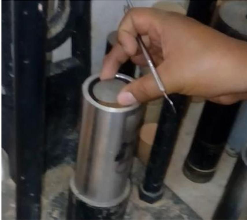
Figura 134: Colocación del disco espaciador de 35 mm de  $\varnothing$  y 1.5 mm de espesor.
