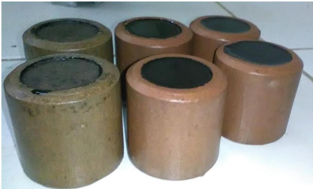
Figura 144: Muestra con imprimación bituminosa a la izquierda Noaya a medio Tropezón y a la derecha Infierno.
