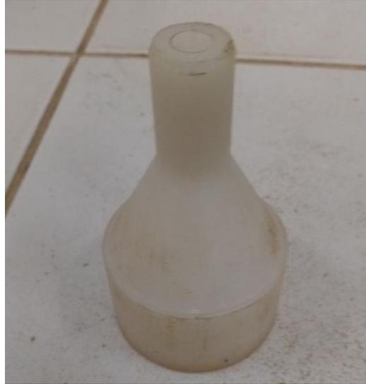
Figura 55:Asentador para las muestras de suelo y asentador de los discos de los ensayos bituminosos.
