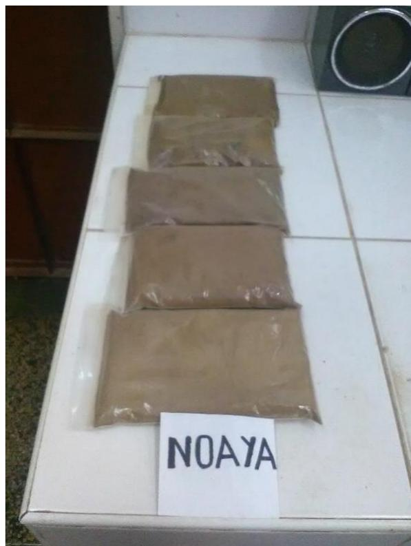
Figura 73: Muestras con diferentes cantidades de humedad siendo esta muestra arenosa con limo con 500 g c/u.
