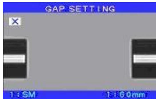
Presionando el botón de empalme, estando la empalmadora ajustada en automático, la misma procederá a alinear en los ejes x e y, y a acercar las puntas a la distancia adecuada.
