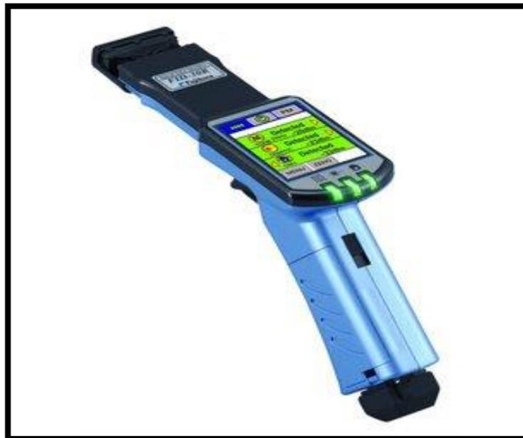
Gráfico 50. Medidor de señal de fibra óptica.
