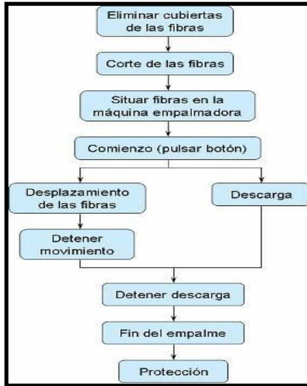
**Gráfico 37.** Procedimiento de empalme de fibras por fusión.
