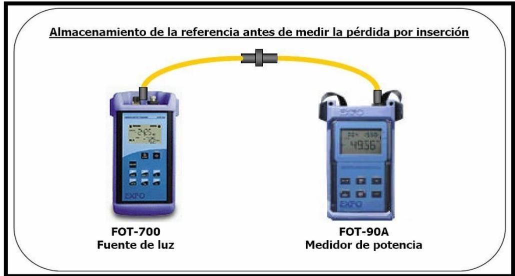
**Gráfico 43.** Medición de la atenuación producida por conectores.
