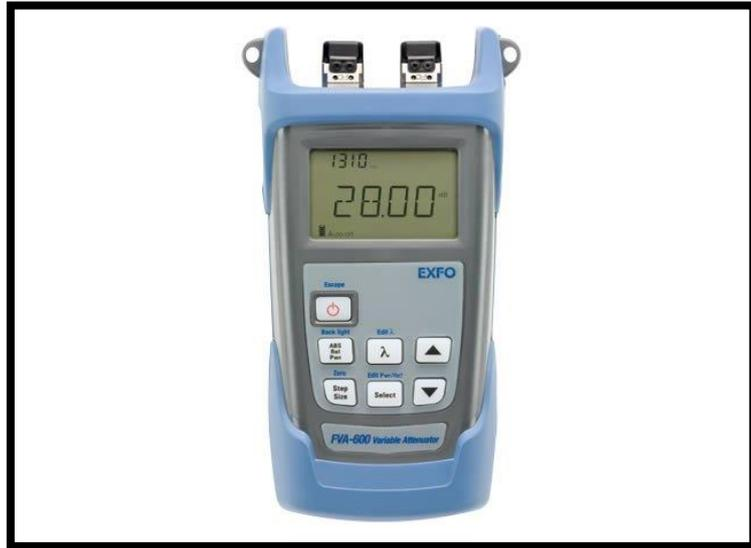
Gráfico 47. Atenuador de señal de fibra óptica.
