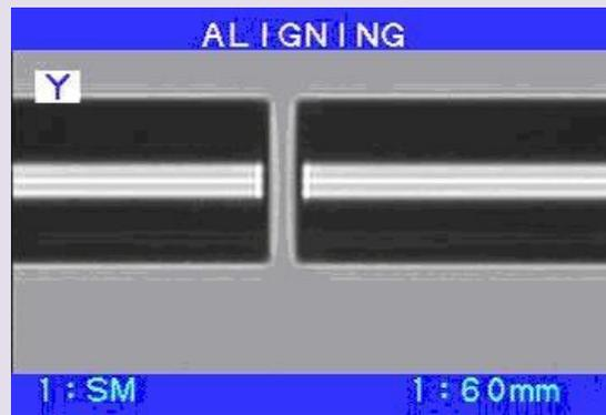
Una vez cumplido esto, a través de un arco eléctrico dado entre dos electrodos, aplicará una corriente de prefusión durante el tiempo de prefusión, y luego una corriente de fusión durante el tiempo de fusión.
