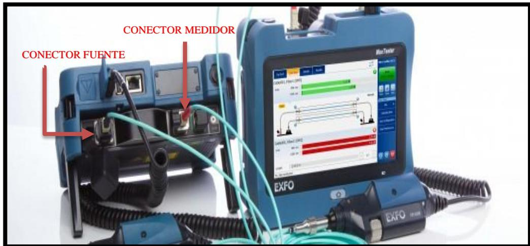
**Gráfico 44.** Medidor con ambos módulos (emisor y receptor) .
