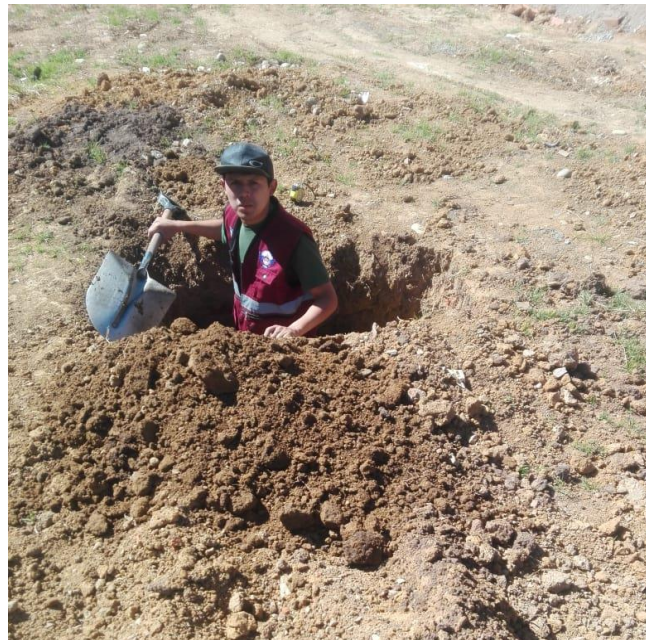
Figura 2. Realización de la calicata
