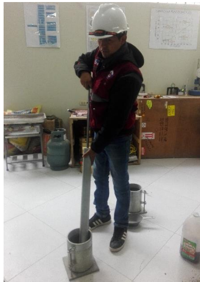
Figura 13. Compactación del suelo
