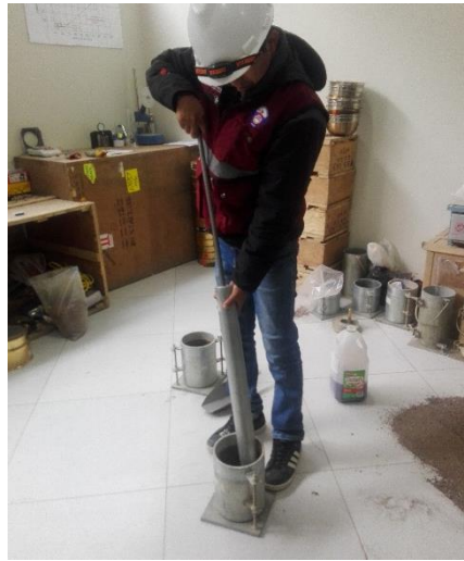
Figura 14. Realización de la compactación - Ensayo CBR
