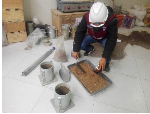
Figura 12. Colocación del suelo en el molde
