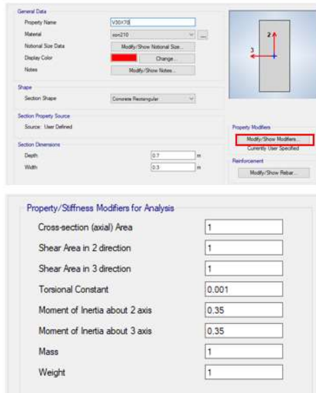
Figura 28. Definición de sección de vigas (secciones agrietadas)
