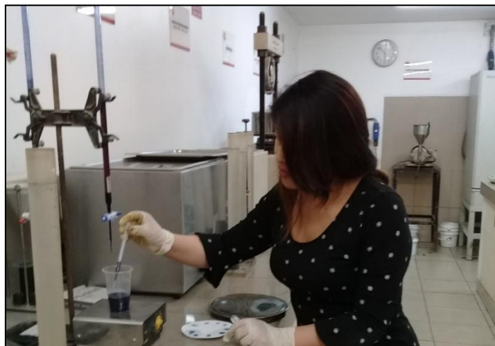
Fotografía 8: Ensayo de Azul de Metileno
