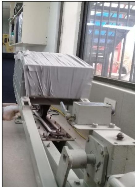
Fotografía 29: Acción de la rueda cargada durante 100 ciclos
