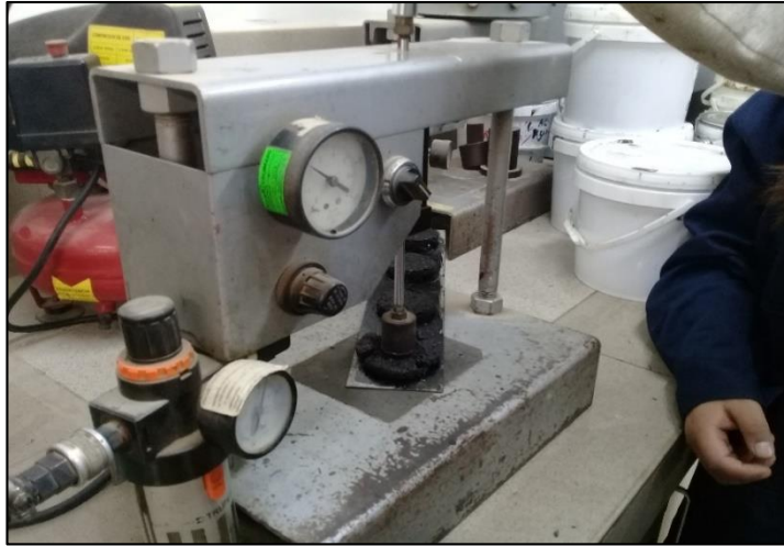
Fotografía 33: Aplicación de torque con una presión de 200 kPa
