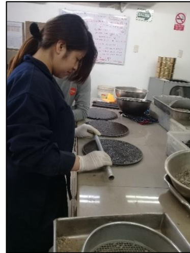
Fotografía 16: Enrasado de la mezcla
