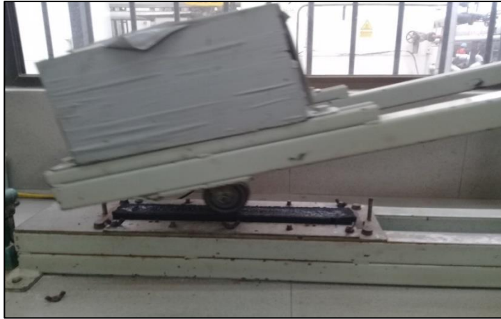
Fotografía 24: Acción de la rueda cargada durante 1000 ciclos
