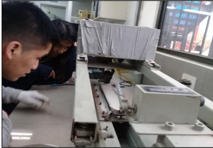
Fotografía 28: Colocación de la arena Ottawa sobre la muestra
