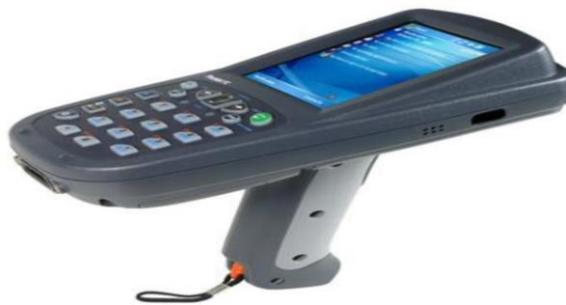
Figura 2. Terminal inalámbrico para capturar datos por el código de barras.
