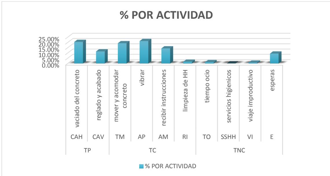
Figura 60: % Por Actividad (concreto en vigas y losa aligerada)
