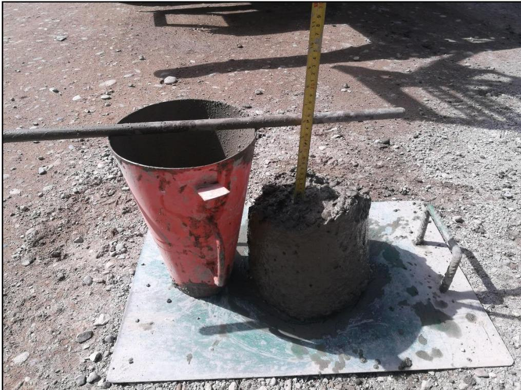
FOTO N°24: PRUEBA DE SLUMP CONCRETO DE LOSA ALIGERADA.
