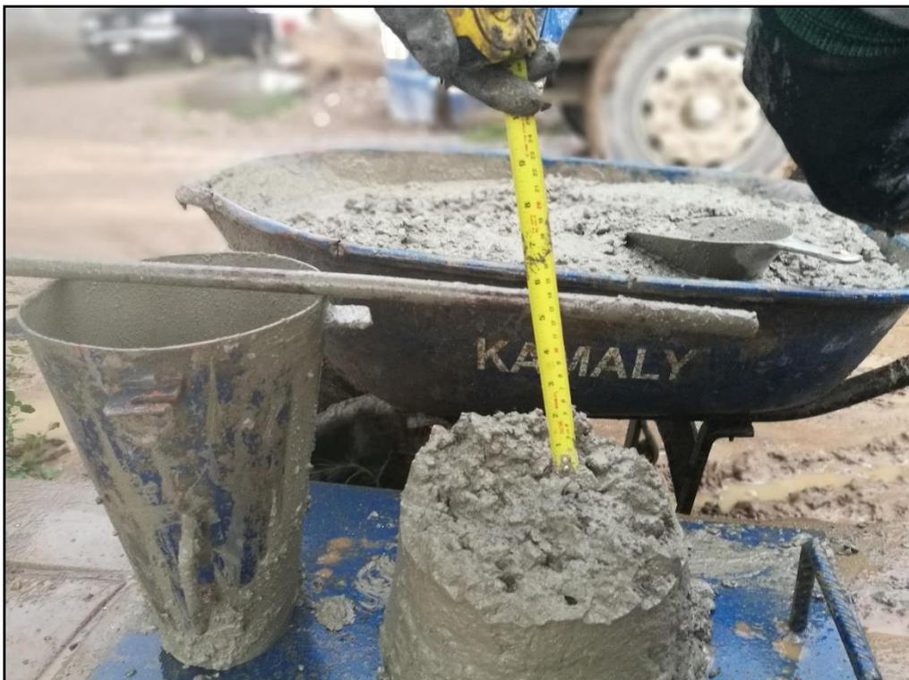
FOTO N°11: ENSAYO DE SLUMP DE MODULO 01 Y 02 VACIADO DE ZAPATAS CONCRETO PREMEZCLADO FC=210KG/CM2.
