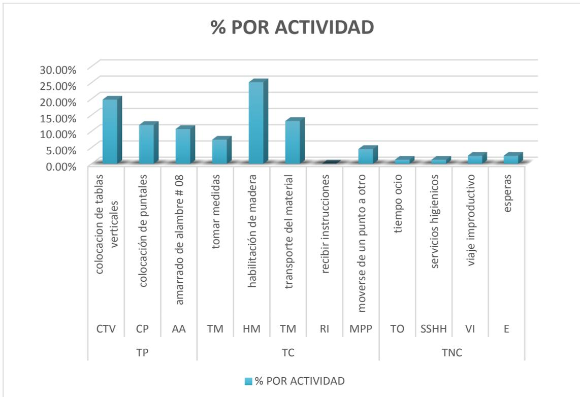
Figura 54: % Por Actividad (Encofrado de Columnas)
