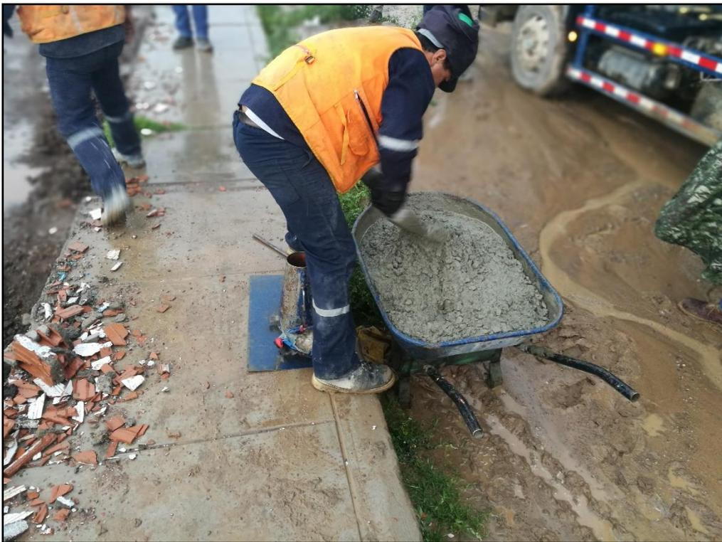
FOTO N°10: ENSAYO DE SLUMP DE MODULO 01 Y 02 VACIADO DE ZAPATAS CONCRETO PREMEZCLADO FC=210KG/CM2.
