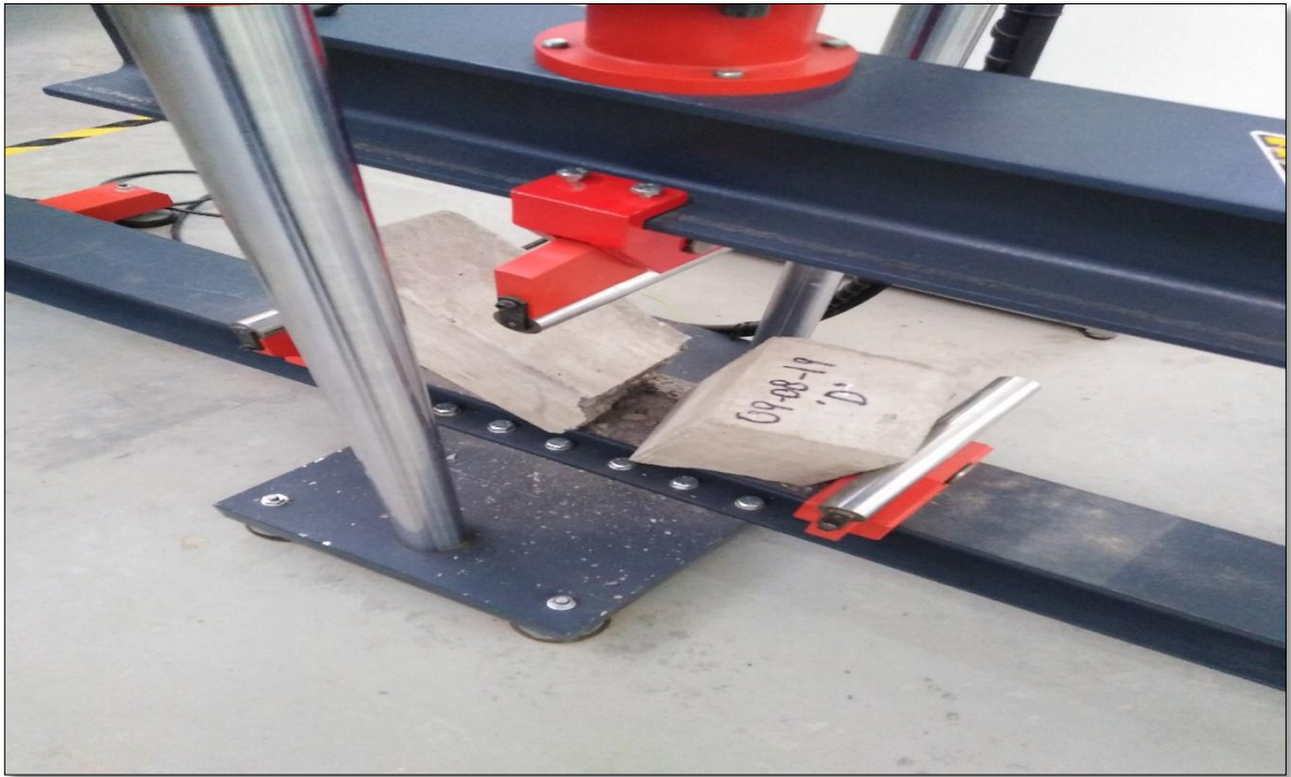
Fotografía 35. Se observa la prensa del ensayo a flexión posterior a la rotura de la viga D, elaborado el 9 de agosto del presente, teniendo como material predominante al hormigón.
