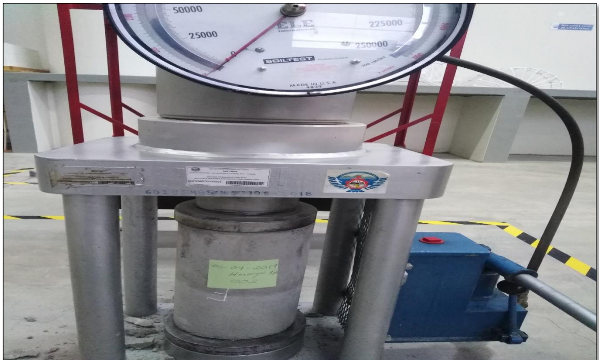
Fotografía 33. Se visualiza la prensa manual para el ensayo de compresión de las probetas, en esta prensa se ensayaron las muestras de 6" x 12".
