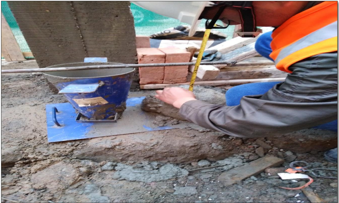
Fotografía 5. Se puede ver la medición del Slump, para este procedimiento es necesario invertir el cono de Abrams y tomar como línea horizontal a la barrilla lisa.
