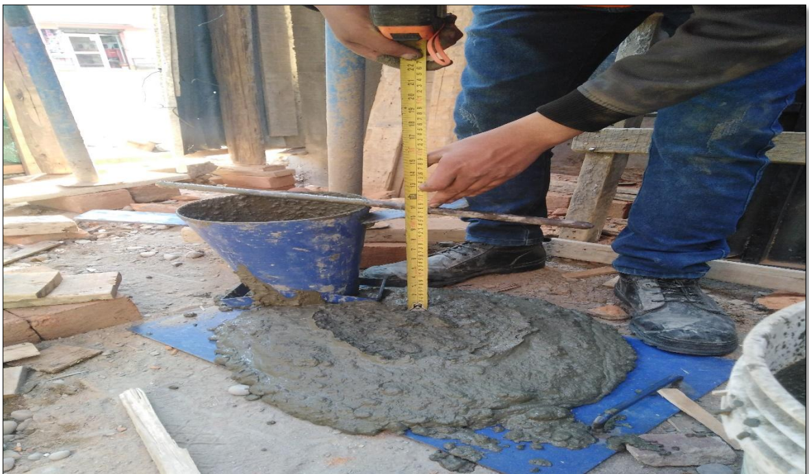
Fotografía 20. Se puede observar la medición del Slump con la de un flexómetro, esta medida es recomendable obtenerla en pulgadas.
