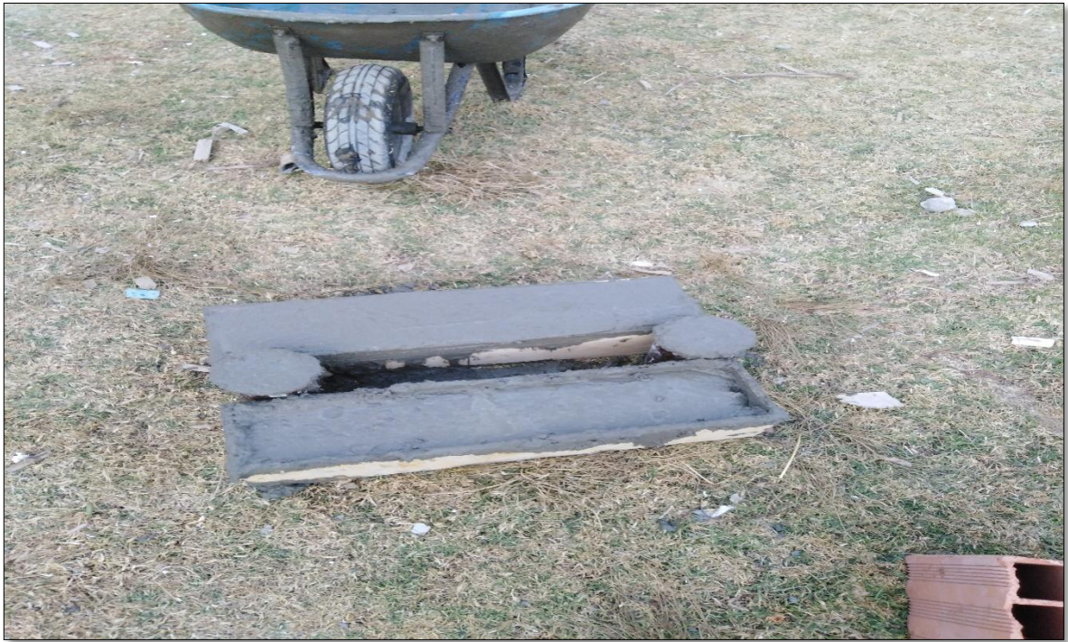
Fotografía 11. Se puede ver las muestras de concreto para vigas y testigos cilíndricos, en este caso se utilizó las probetas de 4" x 8".
