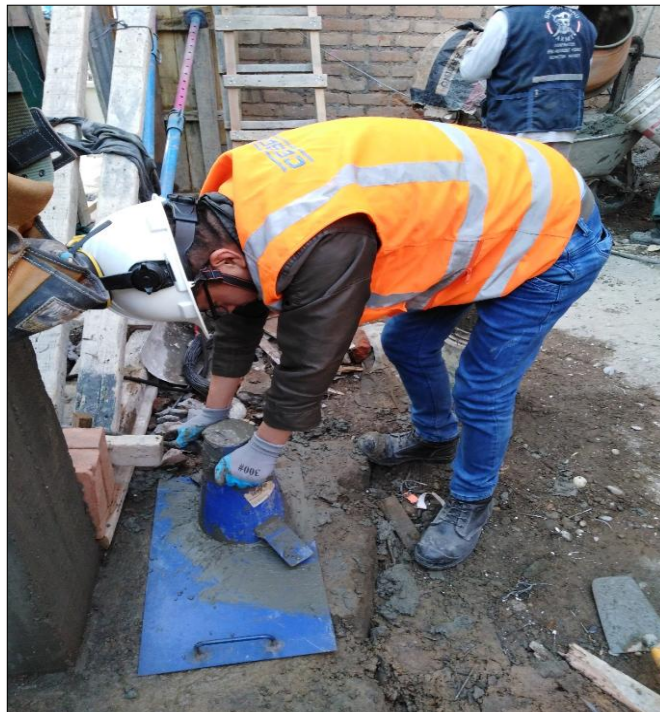
Fotografía 3. Se visualiza el procedimiento para el ensayo de asentamiento (Slump), para esto se necesitó una cantidad de concreto extraído de la colocación del concreto.
