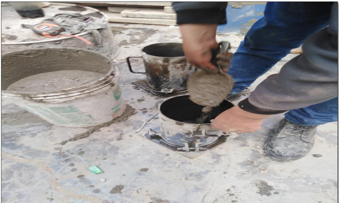
Fotografía 28. Observamos el llenado del concreto en las probetas de 6" x 12" para realizar el ensayo de esfuerzo a compresión, se procedió a ensayar 2 probetas para obtener un promedio de las resistencias finales.
