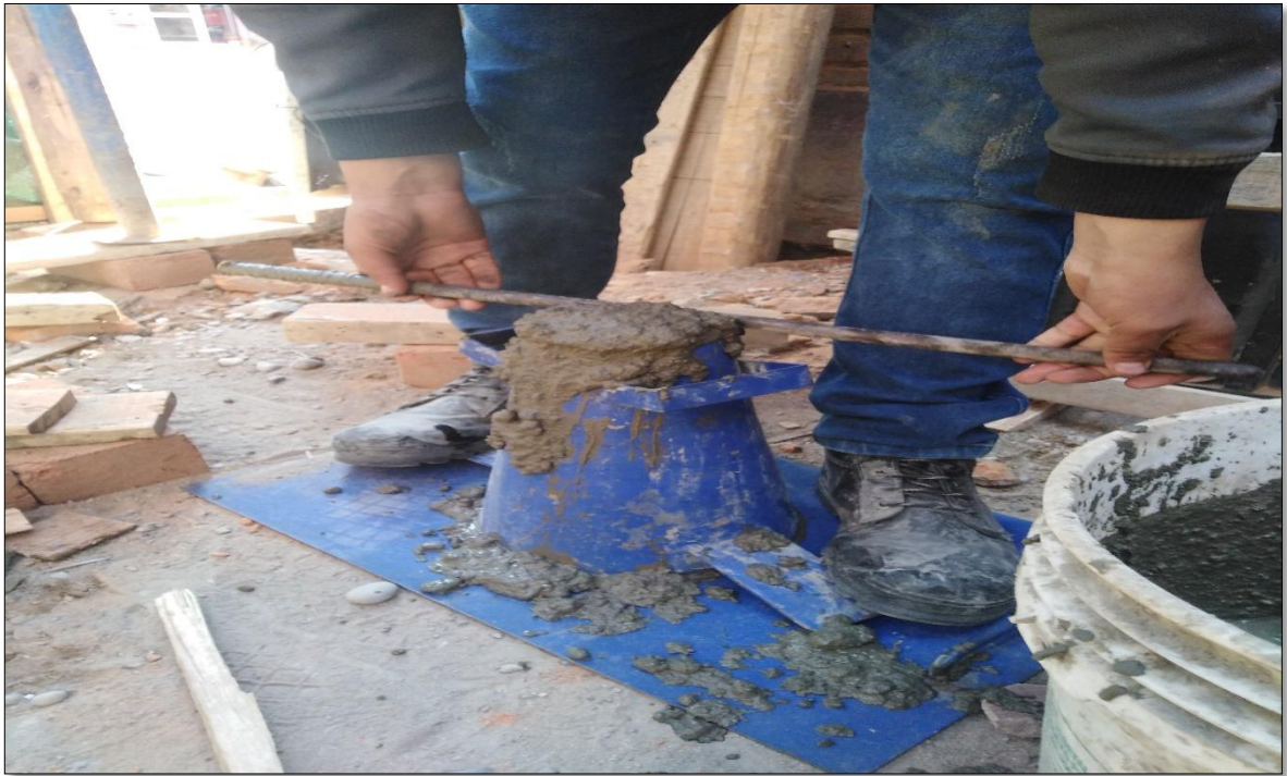
Fotografía 19. Podemos observar el llenado completo del cono, en tres capas cada uno con sus 25 golpes para poder ser compactado, y finalmente se enrasa para poder medir el Slump de la muestra.
