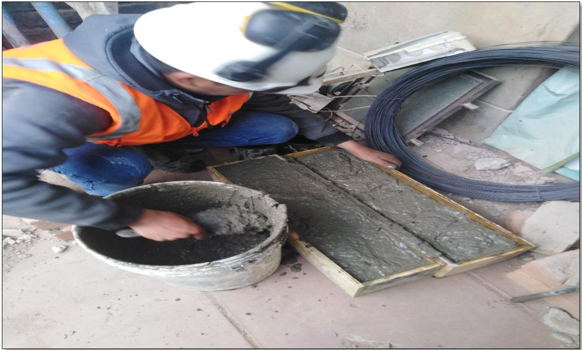
Fotografía 21. Se observa el llenado de las vigas, con la ayuda de un cucharón metálico y no con otra herramienta que podría hacer perder la pasta de la muestra que fue ensayada posteriormente.
