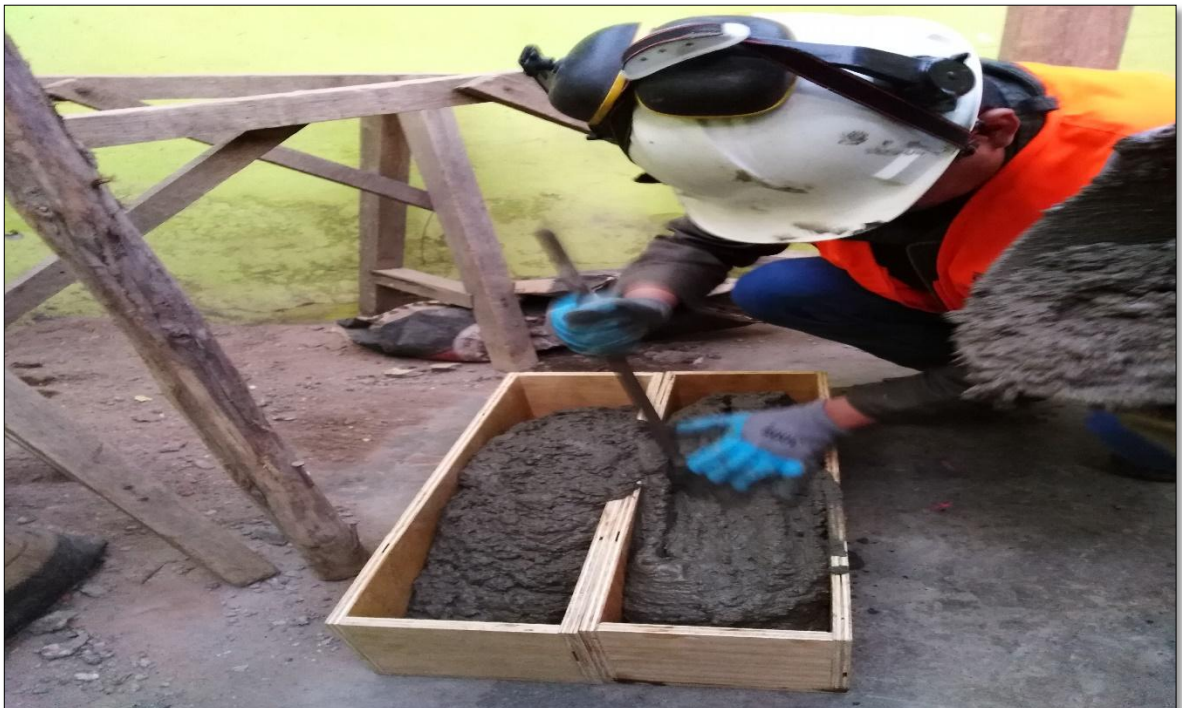
Fotografía 5. Se puede ver la medición del Slump, para este procedimiento es necesario invertir el cono de Abrams y tomar como línea horizontal a la barrilla lisa.
