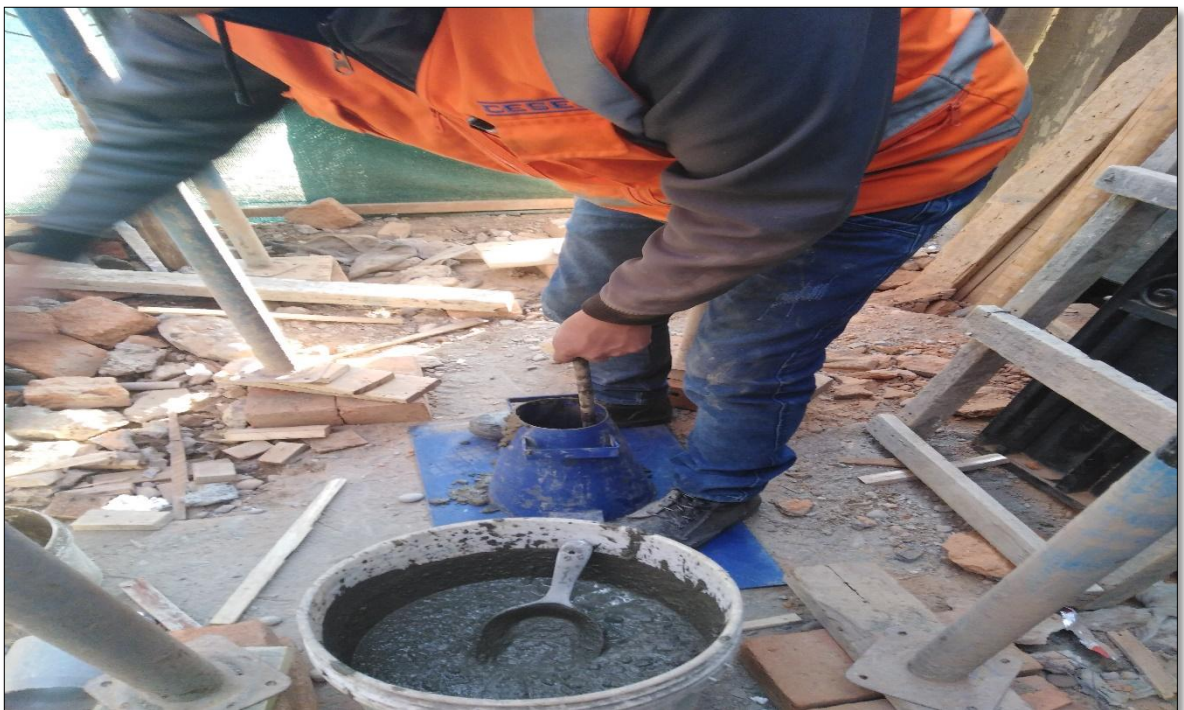
Fotografía 18. Se puede apreciar la colocación de la primera capa de concreto en el cono de Abrams para posteriormente ser compactado con 25 golpes con la varilla lisa, y así lograr el procedimiento hasta ser enrasado.
