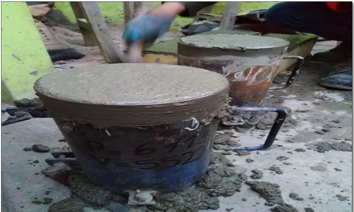
Fotografía 7. Se muestra el enrasado final de la colocación del concreto en los moldes de las vigas, se ensayó dos vigas para obtener un promedio de la resistencia a flexión.
