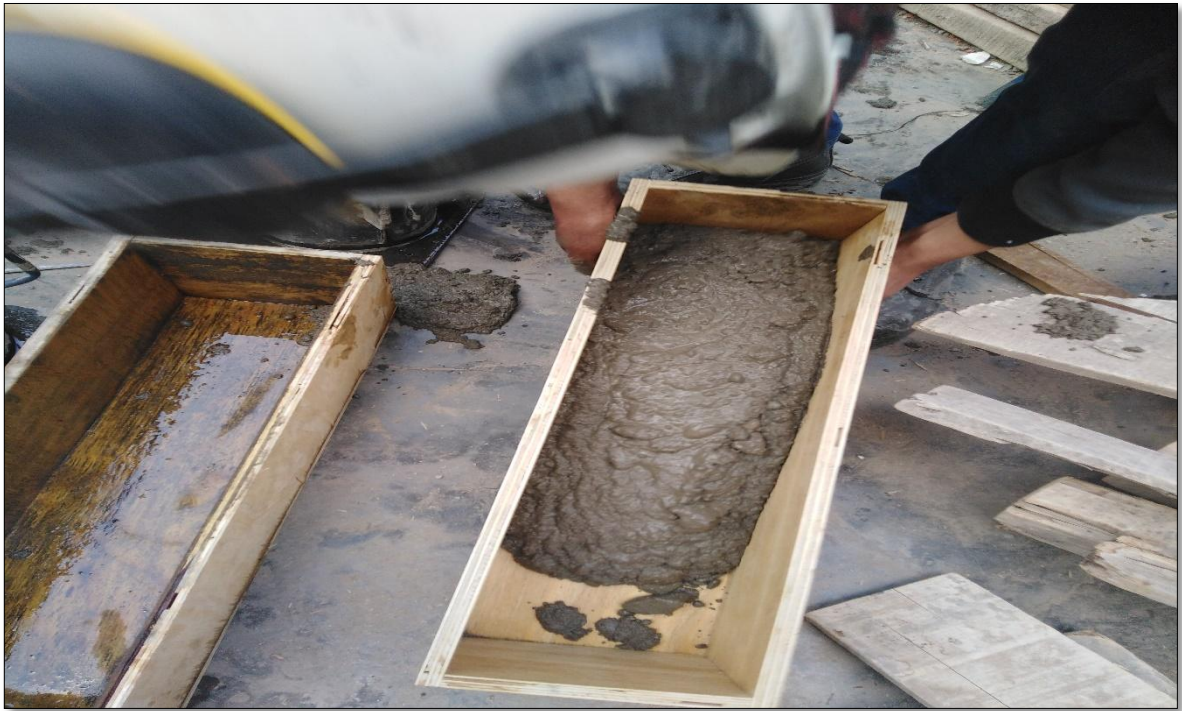
Fotografía 27. Se puede observar la colocación del concreto en la viga, que posteriormente fue ensayada en el laboratorio para obtener la resistencia a la flexión de este material.
