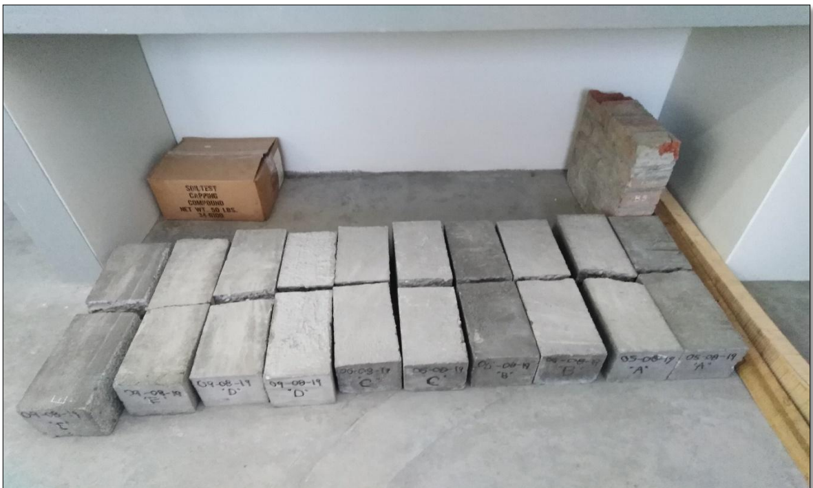
Fotografía 38. Se aprecian las vigas fabricadas con hormigón luego de ser ensayadas en la prensa del ensayo a flexión, todas las vigas muestran sus respectivas rotulaciones.
