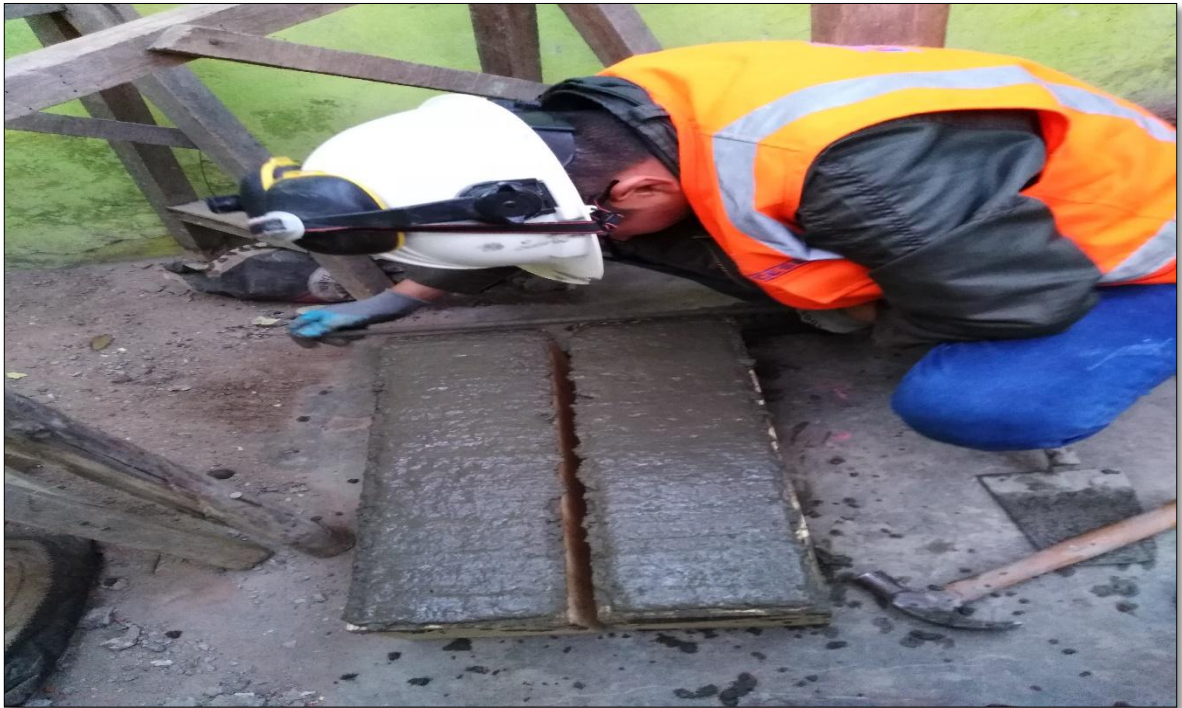
Fotografía 7. Se muestra el enrasado final de la colocación del concreto en los moldes de las vigas, se ensayó dos vigas para obtener un promedio de la resistencia a flexión.
