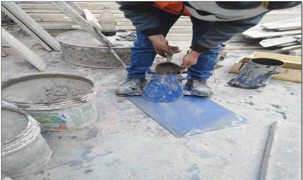
Fotografía 24. Se observa el llenado de concreto en el cono de Abrams, se procedió como especifica la normativa del ensayo de Asentamiento.
