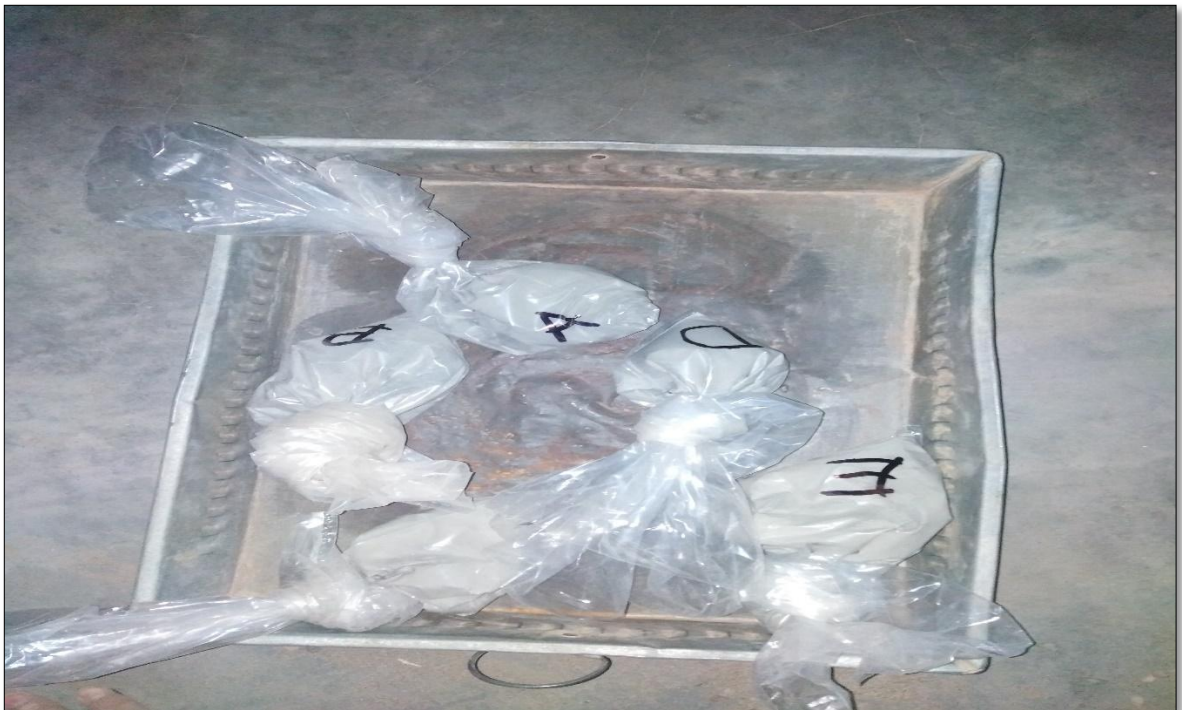
Fotografía 30. Se aprecia el muestreo del cemento utilizado en cada elaboración del concreto, para lo cual se ha obtenido 50 gr. que posteriormente se llevaron al laboratorio.
