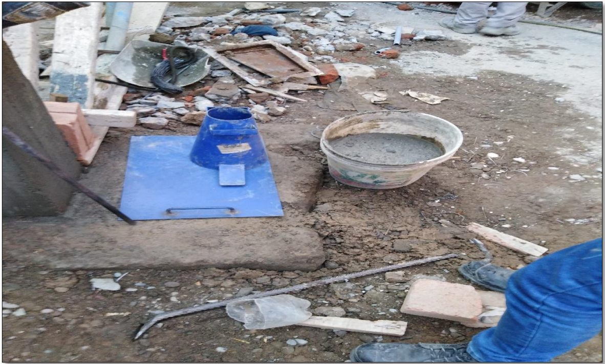
Fotografía 3. Se visualiza el procedimiento para el ensayo de asentamiento (Slump), para esto se necesitó una cantidad de concreto extraído de la colocación del concreto.
