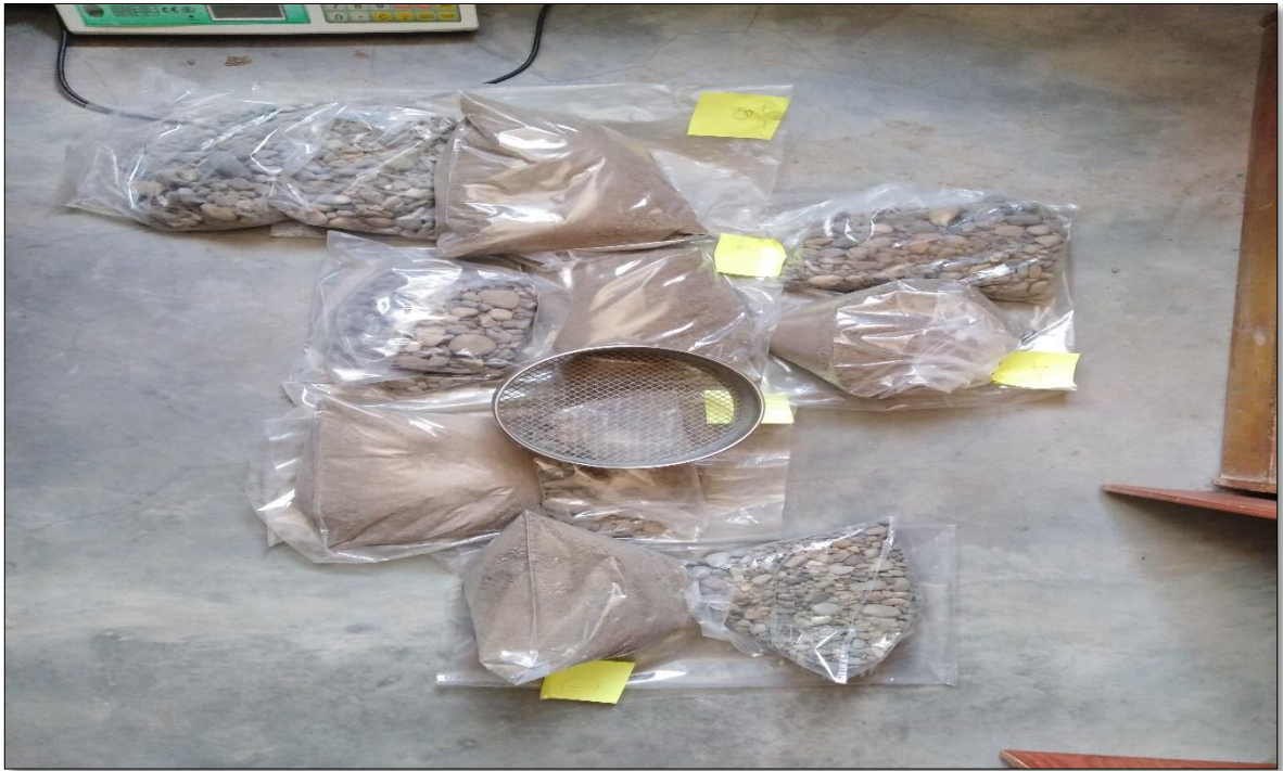
Fotografía 29. Se observa el muestreo realizado para el hormigón, de los cuales se realizó el tamizado previo por la malla N°4, logrando obtener una proporción de grava y arena.
