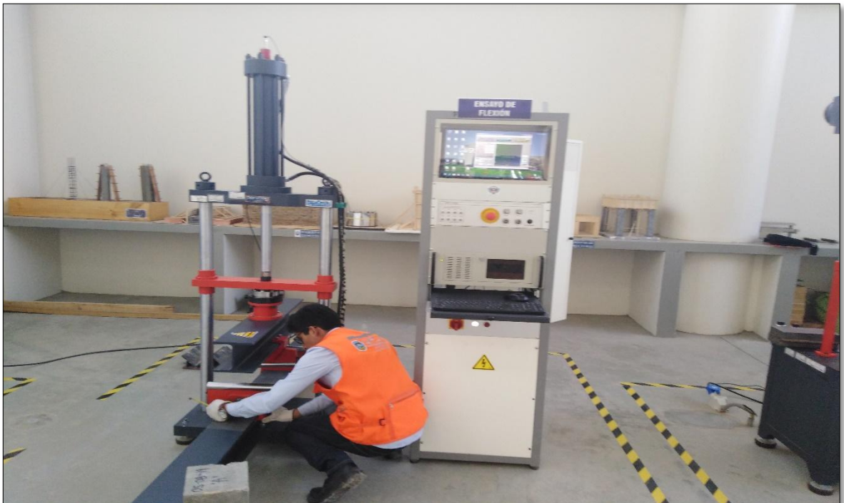
Fotografía 36. Se visualiza al encargado del laboratorio midiendo los apoyos de la prensa a una distancia de 58 cm del centro de la luz de la viga, para posteriormente aplicar la fuerza vertical.
