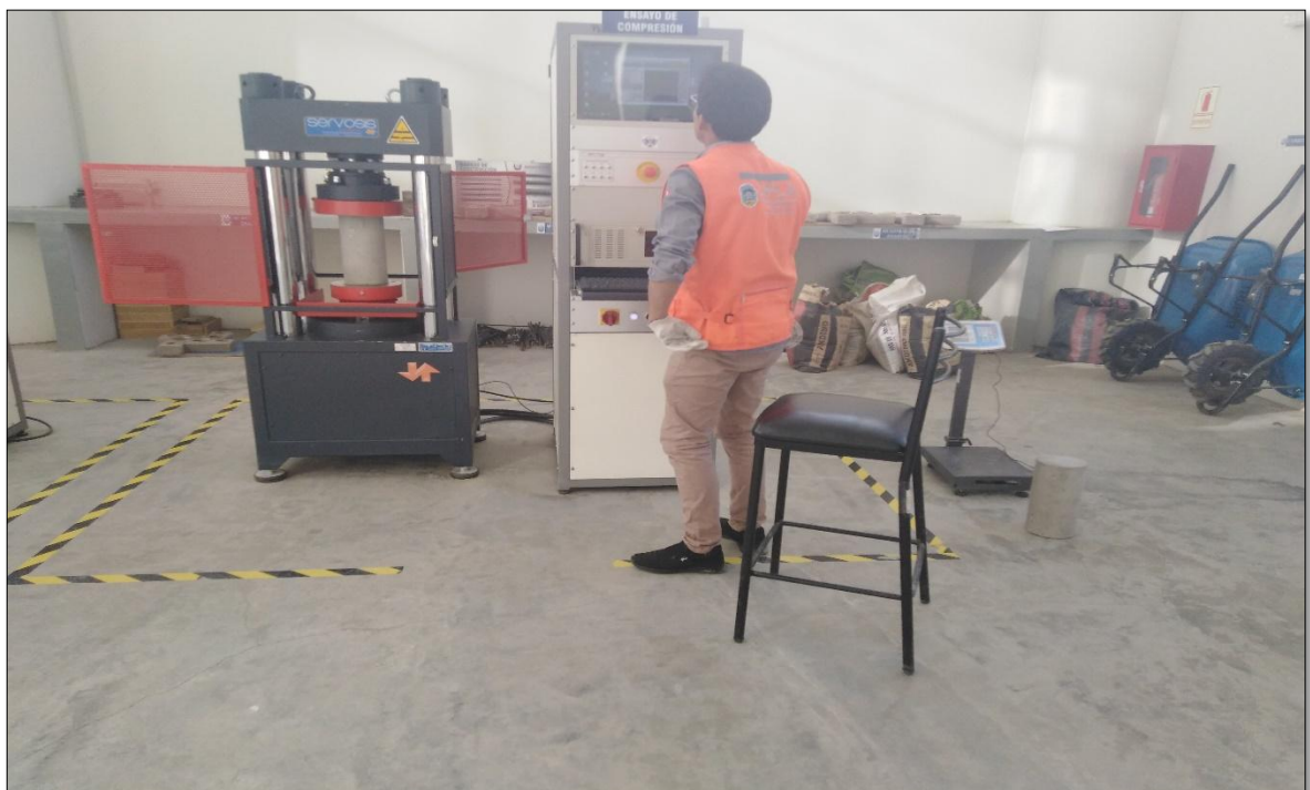
Fotografía 34. Se puede apreciar la prensa para el ensayo a compresión, la cual se tiene que alimentar de algunos datos previo a la rotura, como el peso del espécimen, las fechas de fabricación y rotura.
