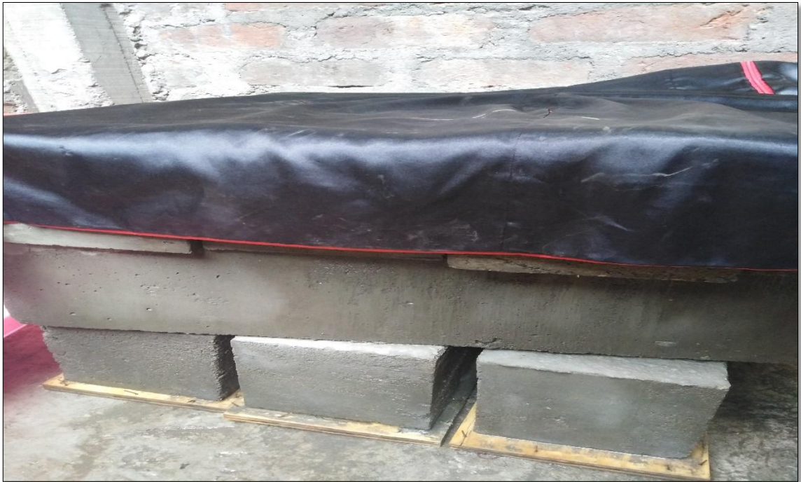
Fotografía 31. Se observa el curado que tuvo las vigas por 28 días, se procedió a mantener húmeda las muestras las 24 horas, con la ayuda de un material con características absorbentes se cubrió para mantener una humedad constante.
