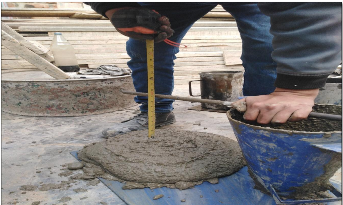
Fotografía 26. Se puede ver a la muestra ensayada después de retirar el cono, para realizar la medición del Slump con un flexómetro.
