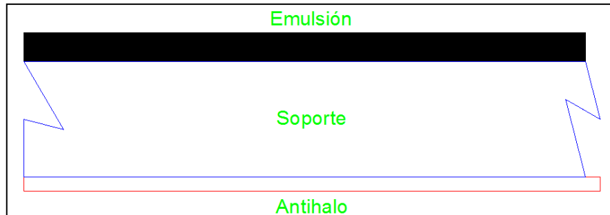
Figura 8: Estructura de un soporte fotogramétrico.
