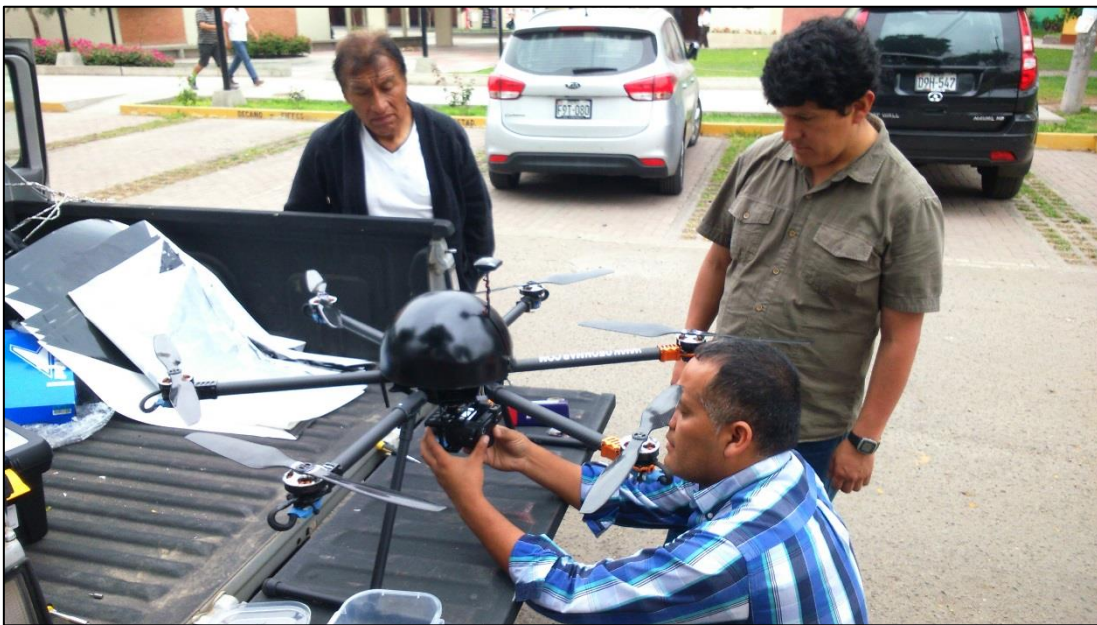
Instalación de gimbal y cámara en drone hexacoptero
