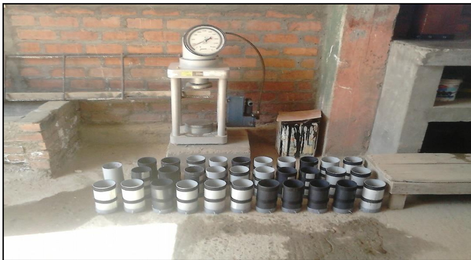
Los moldes para los testigos de Pvc
