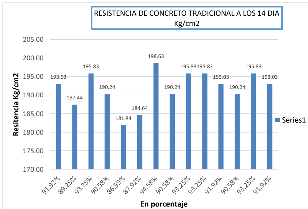
FIGURA N° 06 Resistencia de concreto tradicional.
