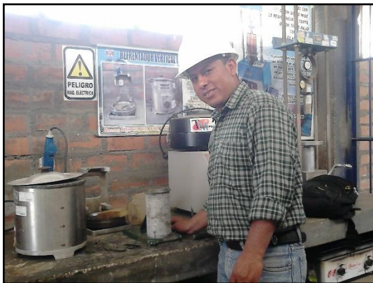
Probetas con el capin, listos para ser sometidos a la máquina de compresión
