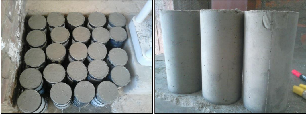
Testigo o probetas para curarlos en agua
