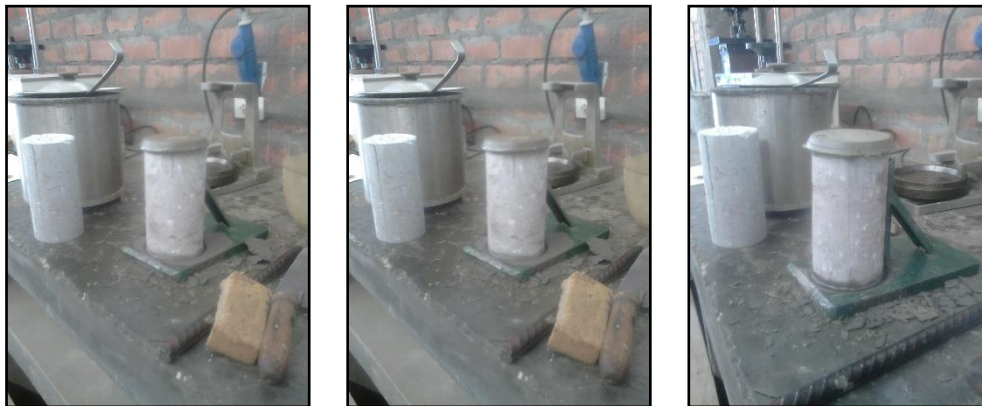
Colocando el capin al concreto en Angulo de 90°
