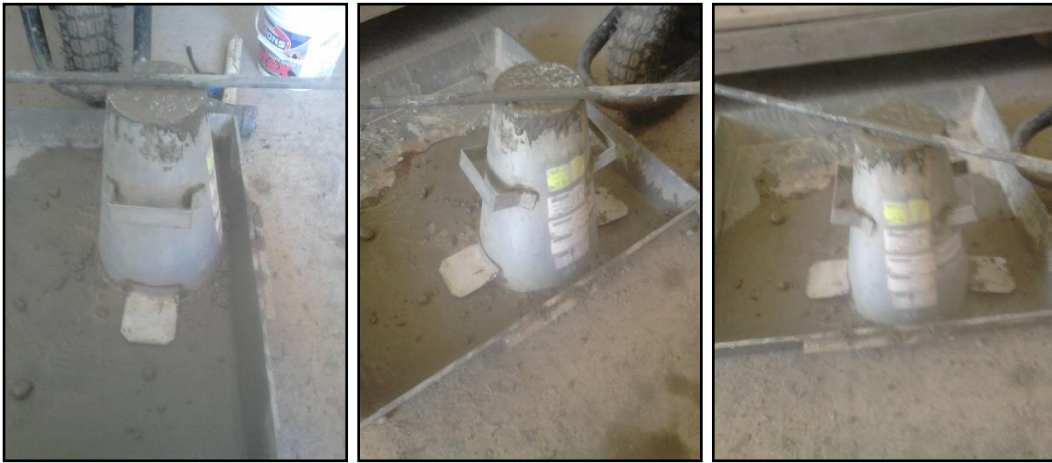
Medición del slump
