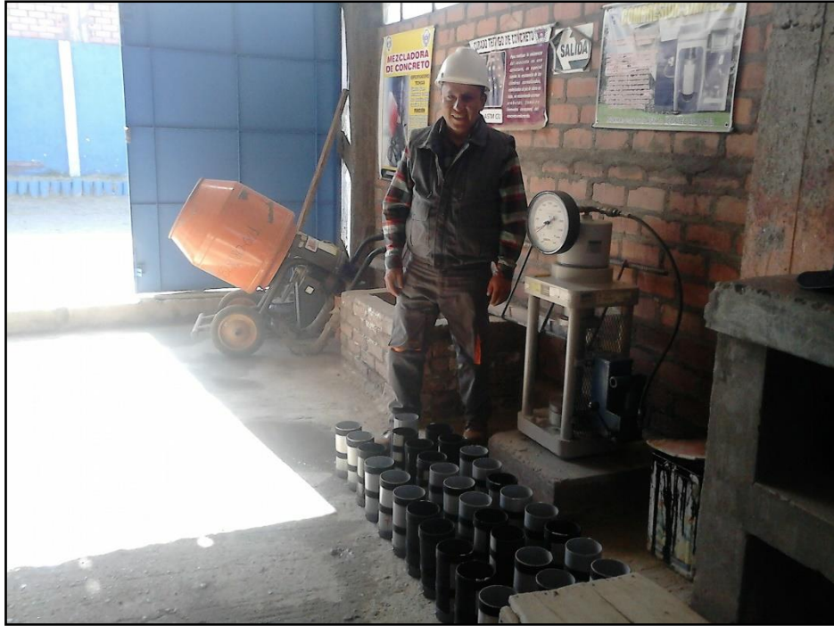
Los moldes para los testigos de Pvc
