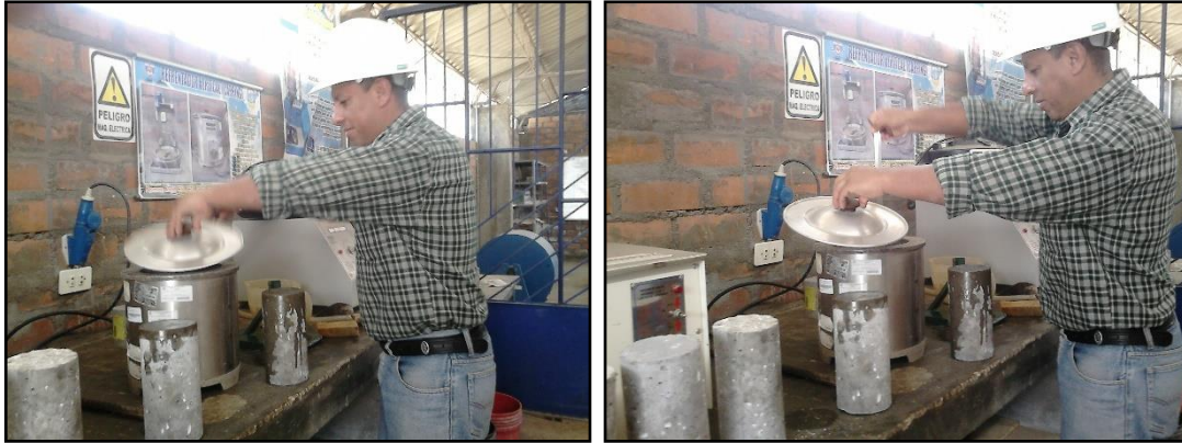
Colocándolo el capin al testigo
