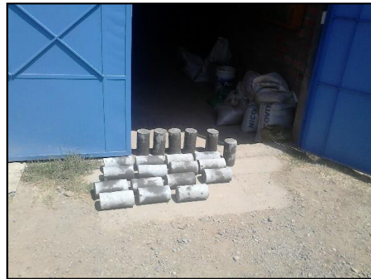
Probetas sometidas a la prueba de compresión mecánica
