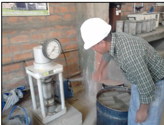
Probetas sometidas a la prueba de compresión mecánica
