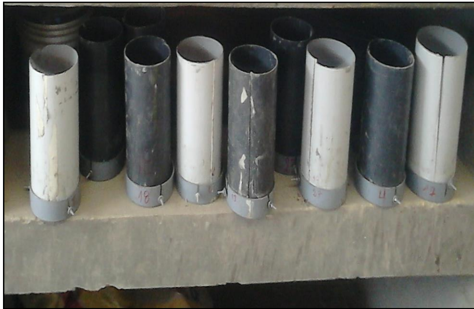
Los moldes para los testigos de Pvc
