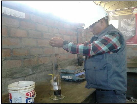
Agitando la probeta con el agua y viruta de acero
