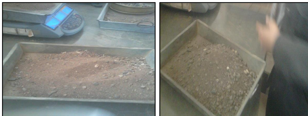
Agregado fino para la mezcla de concreto
