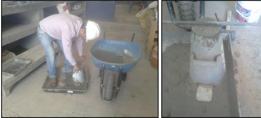
Enrasando el concreto término de la consolidación
