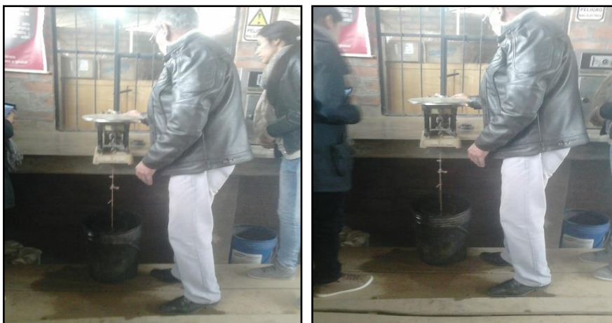
Pesando el agregado grueso sumergido
