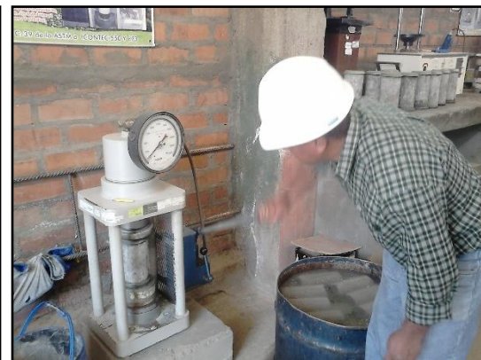
Probetas sometidas a la prueba de compresión mecánica
