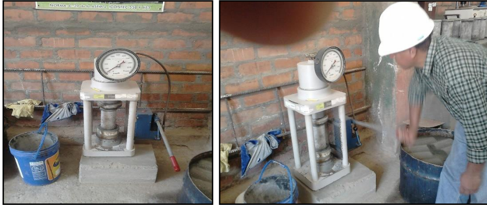
Se observa la compresión del concreto
