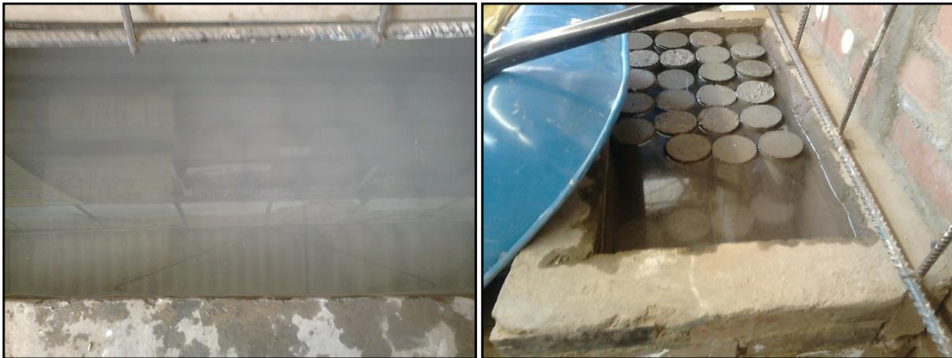
Testigo o probetas para curarlos en agua
