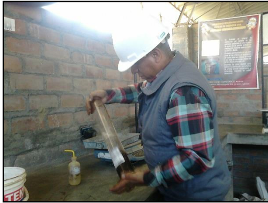
Agitando la probeta con el agua y viruta de acero
