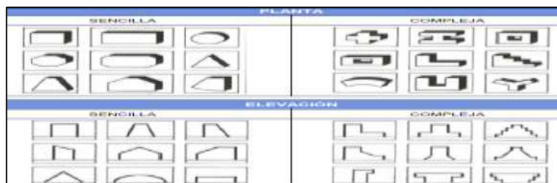
Figura 2.15: Configuración en Planta y Altura Fuente: Jaramillo (2006)
