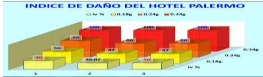
Figura 4.14: Nivel de daño (%) estimado del Monumento Hotel Palermo
