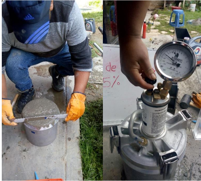
Fotografía 9 y Fotografía 10. Medición del contenido de aire en el concreto.
