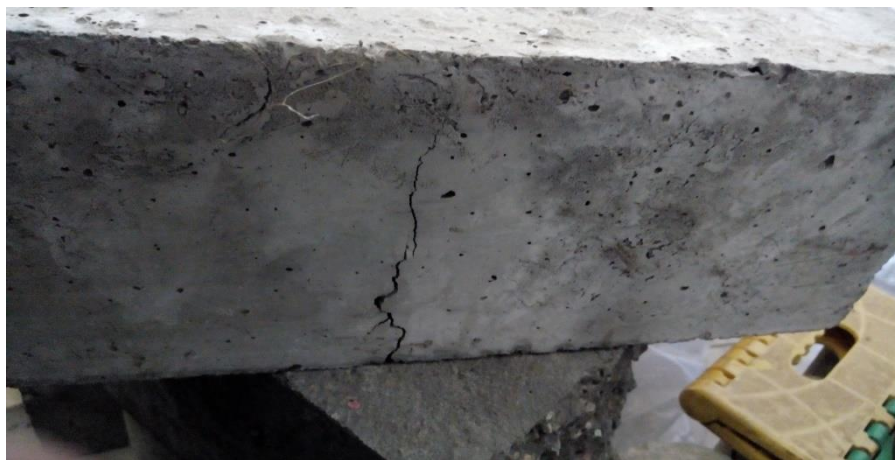
Fotografía 18. Viga con adición de fibra de maguey flexionada.
