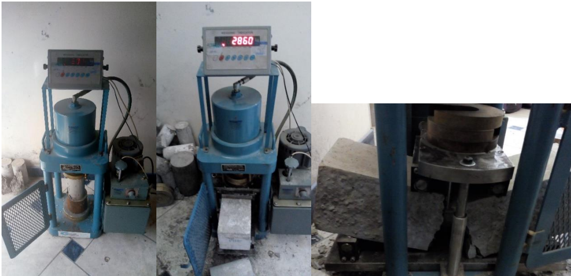
Fotografía 15, Fotografía 16 y Fotografía 17. Roturado de probetas y flexión en vigas.
