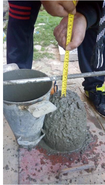
Fotografía 7. Medición del asentamiento del concreto.
