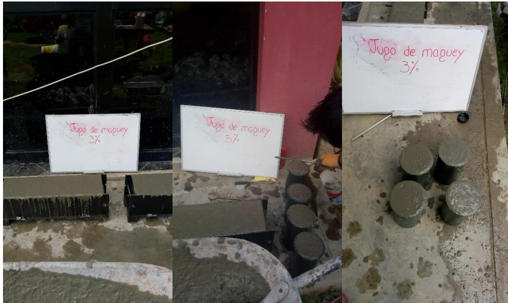
Fotografía 11, Fotografía 12 y Fotografía 13. Viga y probetas de concreto más jugo de maguey.
