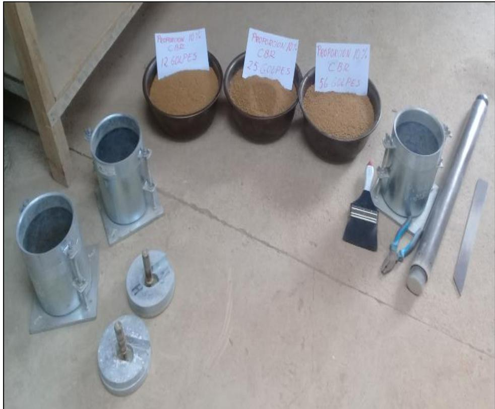
Figura 23: Equipos para el ensayo de CBR
