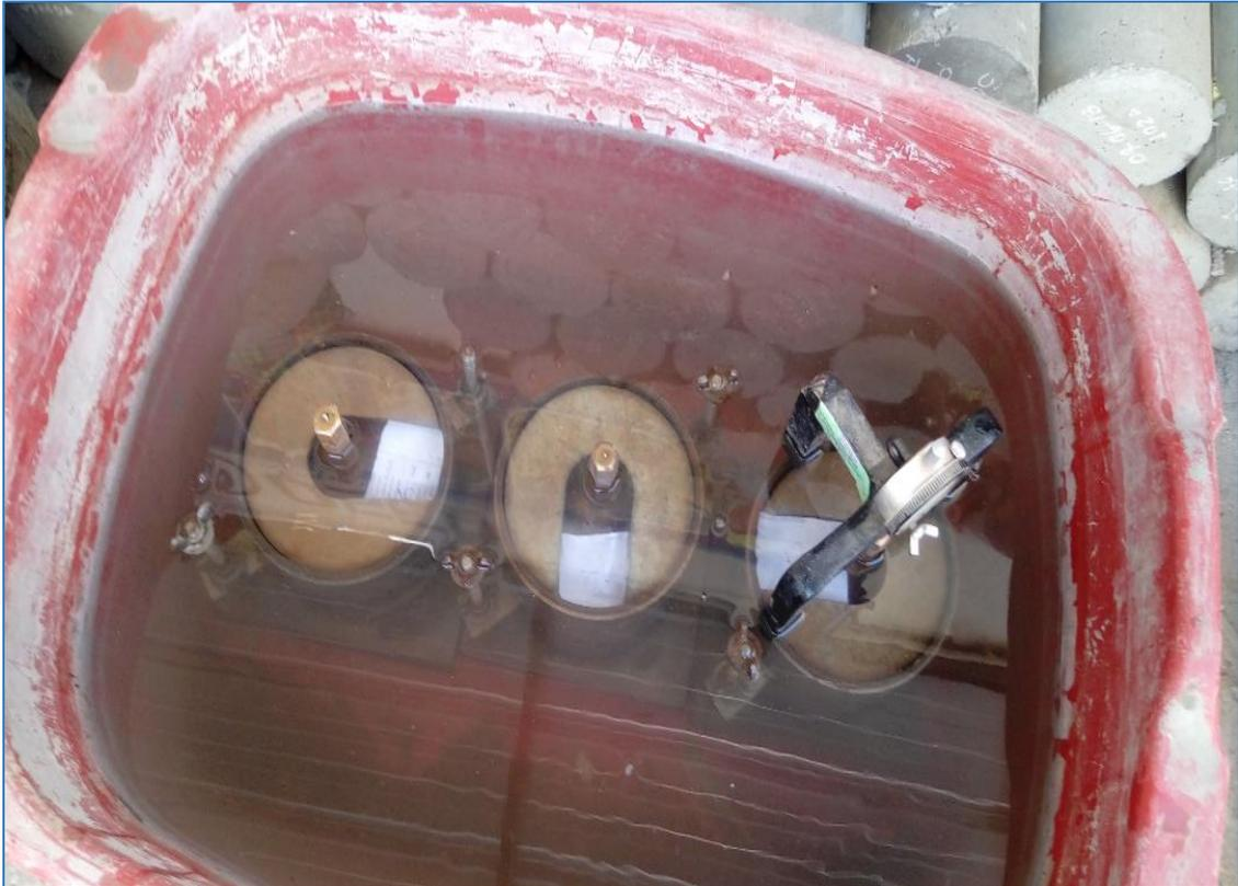
Molde CBR con material ensayado sumergido durante 96 horas.
