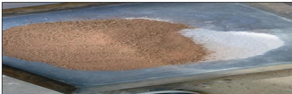
*Figura 18: Preparación del material para el Ensayo de Proctor Modificado*
