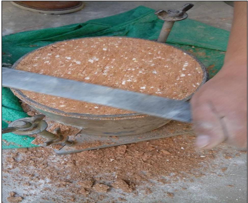
Figura 24: Enrasando la superficie del molde
