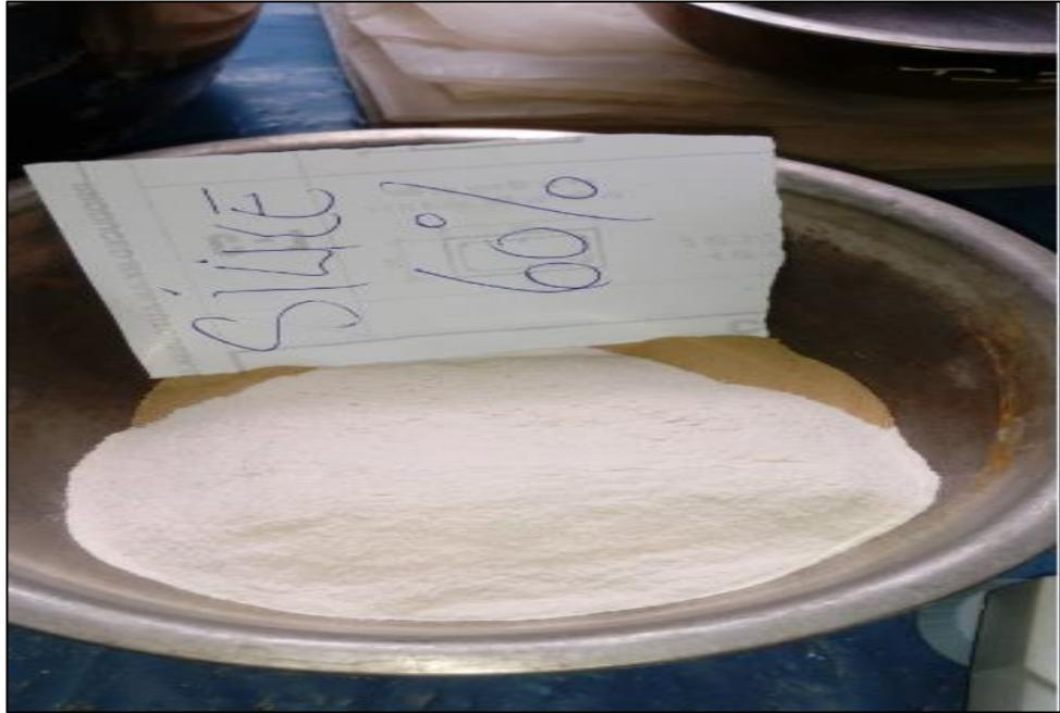
*Figura 11: Combinación arena de sílice y material de subrasante C-60%.*
