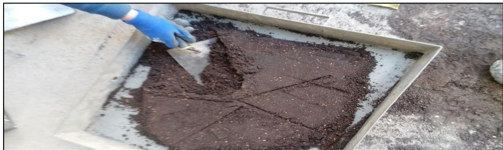
*Figura 19: División del material para el ensayo*
