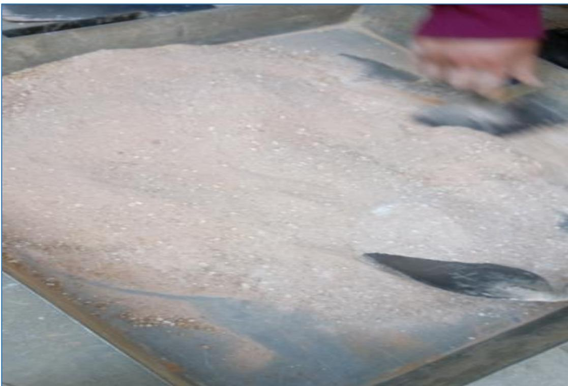
Preparación del material combinado para ensayo proctor modificado
