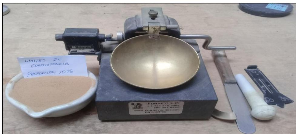
Figura 14: Materiales y muestra para ensayo de Límite Liquido C-10%
