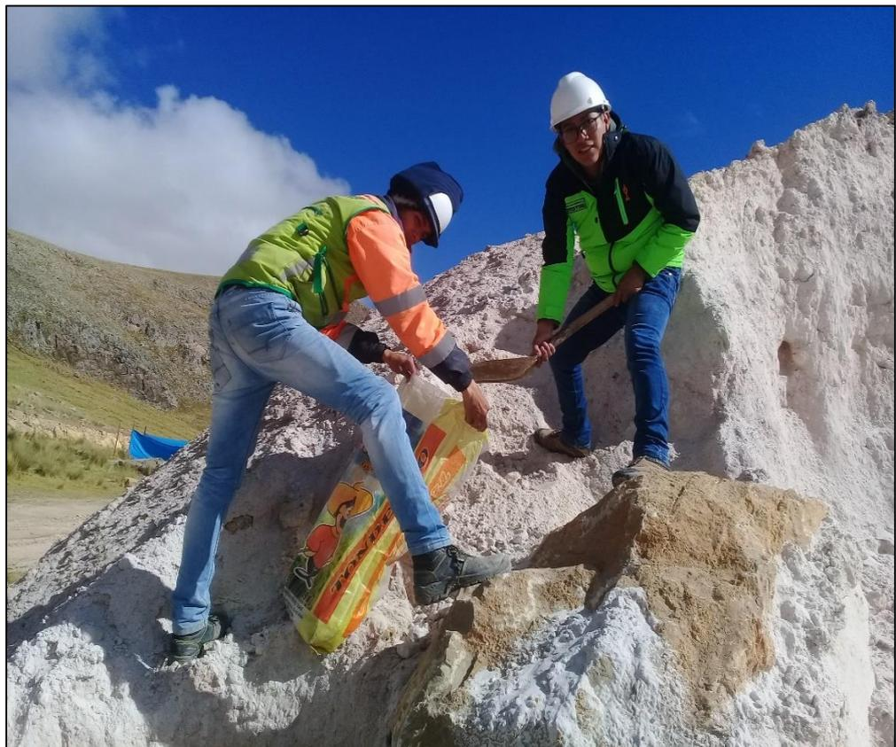
*Figura 61: Muestreo de Arena de Sílice en el Km: 27+650.00*
