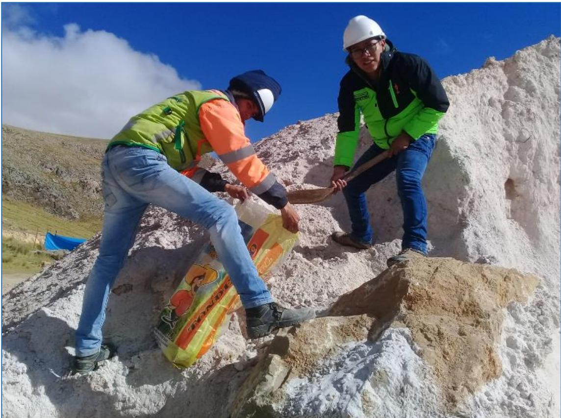
Muestreo de Arena de Sílice en el depósito de Arena de Sílice del Km 27+650
