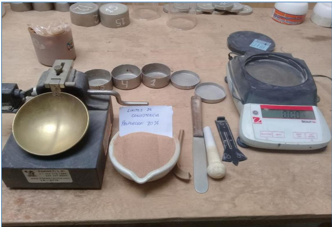
Material y equipos listos para realizar el ensayo de límites de consistencia de la combinación C-20%.
