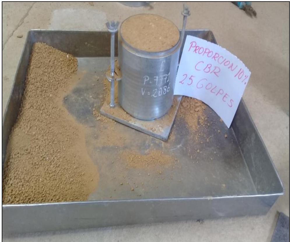
Figura 25: Ensayo CBR terminado
