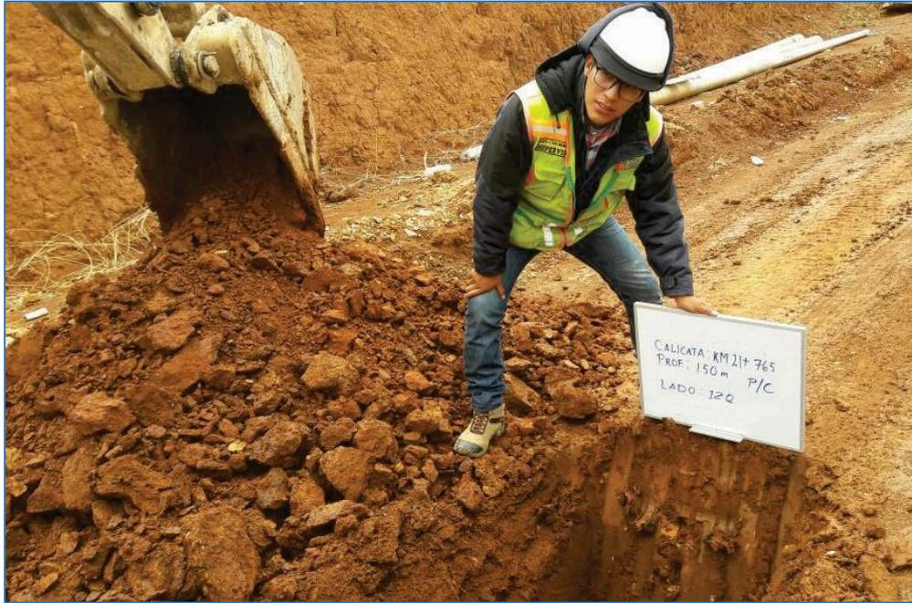
*Figura 33:* Calicata 03 - Muestreo de material de Subrasante Km: 21+765.00
