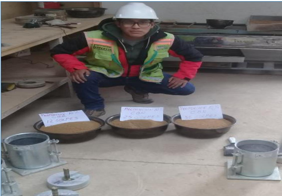
Preparación del material de la combinación C-10% para realizar ensayo de CBR
