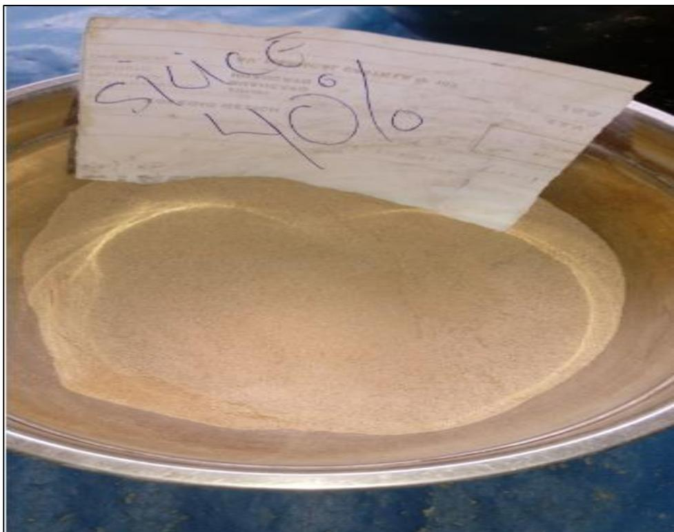
*Figura 10:* Combinación arena de sílice y material de subrasante C-10%
