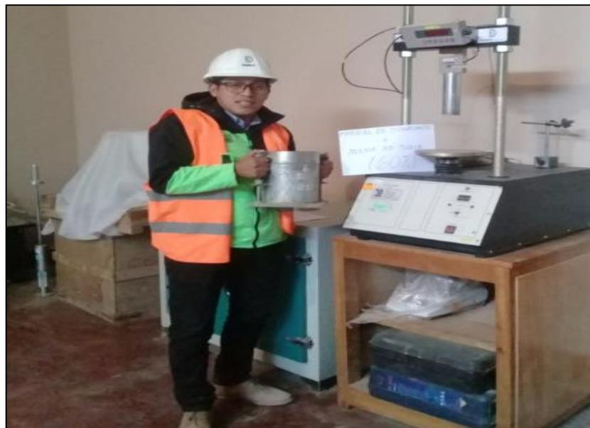
*Figura 30: Molde listo para su penetración en la maquina CBR*
