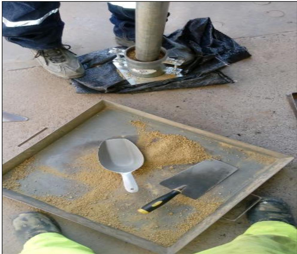
*Figura 21: Golpes con el pisón al material de ensayo*
