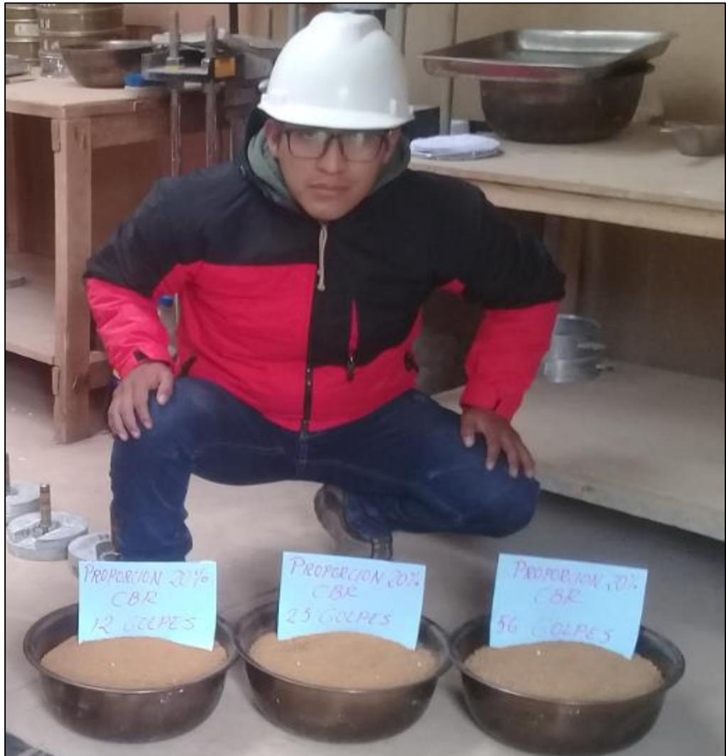
*Figura 22: Muestras preparadas para ensayo de CBR*
