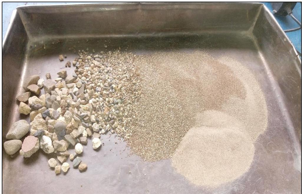
*Figura 13:* Diferencia granulométrica del material de Subrasante tamizado
