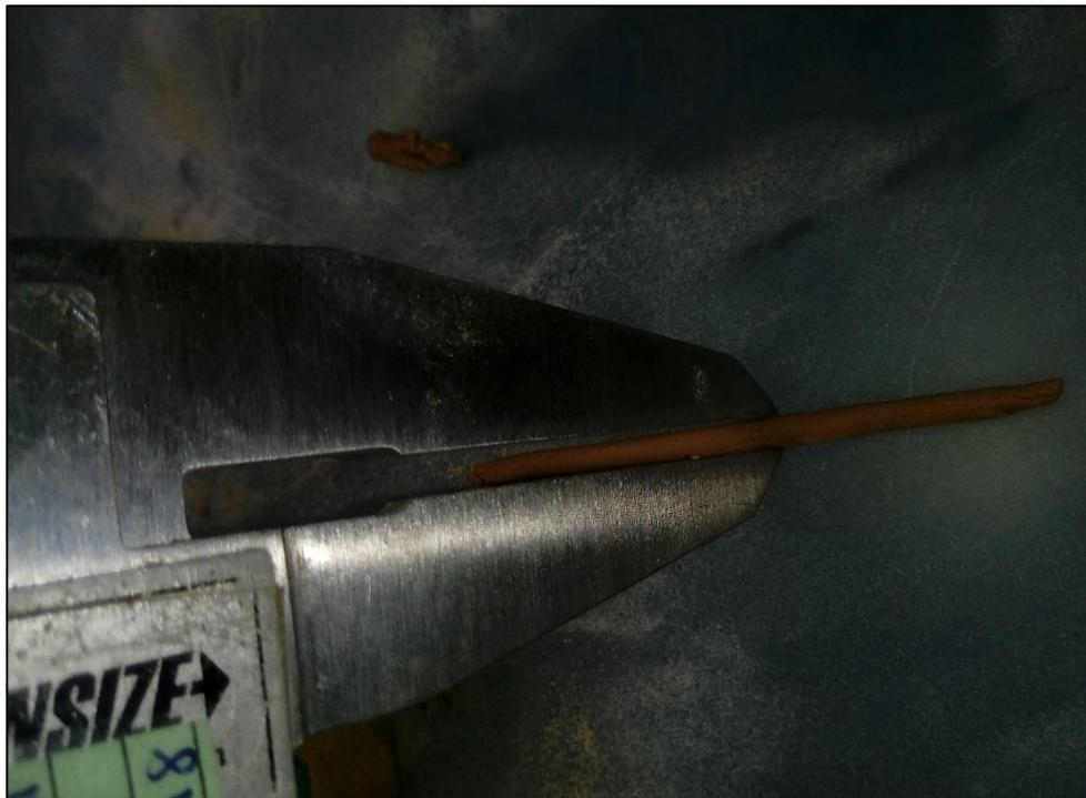
*Figura 17: Verificación en el ensayo de Limite Plástico*
