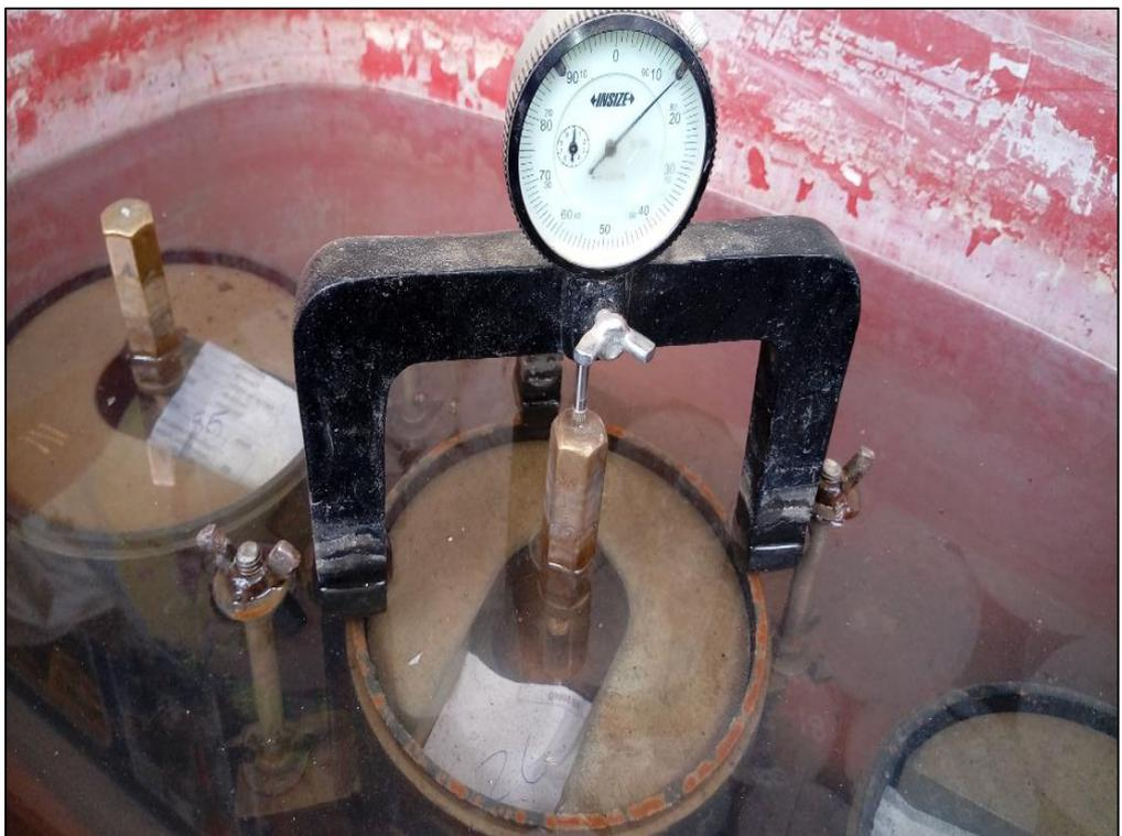
*Figura 28: Medida de la expansión en el segundo molde*
