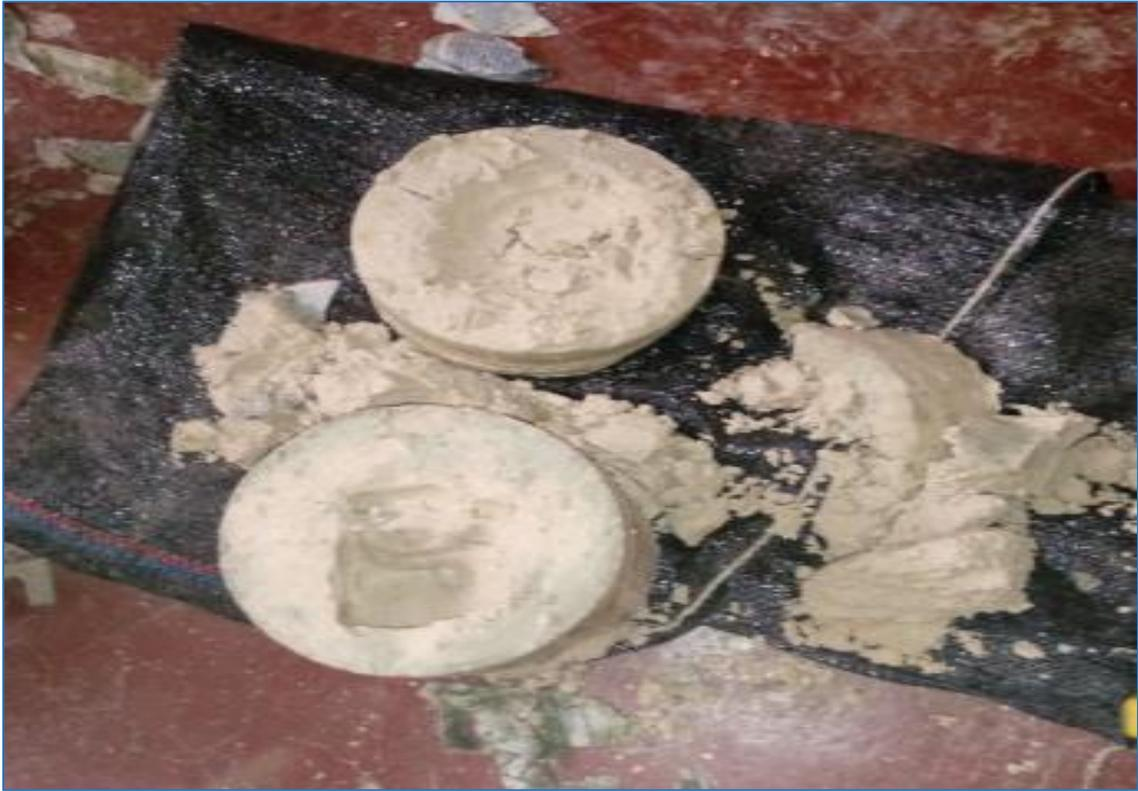
Proceso de ensayo de proctor modificado al material de Arena de Sílice con el método "B"
