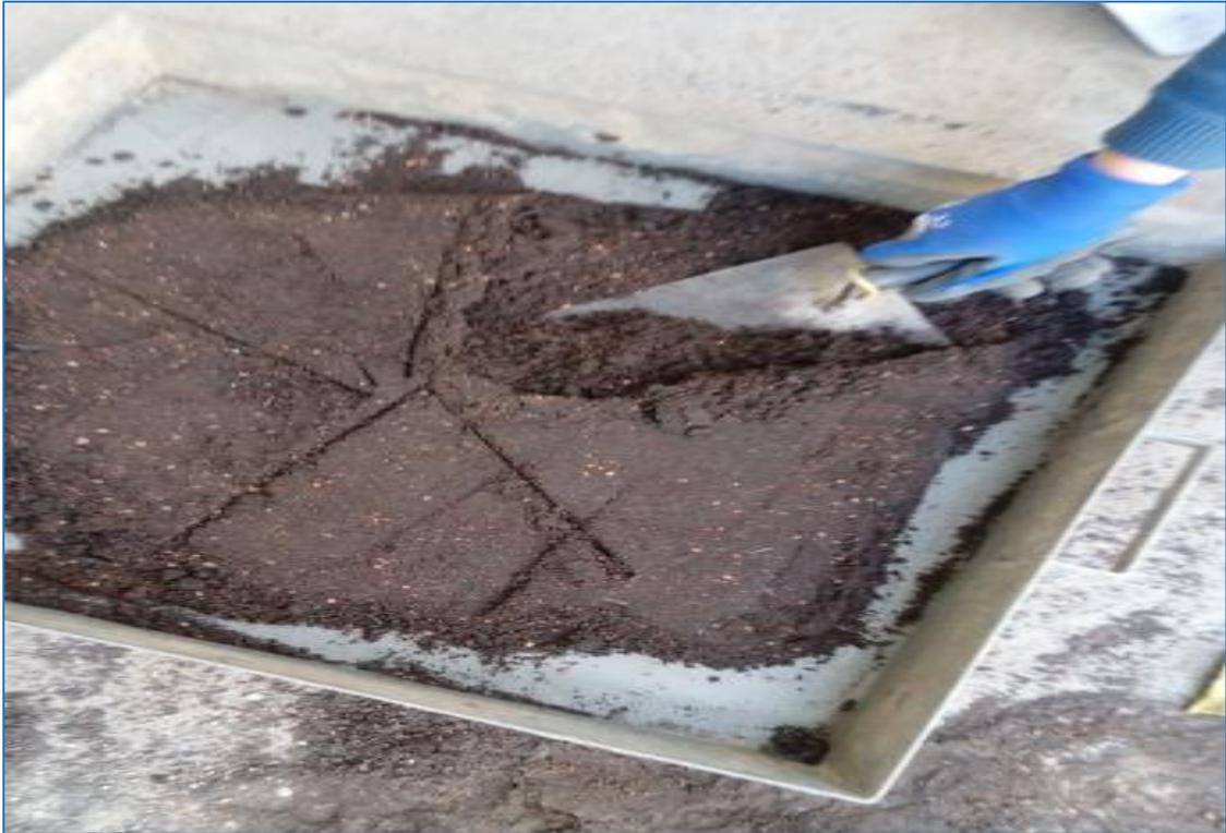
Preparación de la combinación para realizar ensayo de proctor modificado método "B"
