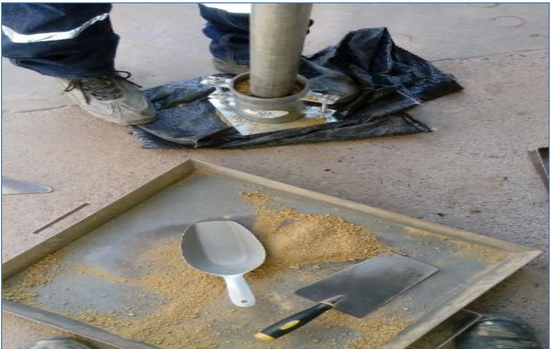
Proceso de ensayo de proctor modificado con el método "B" de las distintas combinaciones
