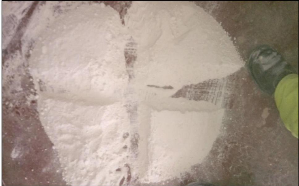
*Figura 8:* Cuarteo del material de Arena de Sílice
