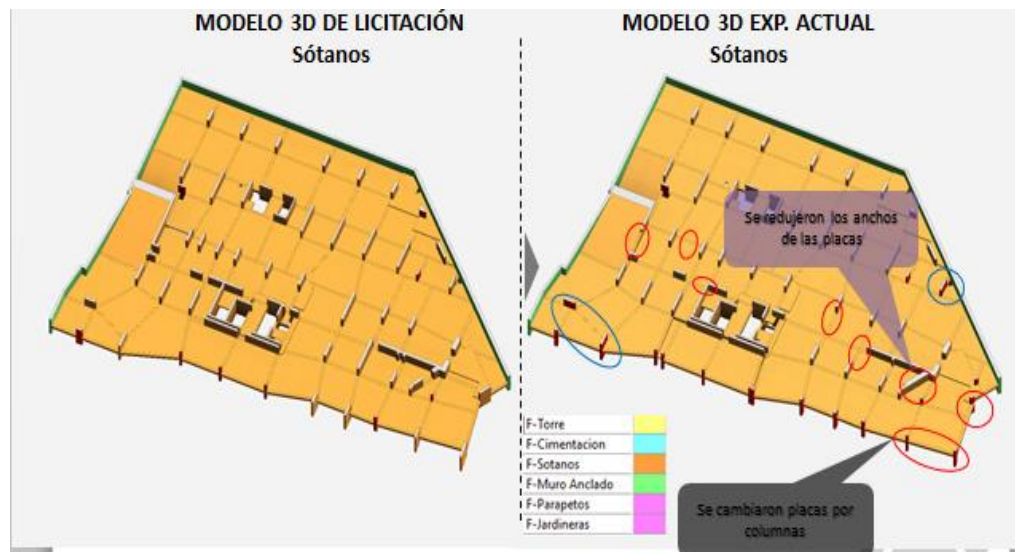
Gráfico 55: Modelo corregido de las incompatibilidades encontradas en placas y columnas de la Vivienda Multifamiliar Nesta.
