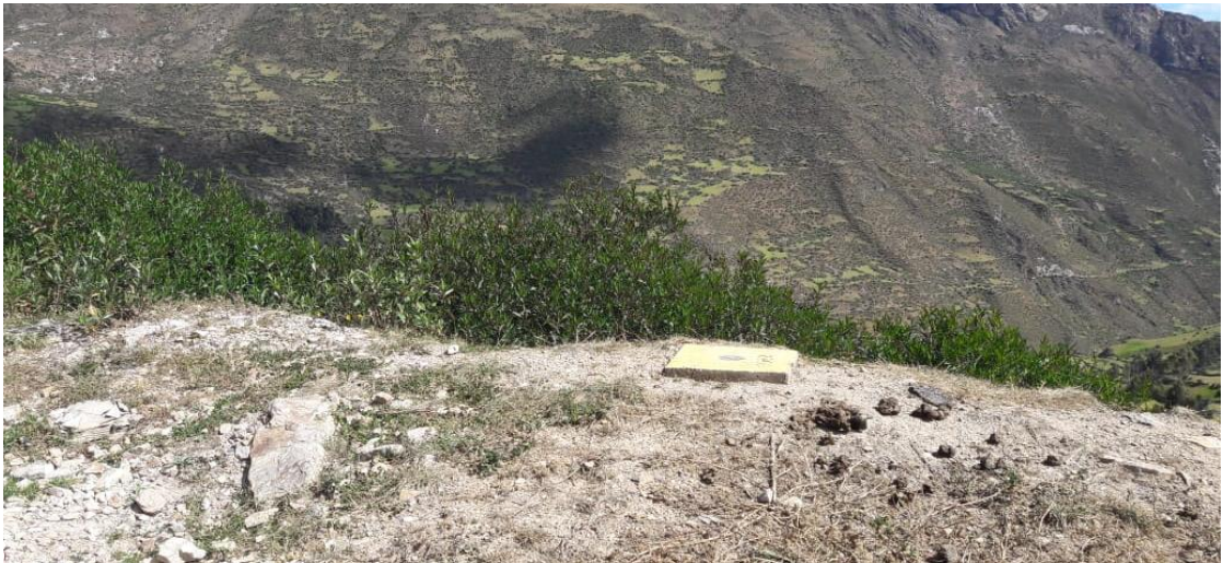
Figura 20: puntos de control topográfico
