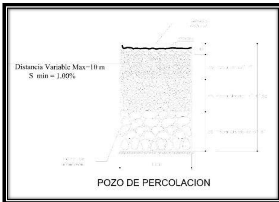
Figura 14 pozo de percolación( fuente: Instalación del sistema de agua potable y letrinas en CC. NN Centro Somaveni de la cuenca del río Ene, distrito de Pangoa – Satipo - Junín)
