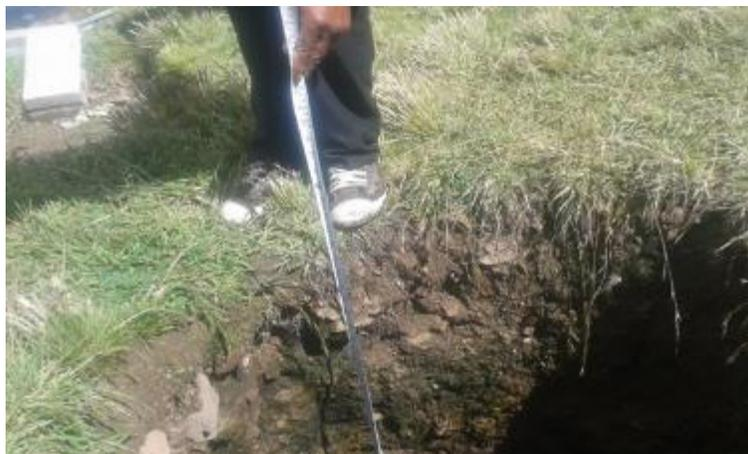
*Figura 19 nivel freático a menos de 0.80 m de profundidad ( fuente elaboración propia)*
