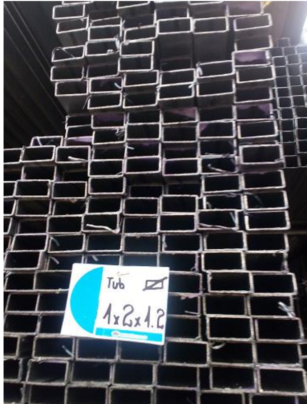
Muestra de un tablero en un casillero dando a conocer su descripción, su forma, su espesor y sus medidas.
