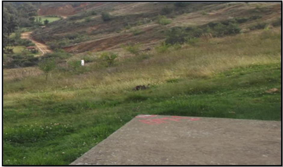
Fotografía 2.- Monumentación de punto de cambio
