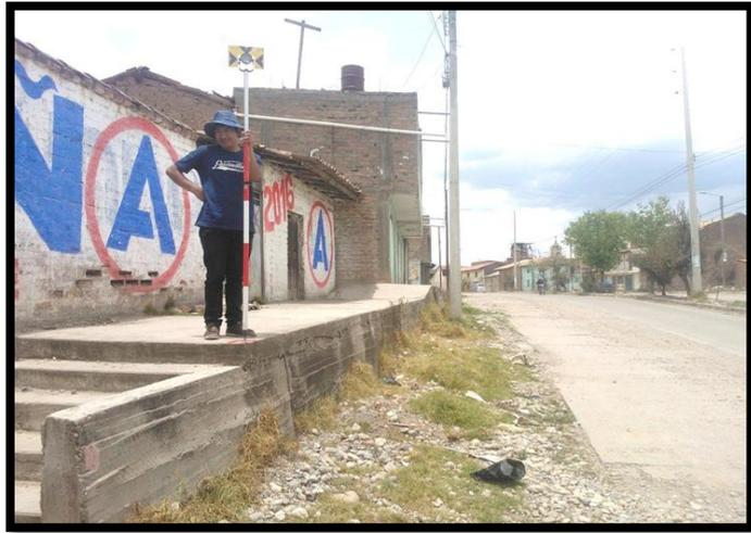
Fotografía 4.- Levantamiento topográfico de la sección Transversal
