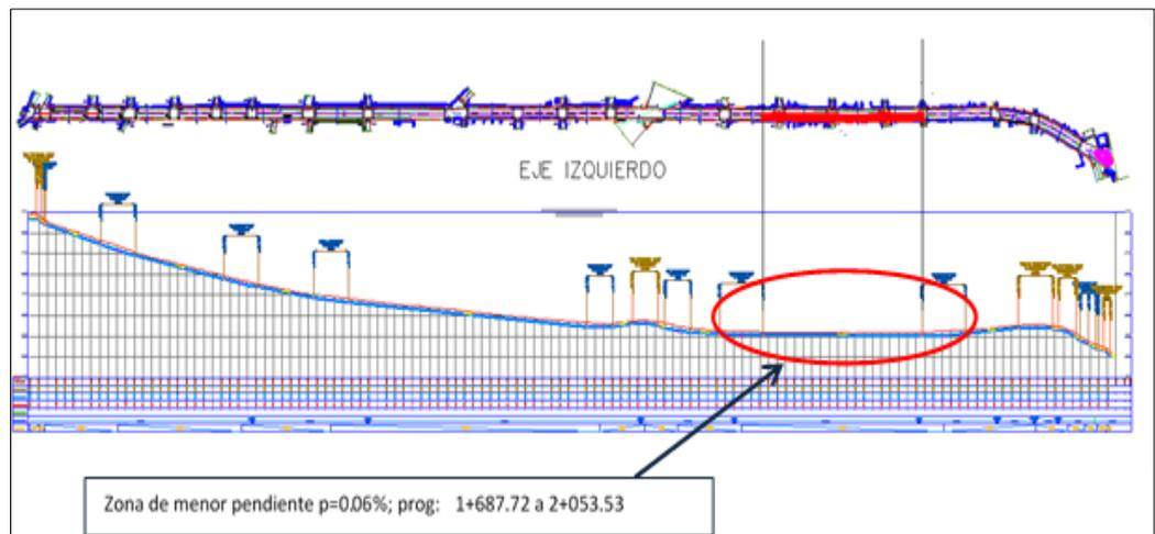
Ilustración 1.- Perfil del Eje de la Izquierda
