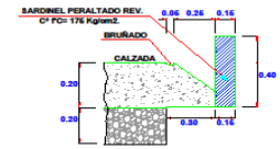
JUNTA DE EXPANSION (TIPO 02)
