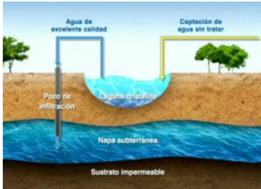
Figura 2.8 Tipos de captación de agua Fuente: "Hidrología General" curso virtual (2015) [digital]. Recuperado de http://.eduvirtual/RecursosHidricos/.org/? /pág./22 .
