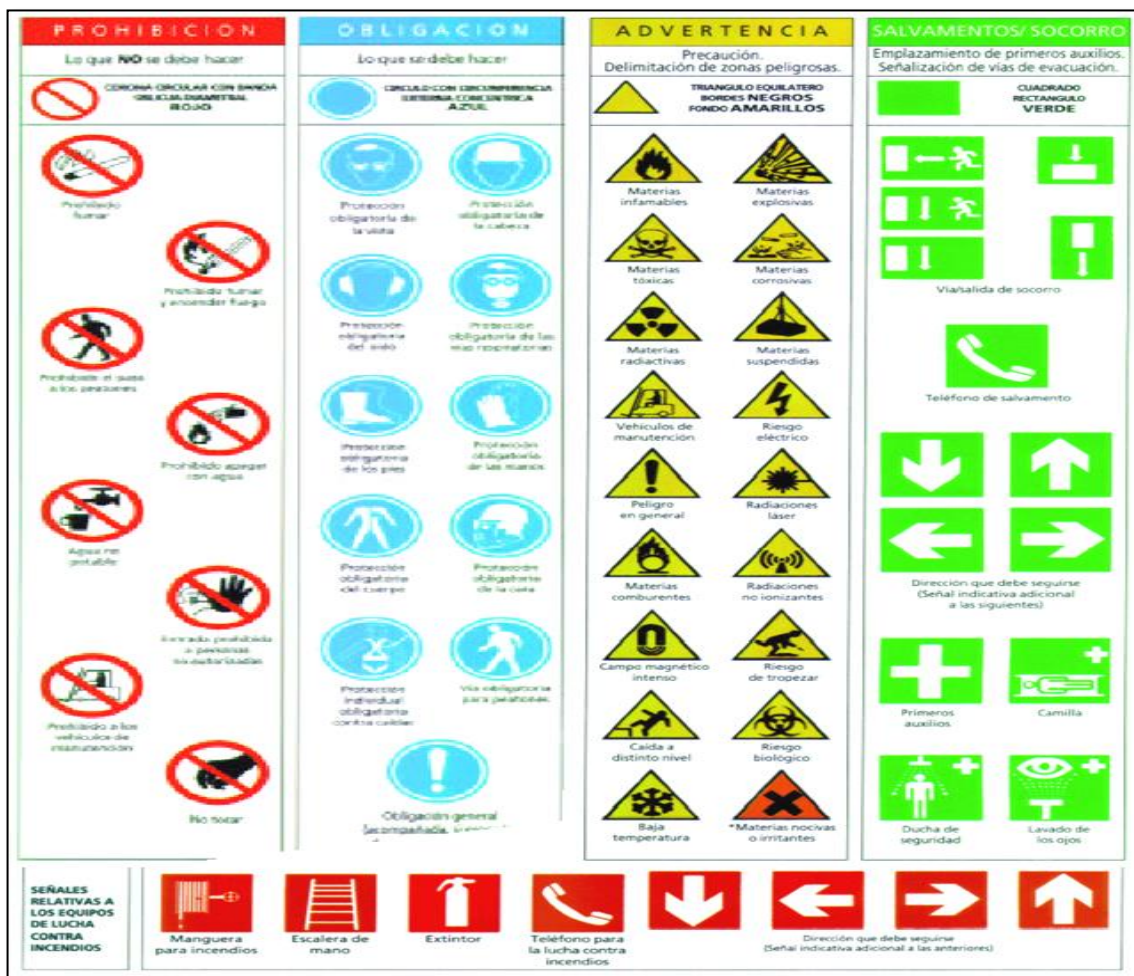
Ilustración 6 TIPOS DE SEÑALIZACION
