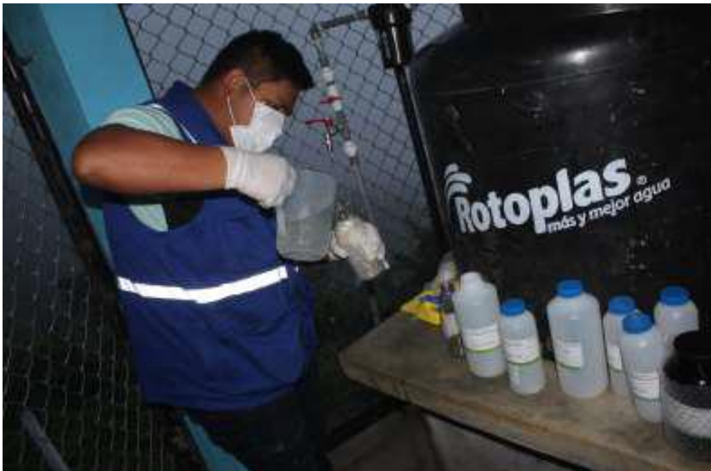
Fotografía 6. Toma de muestra de agua para la verificación del cloro residual.
