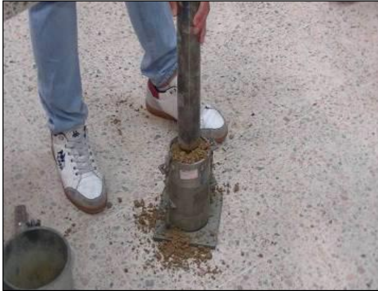
Figura 3: Imagen de compactación de Proctor Modificado
