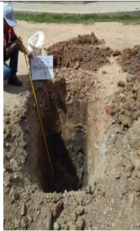
Medición de la profundidad y muestreo de la calicata 02
