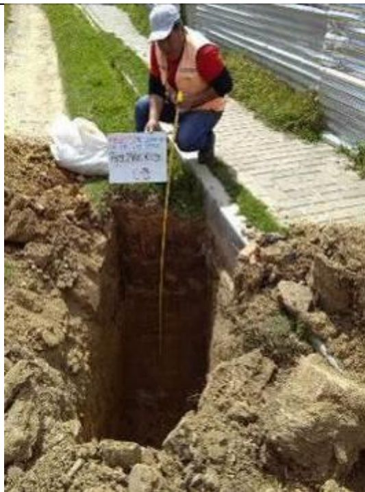
Medición de la profundidad y muestreo de la calicata 03
