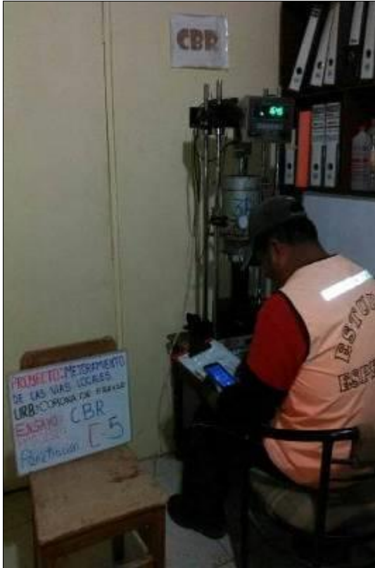
Vista del proceso del ensayo C.B.R de la calicata 05
