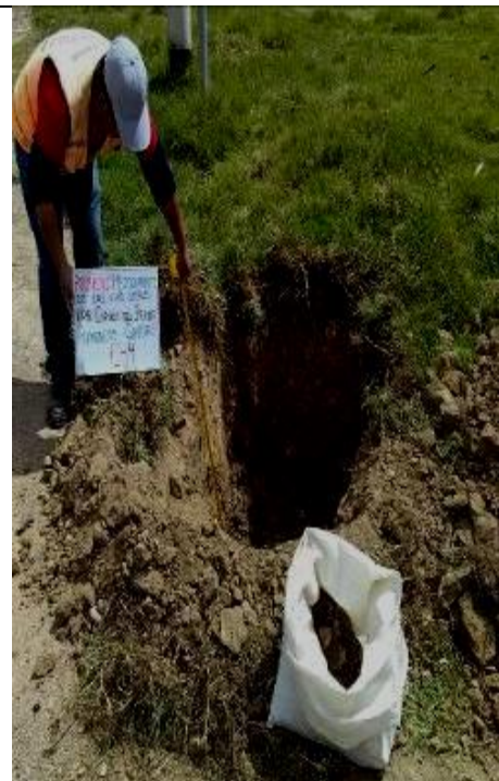
Medición de la profundidad y muestreo de la calicata 04
