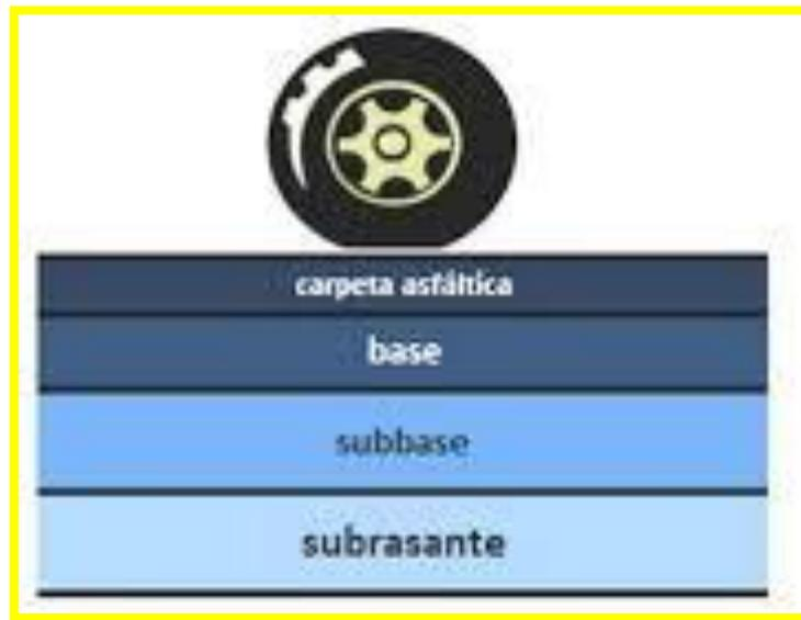
IMAGEN 2. Estructura de Pavimento.
