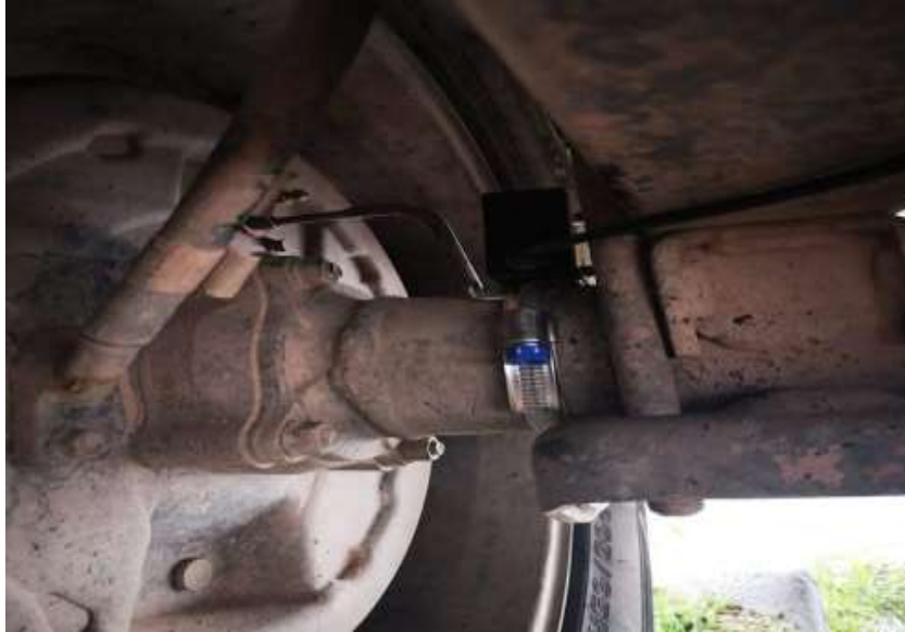
FOTOGRAFIA N° 07: INSTALACION DEL SENSOR EN EL EJE TRASERO DEL VEHICULO
