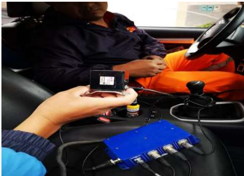
FOTOGRAFIA N° 08: CALIBRACION DEL SENSOR A 90 Y 180 GRADOS
