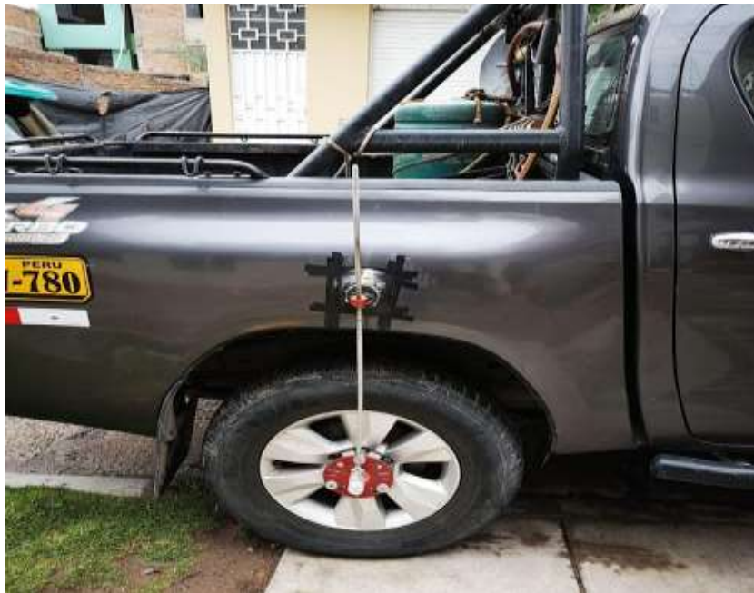
FOTOGRAFIA N° 02: INSTALACION DEL NIVELADOR
