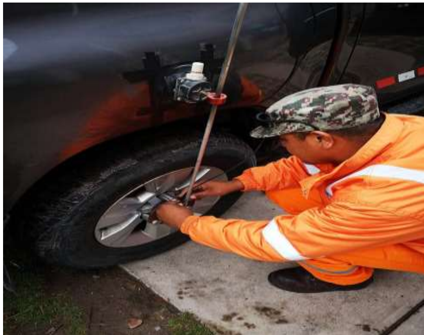
FOTOGRAFIA N° 03: INTALACION DEL CABLE DEL ODOMETRO
