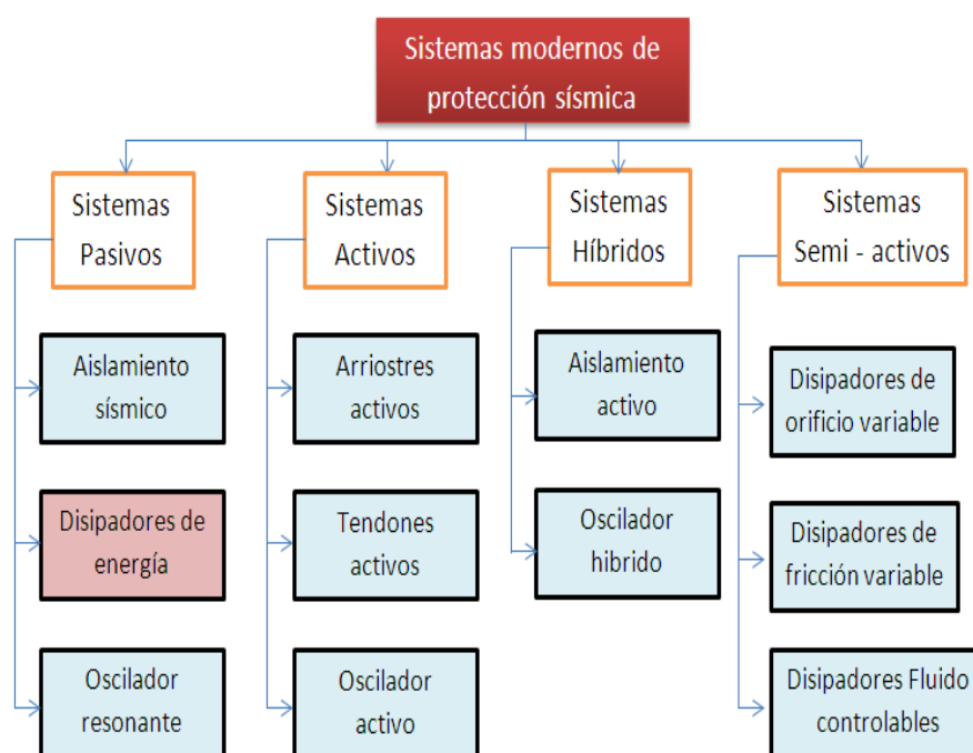
Fig.5 Clasificación de los sistemas de protección sísmica.
