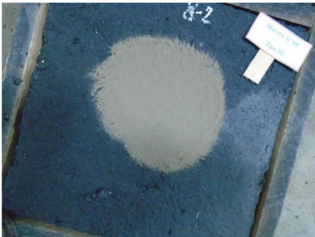
Vista del molde ensayado para agregado TIPO 2 y % de asfalto 11.00%
