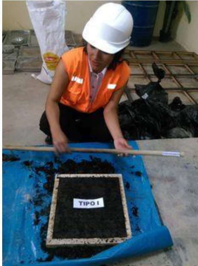
Vista del molde tipo I para un % asfalto de 14.0%
