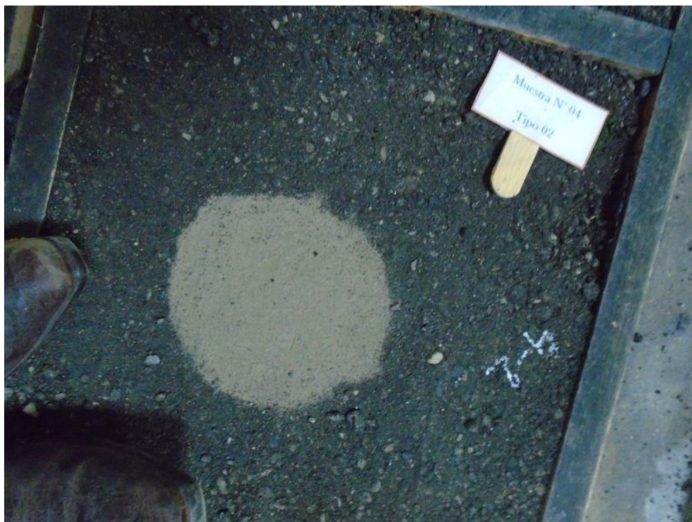
Vista del molde ensayado para agregado TIPO 1 y % de asfalto 4.00%
