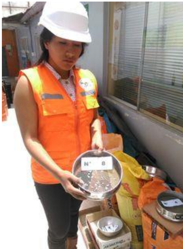
Procesamiento del material Malla N° 8
