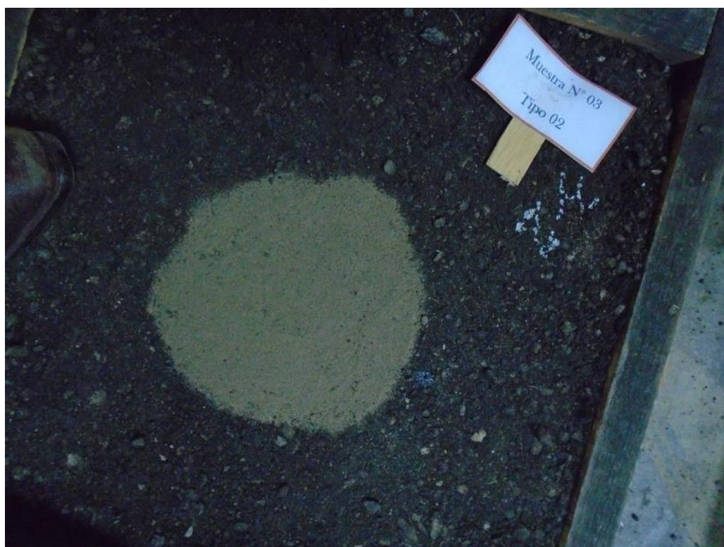
Vista del molde ensayado para agregado TIPO 2 y % de asfalto 8.50%
