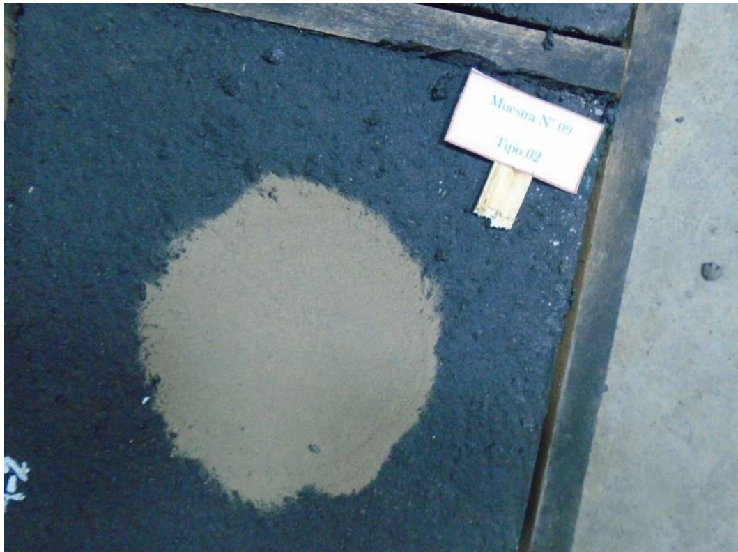
Vista del molde ensayado para agregado TIPO 2 y % de asfalto 11.50%
