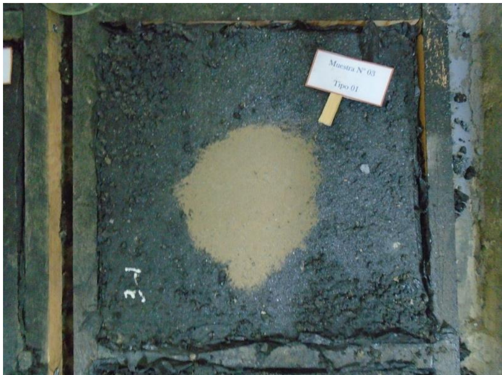
Vista del molde ensayado para agergado TIPO 3 y % de asfalto 1% con Dprom 9.48 cm
