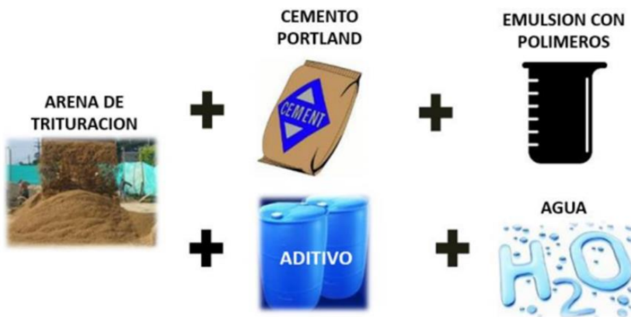
Figura 3: composición de una mezcla de Slurry Seal
