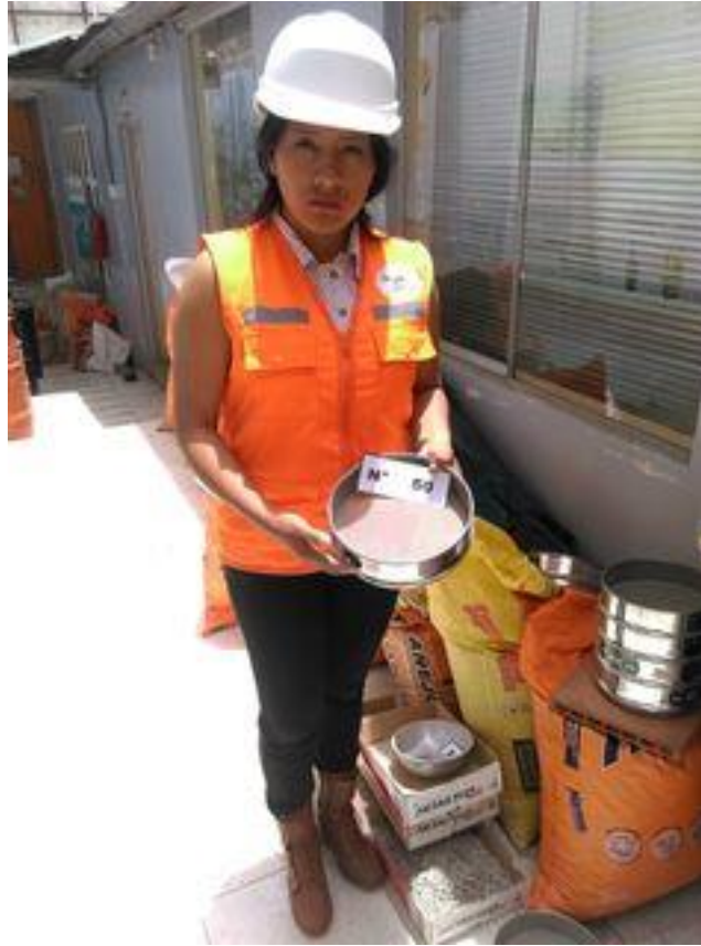
Procesamiento del material Malla N° 50
