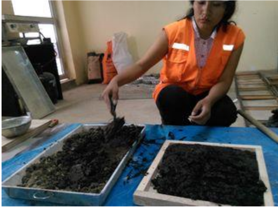
vista de la colocación del slurry seal en los moldes de 30cm x 30 cm
