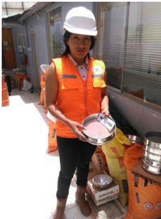
Procesamiento del material Malla N° 100
