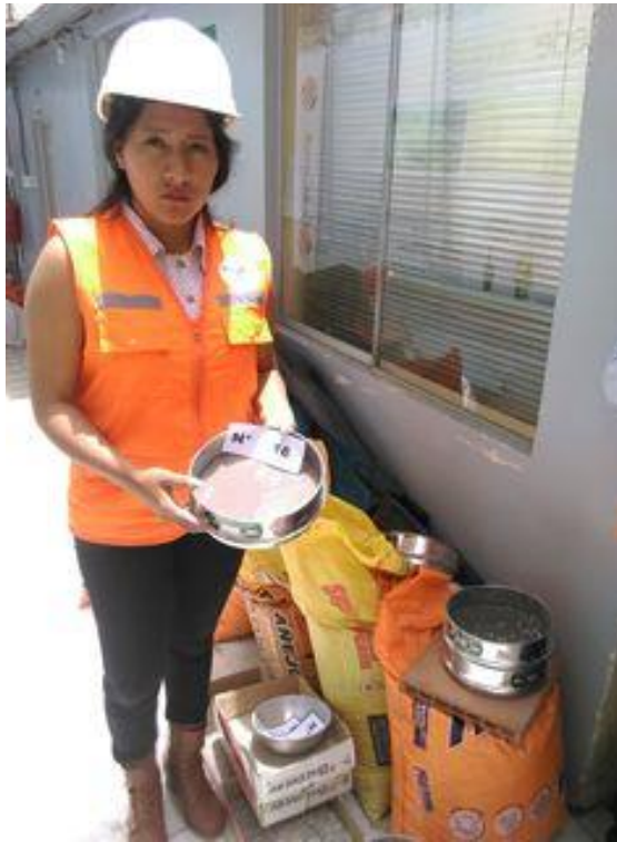
Procesamiento del material Malla N° 16
