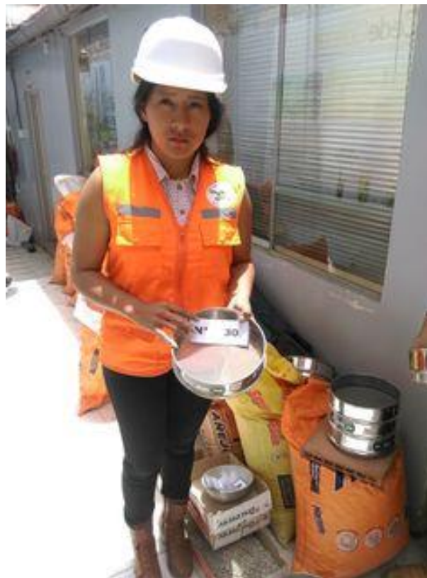
Procesamiento del material Malla N° 30
