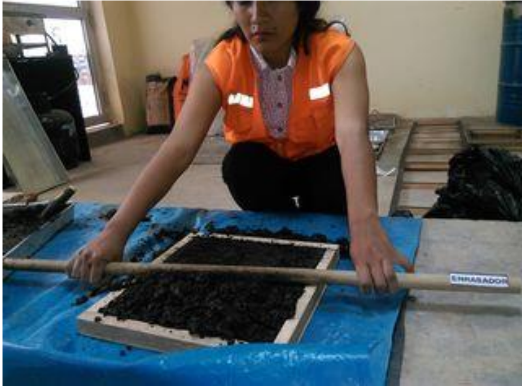
Vista del enrasado del molde tipo 3 con 12% de asfalto en frío
