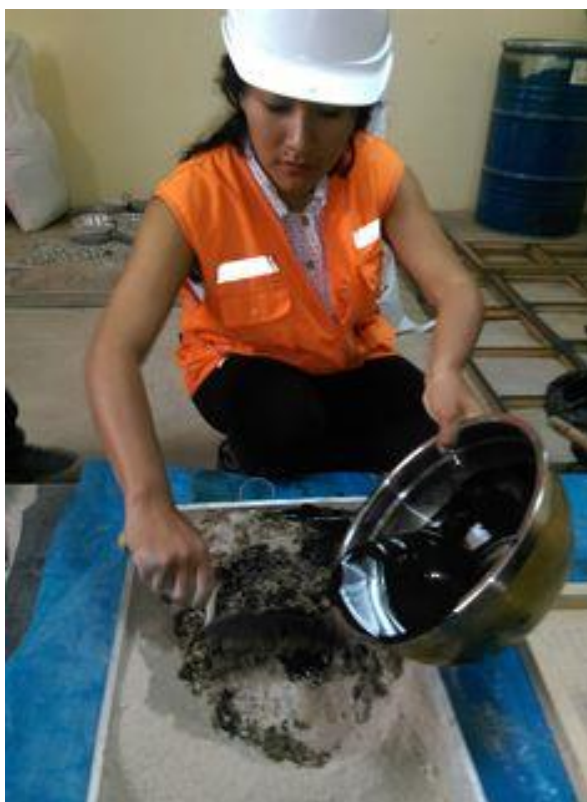
Figura 33: Mezcla de los componentes de Slurry Seal
