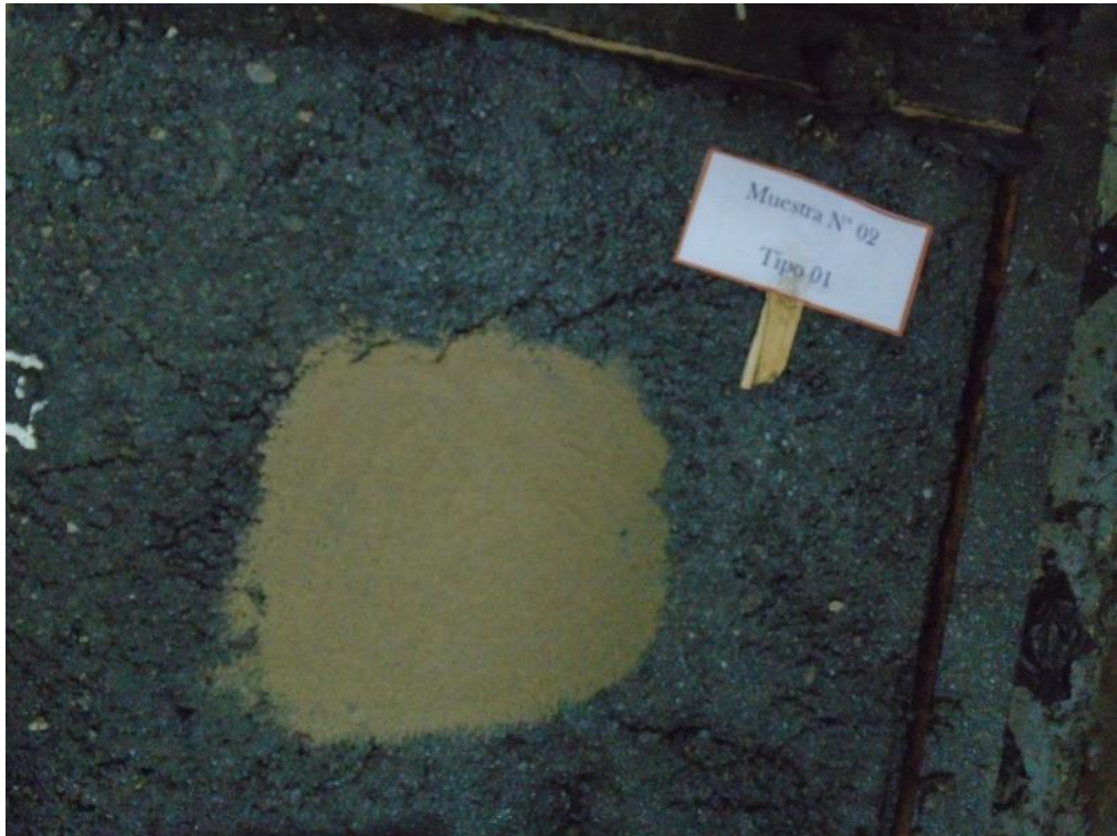
Vista del molde ensayado para agregado TIPO 1 y % de asfalto 5%
