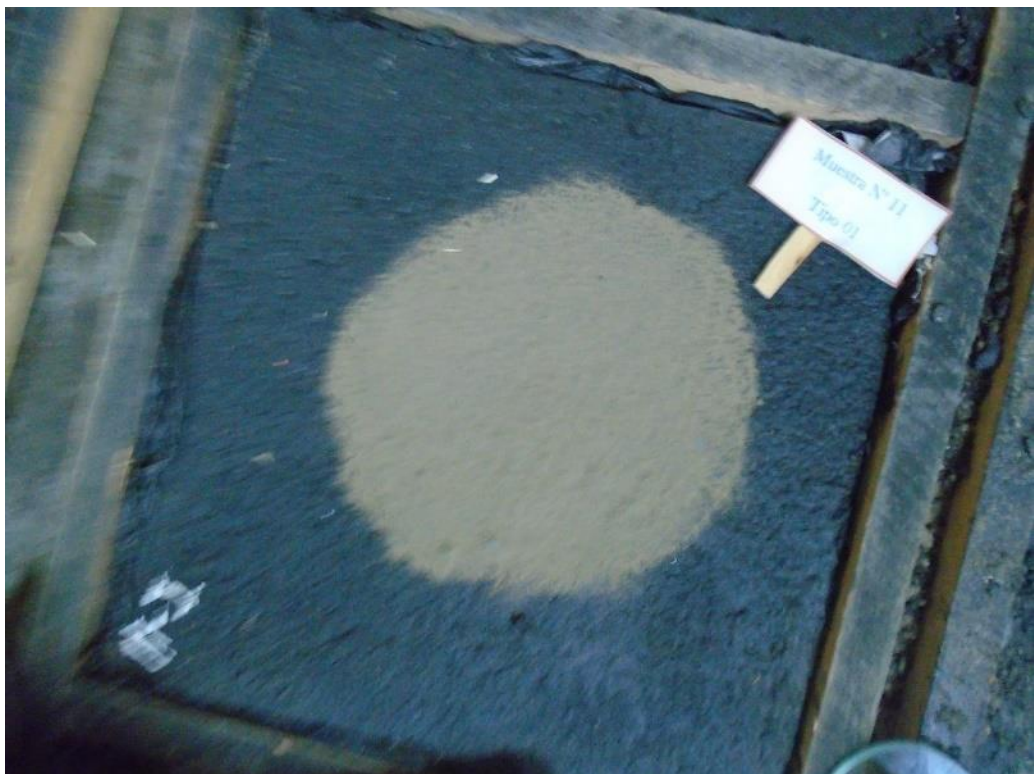
Vista del molde ensayado para agregado TIPO 1 y % de asfalto 15.0%
