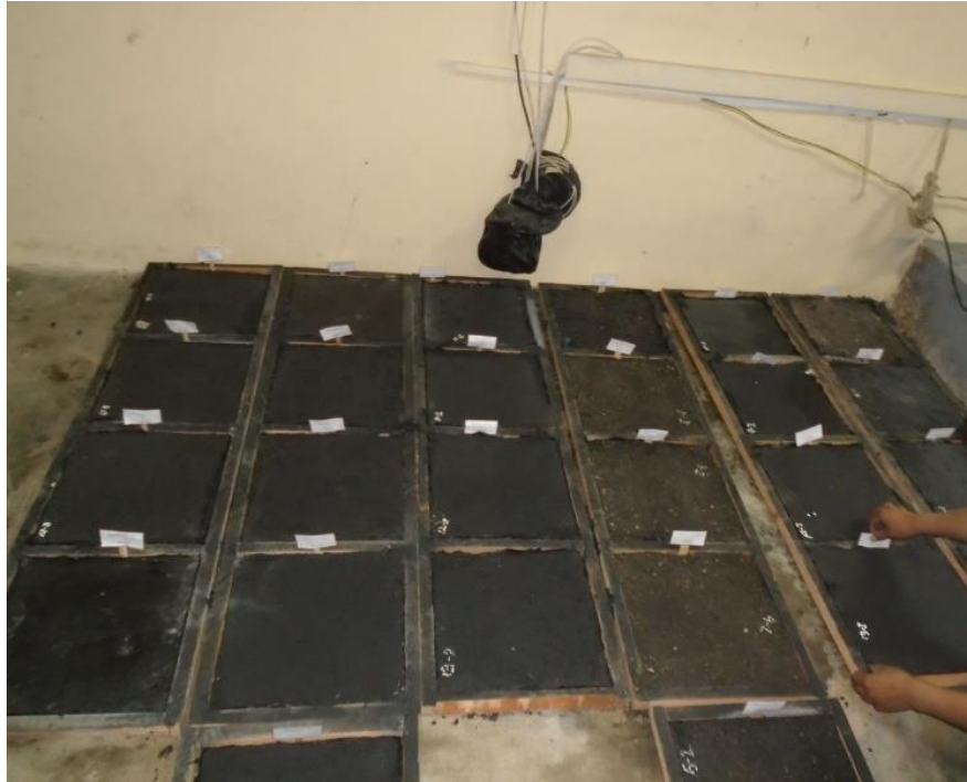
Vista de los moldes para diferentes tipos de agregado y diferente % de emulsión asfáltica.
