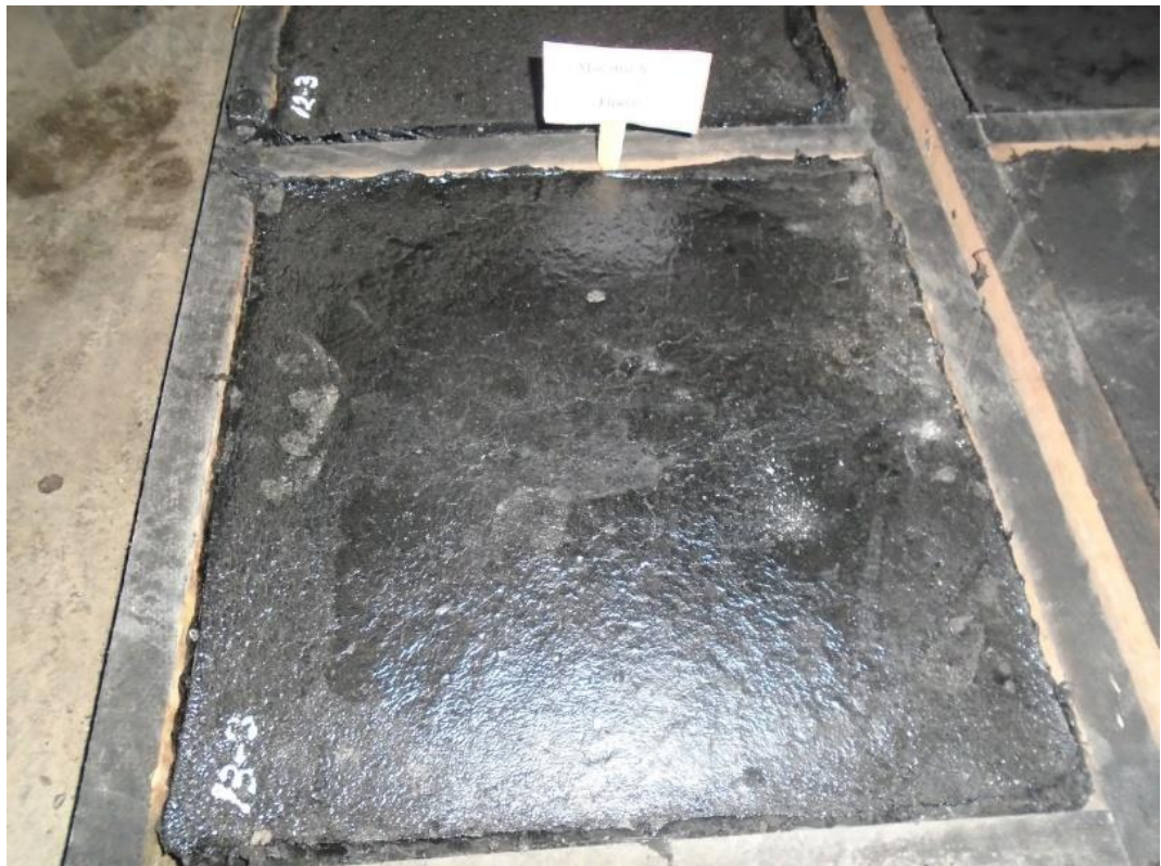
Vista del molde de 30cm x 30cm de slurry seal seco
