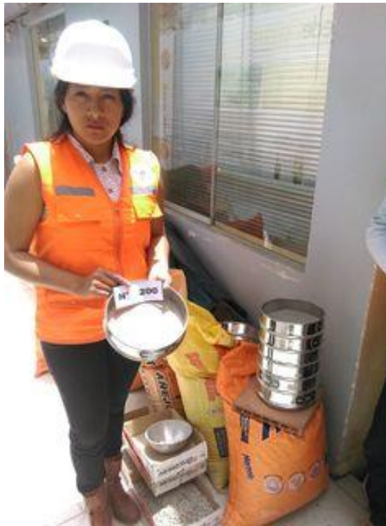
Procesamiento del material Malla N° 200
