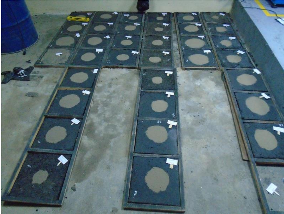
Vista de los moldes para diferentes tipos de agregado y diferente % de emulsión asfáltica ensayadas con el círculo de arena
