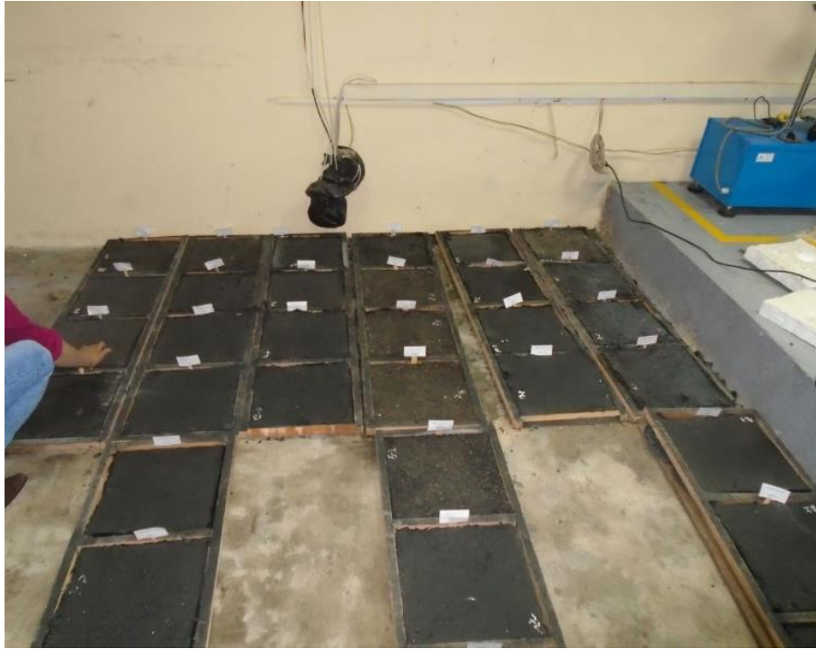
Vista de los moldes para diferentes tipos de agregado y diferente % de emulsión asfáltica.
