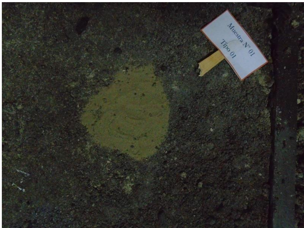
Vista del molde ensayado para agregado TIPO 1 y % de asfalto 4%
