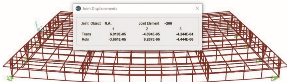
Figura 55. Visualización de la deflexión por carga viva
