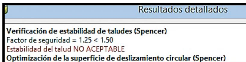
Figura 41. Programa GEO5, Resultado detallados del tercer talud inestable.
