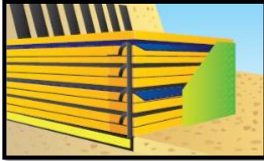
Figura 49. Instalación de los geotextiles y el geodren planar
