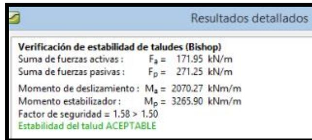
Figura 43. Programa GEO5, Resultado detallados del tercer talud inestable.
