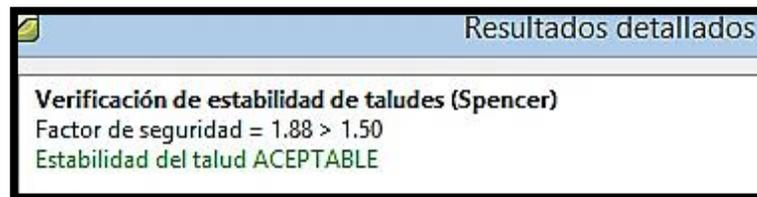
Figura 46. Programa GEO5, Resultado detallados del tercer talud inestable.
