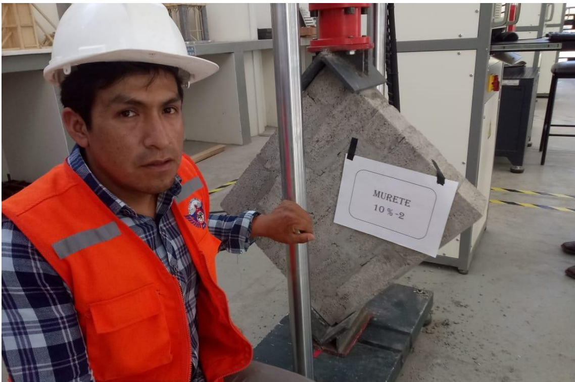
Fotografía 53. Ensayo de resistencia a compresión diagonal en murete con 10 %
