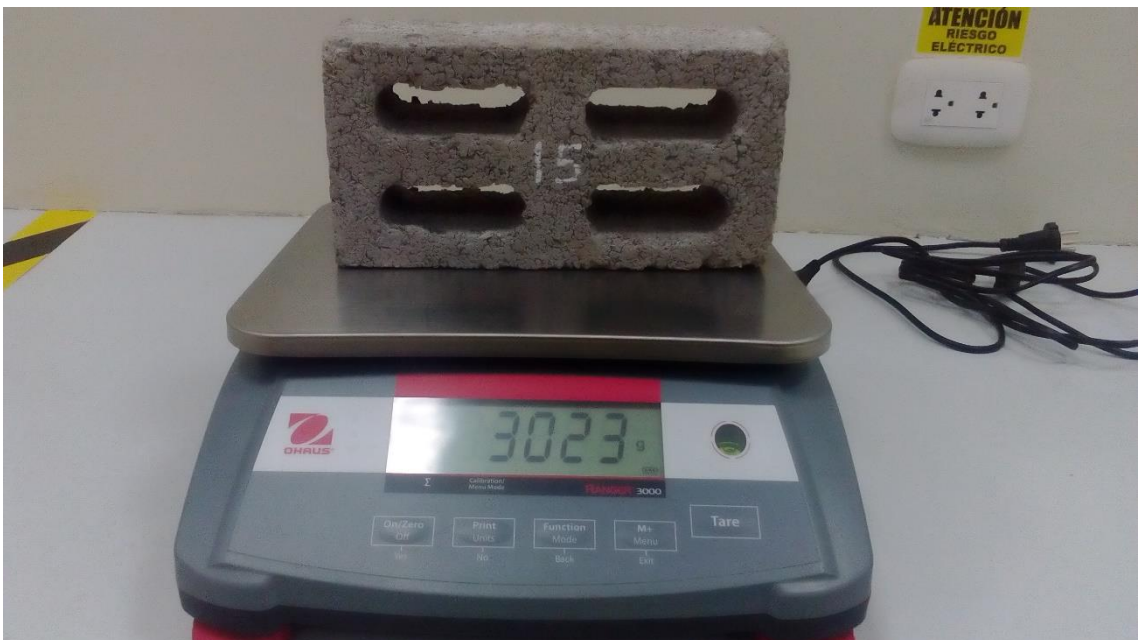
Fotografía 20. Peso del ladrillo artesanal 15 % de PET 15 % porcelanato
