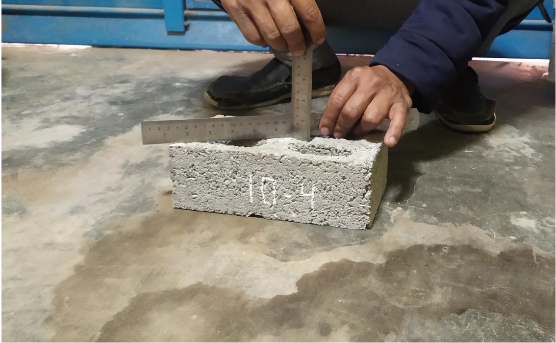
Fotografía 15. Ensayo de alabeo ladrillo con 10 % PET-porcelanato
