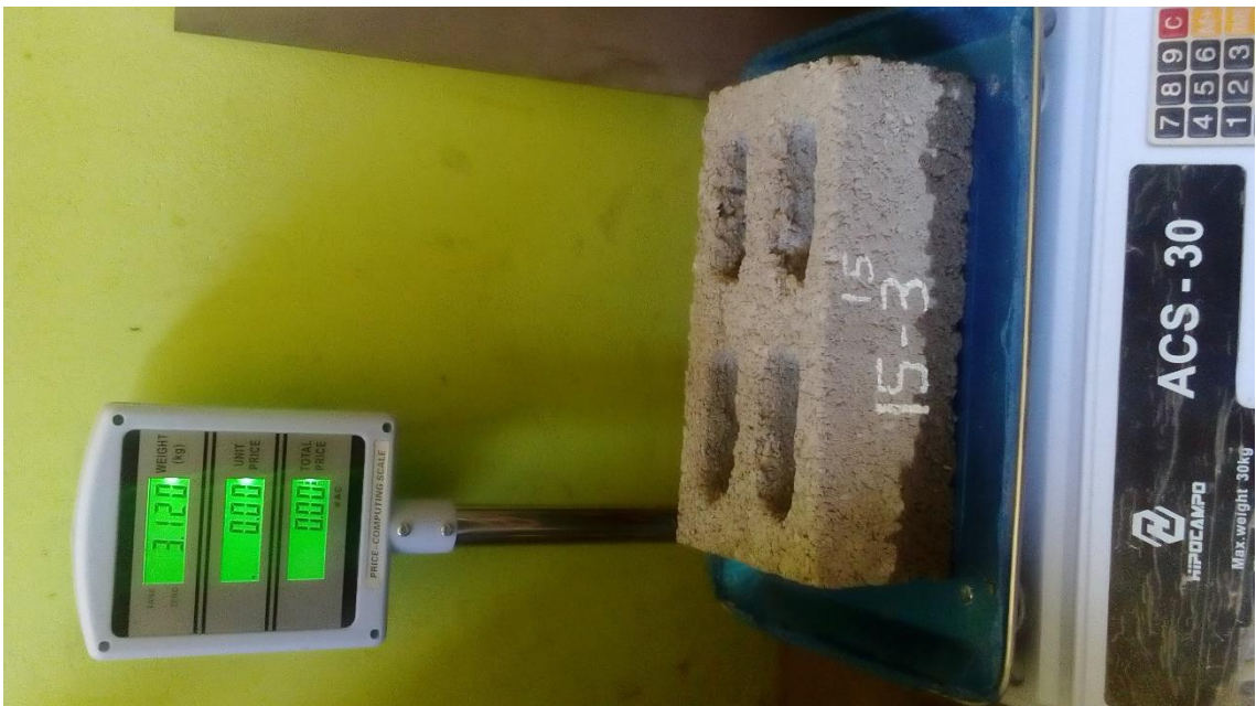
Fotografía 30. Peso después del ensayo de succión al 15 % PET 15 % porcelanato
