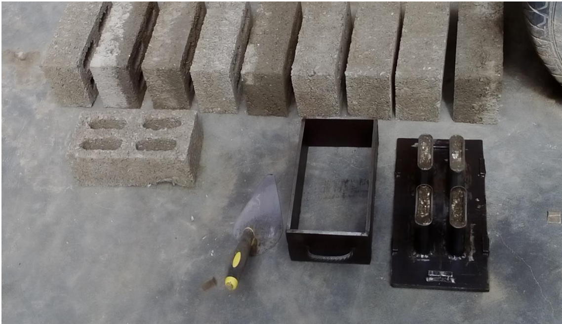
Fotografía 11. Molde y primeros ladrillos PET porcelanato
