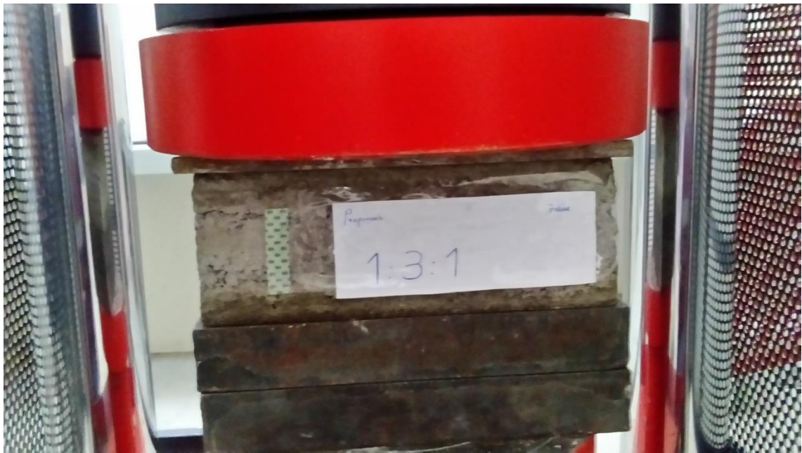
Fotografía 37. Ensayo de resistencia a compresión f'_b para muestra de dosificación.
