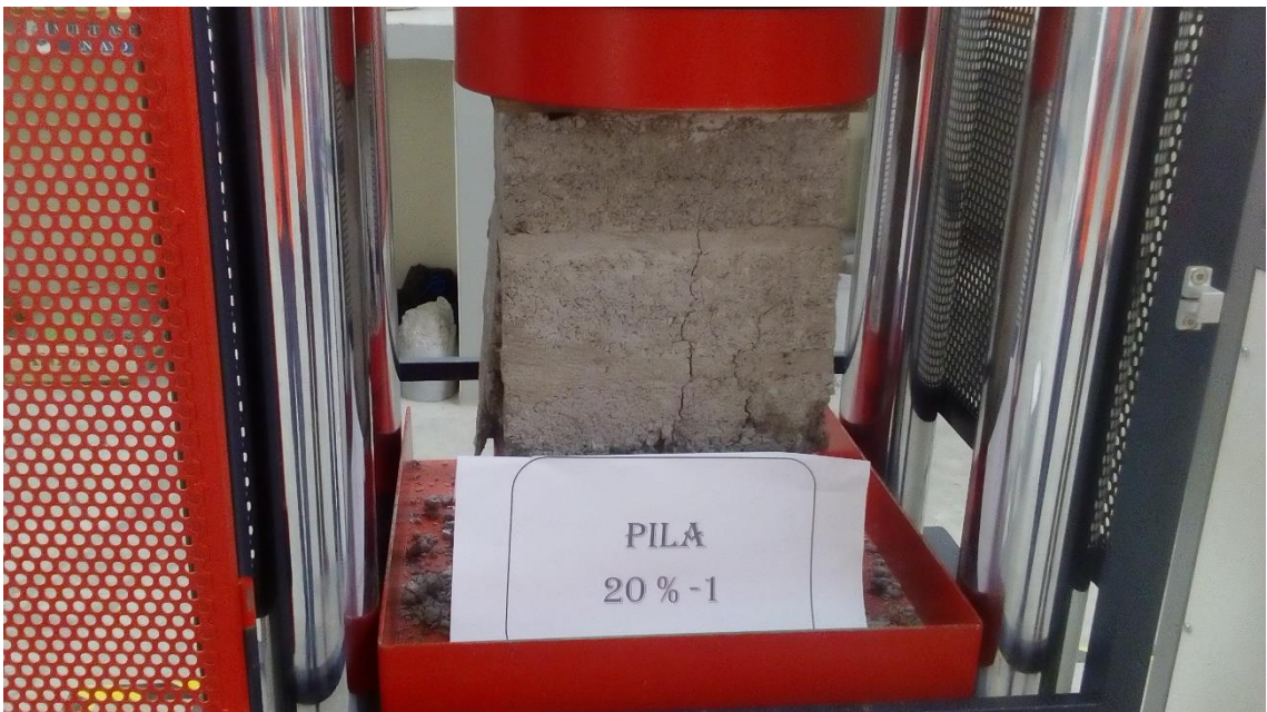
Fotografía 44. Ensayo a compresión axial en pilas al 20 % falla por aplastamiento
