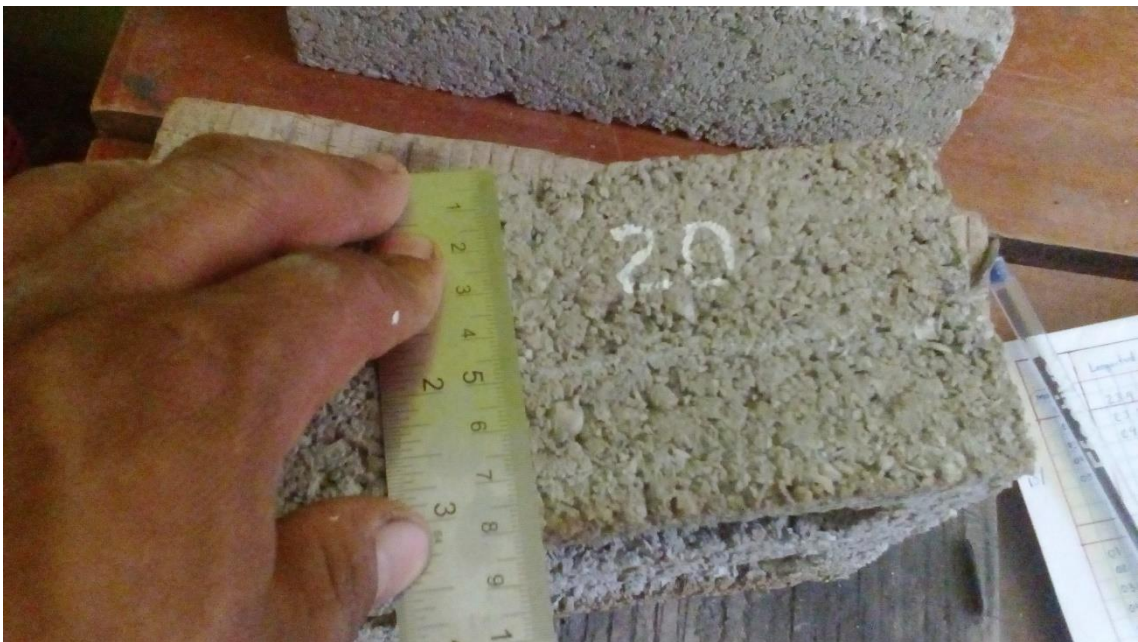
Fotografía 18. Ensayo de variación dimensional 20% PET 20 % porcelanato
