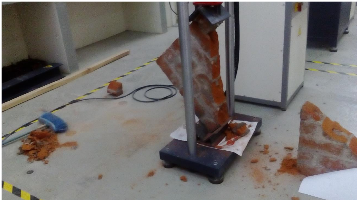
Fotografía 51. Ensayo compresión diagonal murete falla por grieta
