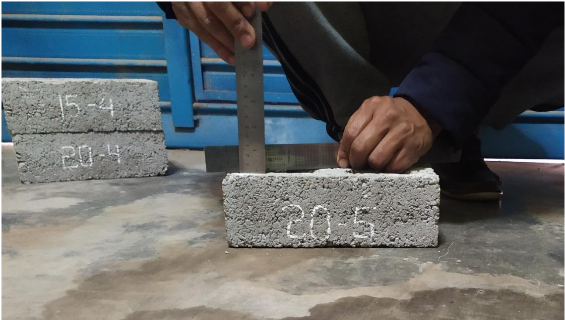
Fotografía 16. Ensayo de alabeo ladrillo con 20 % PET-porcelanato
