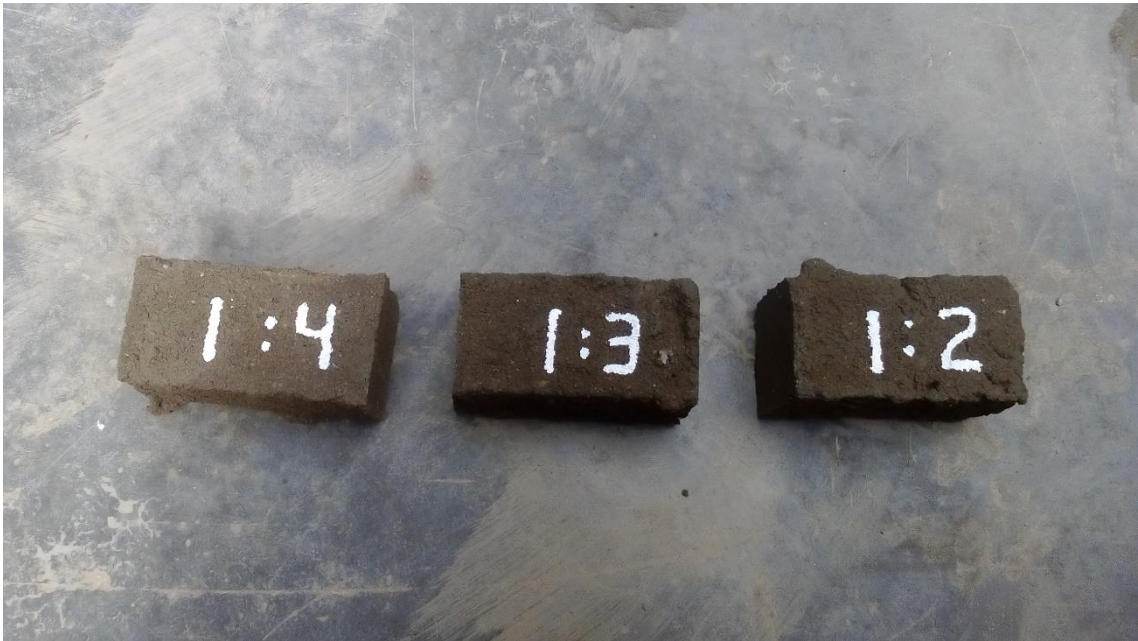
Fotografía 45. Probetas de mortero
