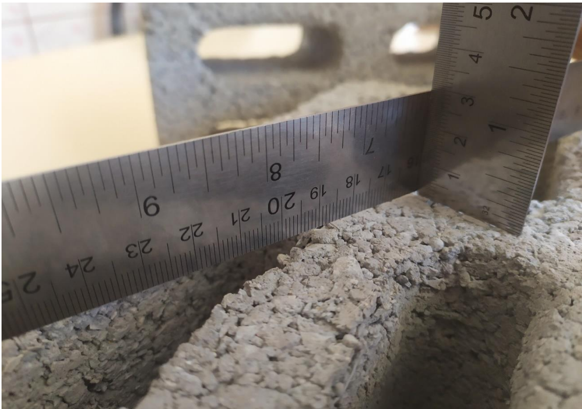
Fotografía 14. Ensayo de alabeo ladrillo con 15 % PET-porcelanato
