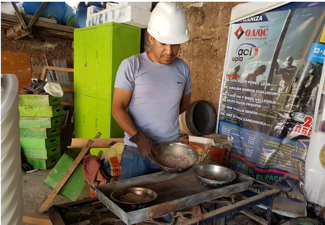
Fotografía 5. Ensayo de humedad a los agregados
