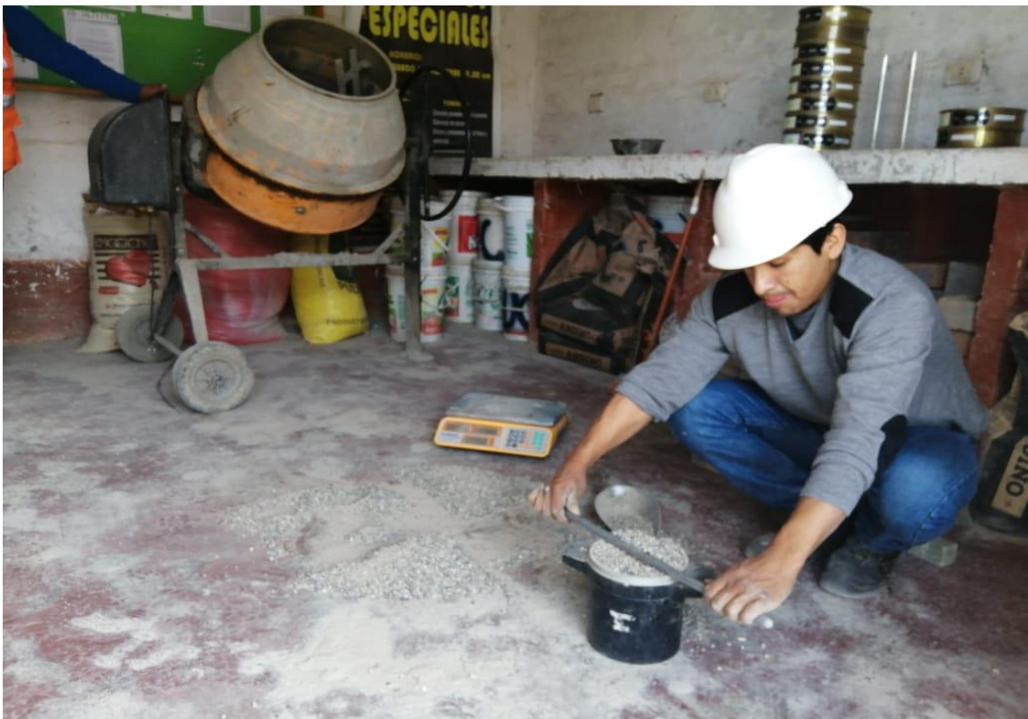
Fotografía 3 Ensayo peso unitario compactado del agregado grueso
