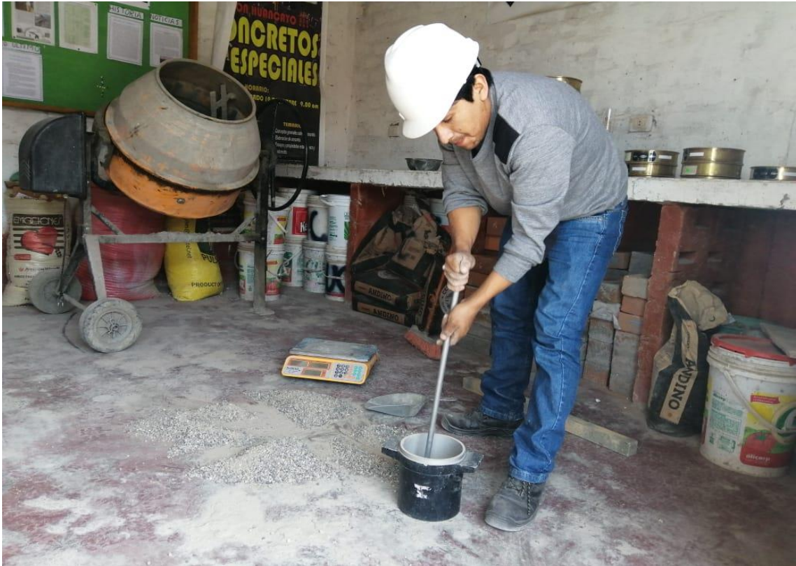
Fotografía 2. Ensayo peso unitario compactado del agregado grueso
