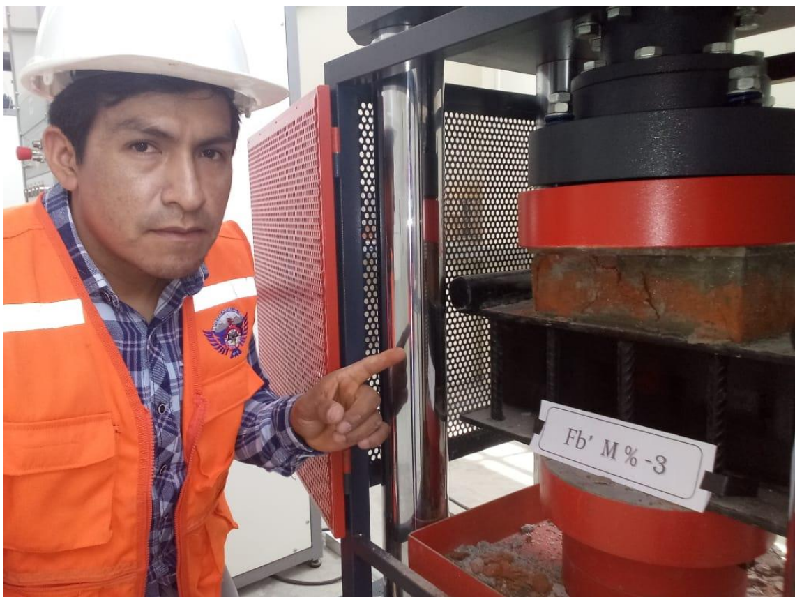
Fotografía 36. Ensayo a compresión ladrillo artesanal
