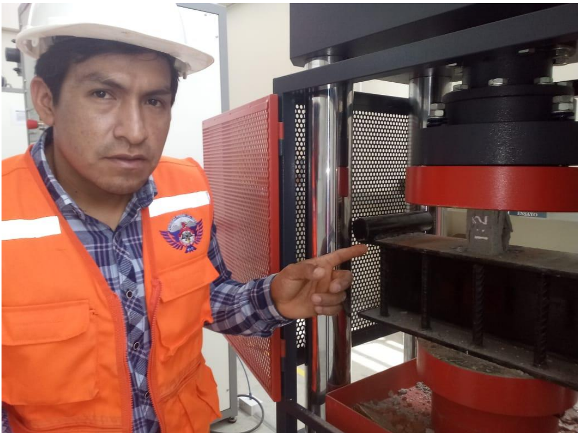
Fotografía 46. Ensayo a compresión mortero.
