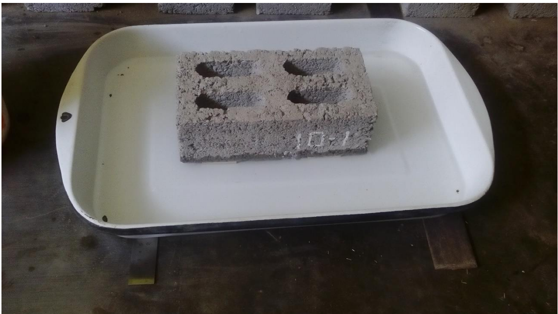
Fotografía 28. Ensayo de succión al 10 % PET 10 % porcelanato
