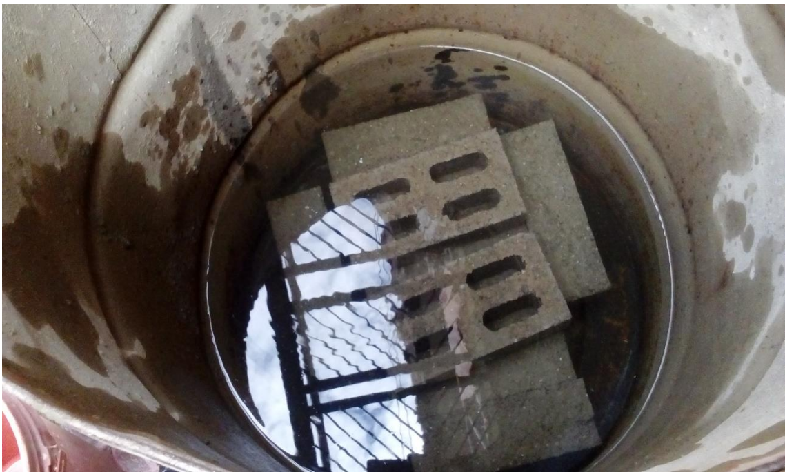
Fotografía 12. Curado de los ladrillos PET porcelanato
