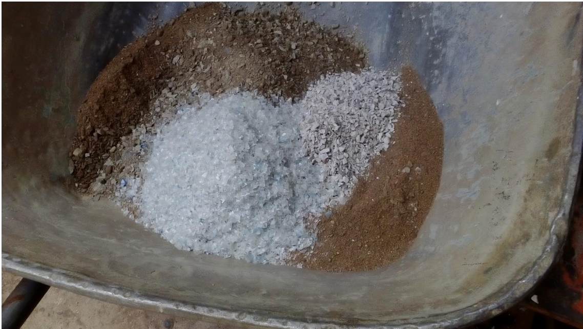
Fotografía 9. Mezclado de agregados más PET y porcelanato triturado
