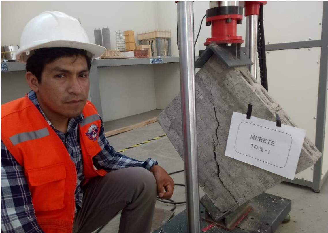
Fotografía 54. Ensayo de resistencia a compresión diagonal en murete con 10 % falla por grieta
