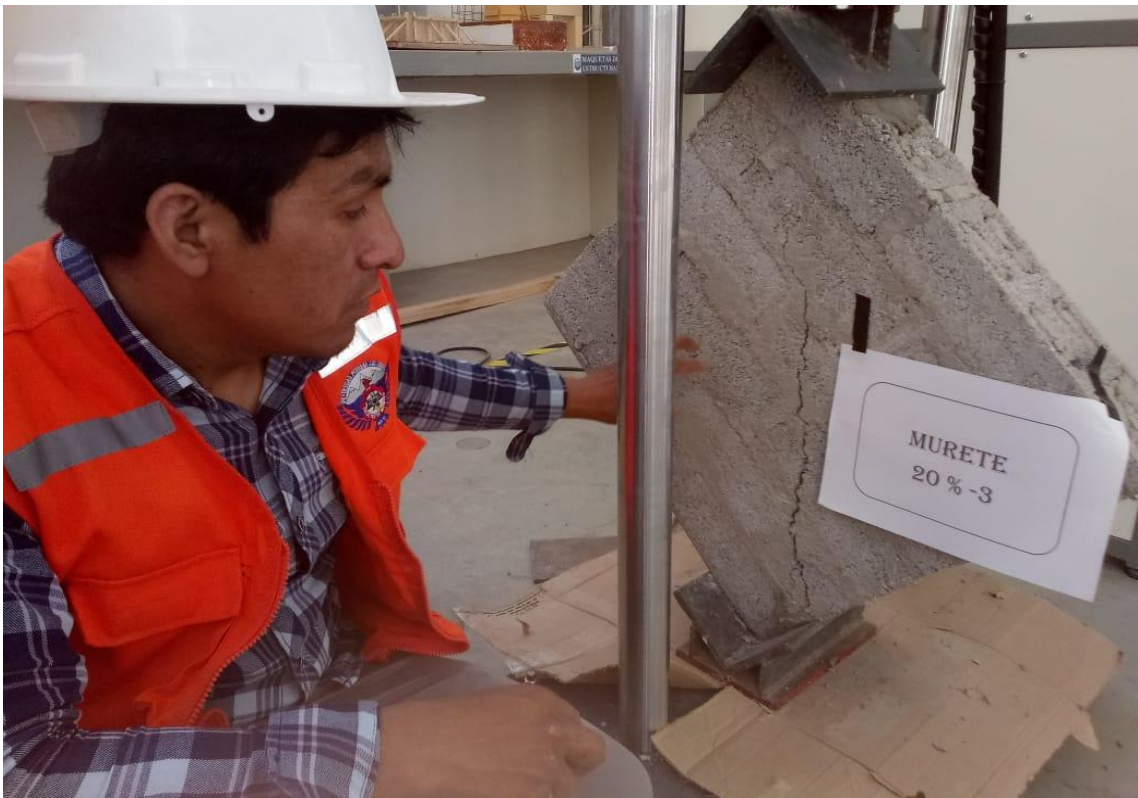
Fotografía 55. Ensayo de resistencia a compresión diagonal en murete con 20 % falla por grieta
