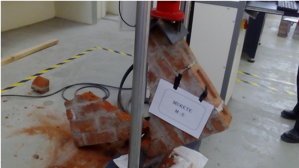
Fotografía 52. Ensayo compresión diagonal murete, falla por grieta
