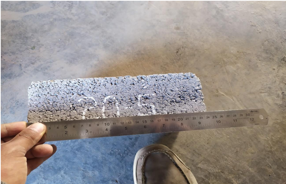
Fotografía 19. Ensayo de variación dimensional 20% PET 20 % porcelanato
