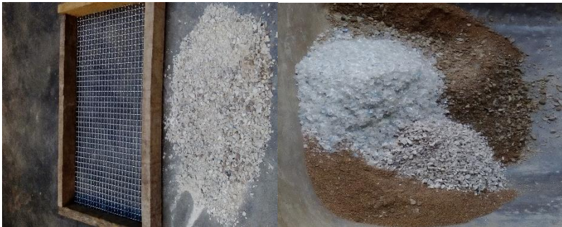
Fotografía 1. Ensayo peso unitario compactado del agregado grueso
