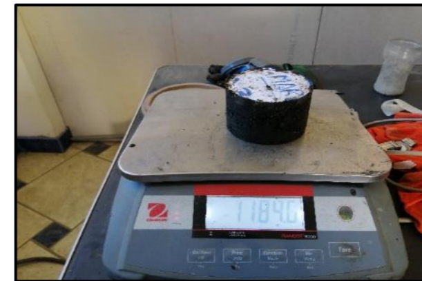
Fotografía 12. Se determina la masa de cada espécimen MAC-convencional y MAC-modificado con PET.
