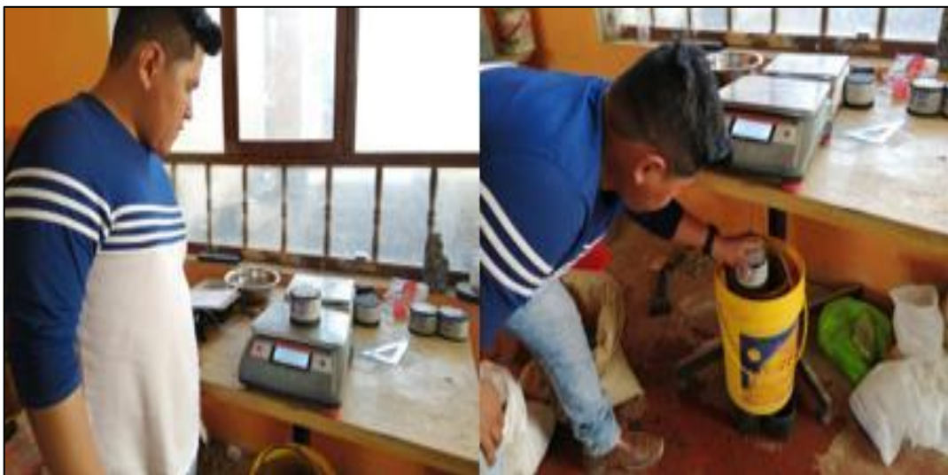
Fotografía 31. Peso específico de cada cuerpo de prueba, en agua temperada a 23 °C.
