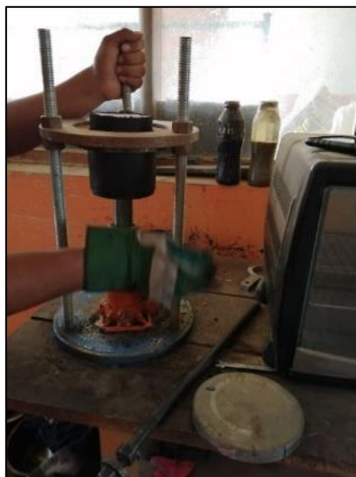
Fotografía 28. Proceso para desmoldar los especímenes con el extractor.
