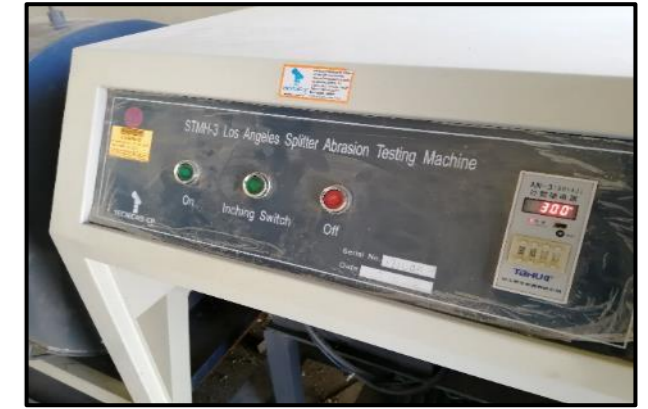
Fotografía 14. Se hace girar el tambor a (30 a 33 rpm), durante 300 vueltas.
