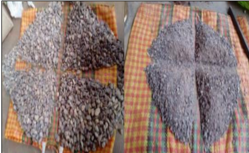
Fotografía 21. Cuarteo de muestra del agregado grueso y agregado fino para la granulometría.
