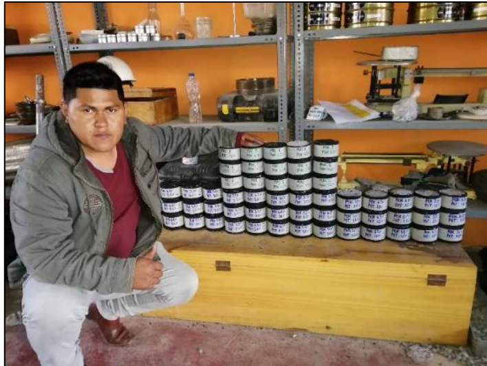
Fotografía 30. Especímenes de muestras asfálticas convencional y modificado con PET.
