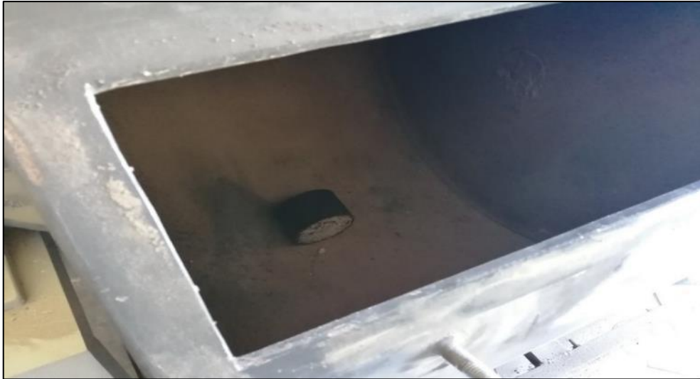
Fotografía 38. Probeta en el bombo de la máquina de los Ángeles, se gira el tambor a (30 a 33 rpm), durante 300 vueltas.
