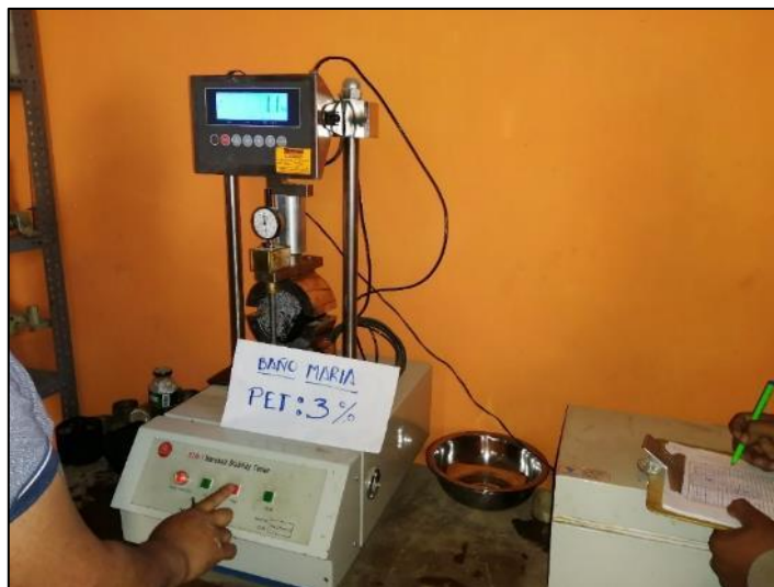
Fotografía 33. Rotura de briquetas en la presa Marshall, para terminar la estabilidad y deformación mediante el flujo.
