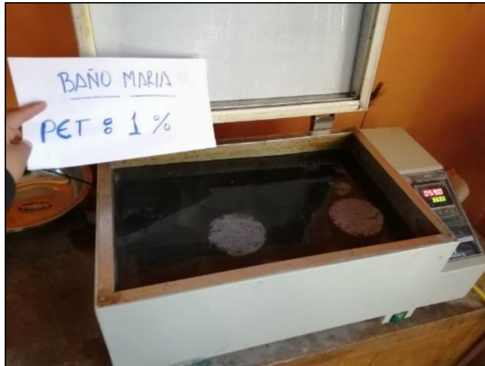
Fotografía 32. Baño María de briquetas Marshall a 60 °C
