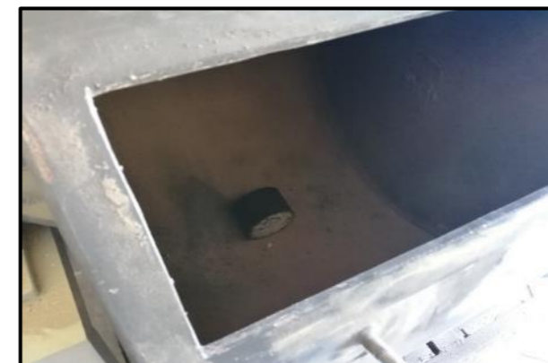
Fotografía 13. Se introduce una probeta en el bombo de la máquina de Los Ángeles y se ensayan de uno a uno.
