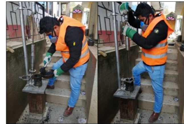
Fotografía 4. Llenado de molde y Compactación mecánica manual de las briquetas Marshall
