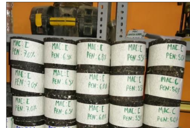
Fotografía 5. Obtención de briquetas Marshall convencional.
