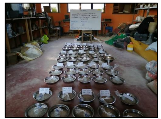
Fotografía 8. Dosificación de agregados pétreos y escamas de PET según porcentajes.
