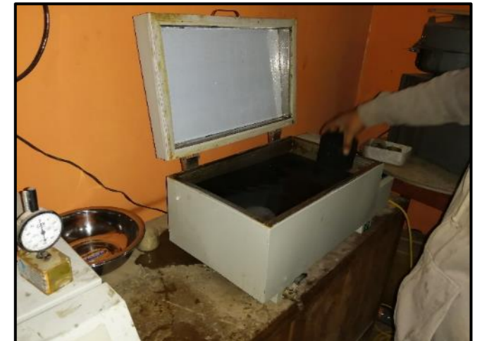
Fotografía 7. Baño María de briquetas Marshall a 60°C, para roturas de probetas.
