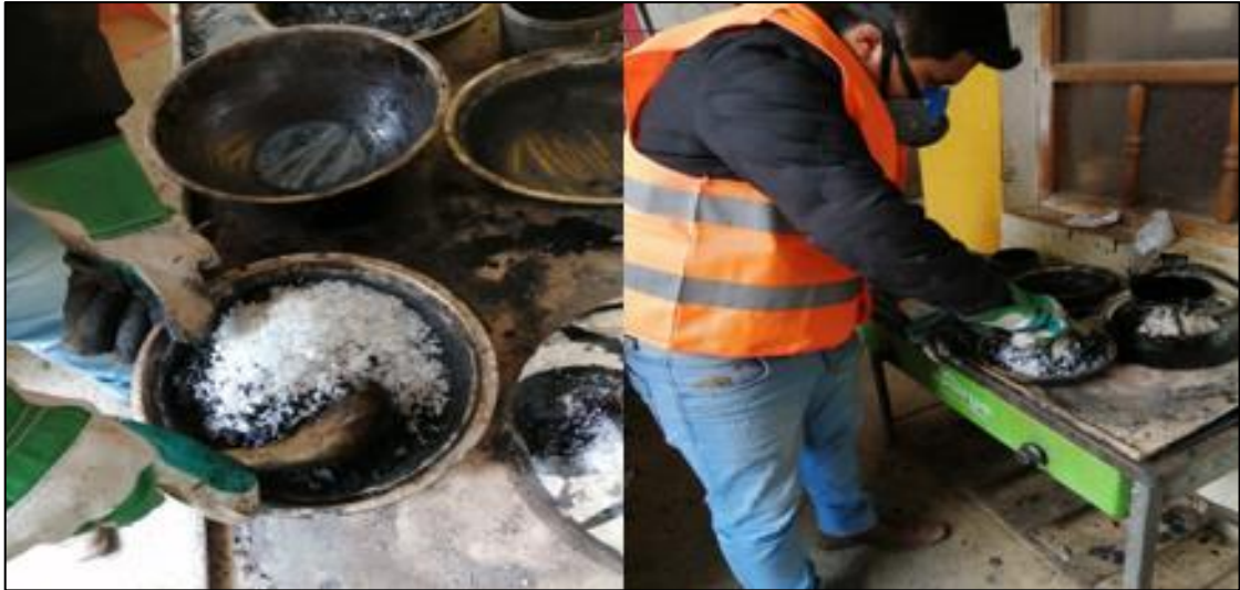
Fotografía 26. Colocación y mezclado de escamas de PET como parcial de agregado fino.
