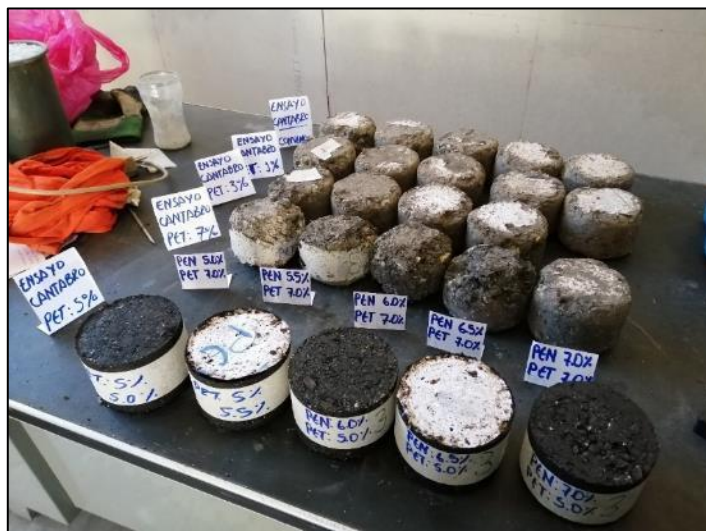
Fotografía 40. Muestras ensayadas en la máquina de abrasión los Ángeles
