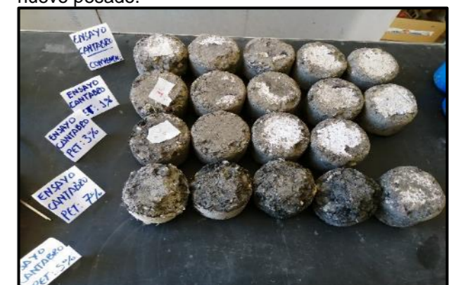
Fotografía 16. Especímen MAC-convencional y MAC-modificado con PET, después de ser ensayados.
