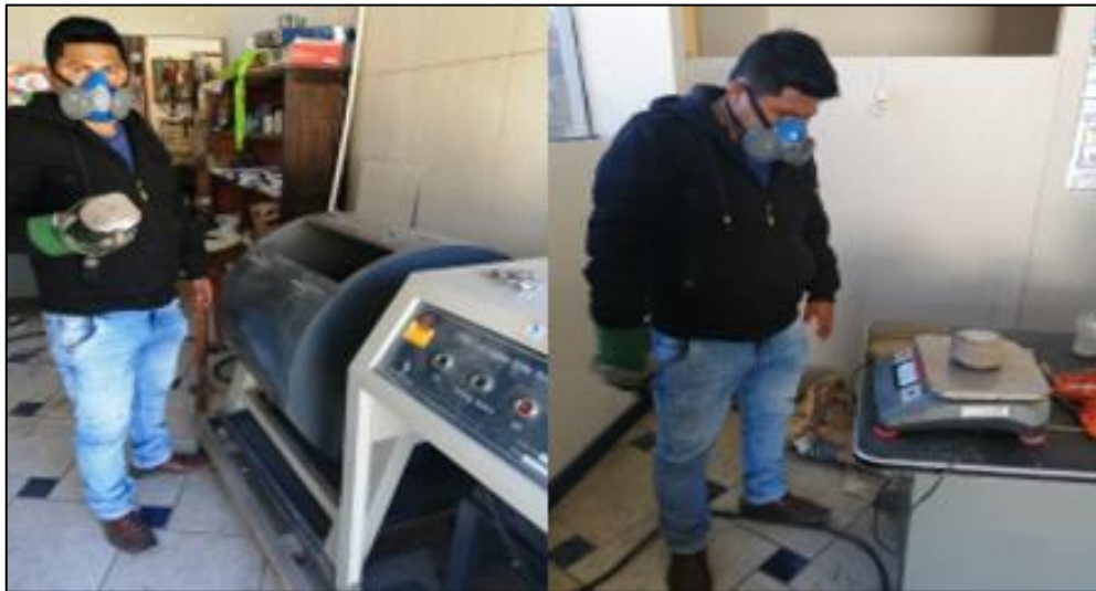
Fotografía 39. Extracción del espécimen y peso final para verificar el desgaste.
