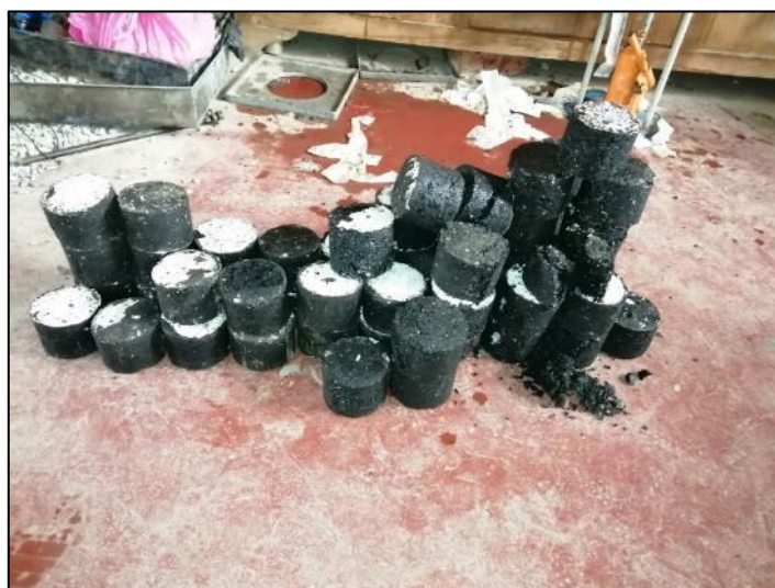
Fotografía 34. Muestras ensayadas en la presa Marshall.
