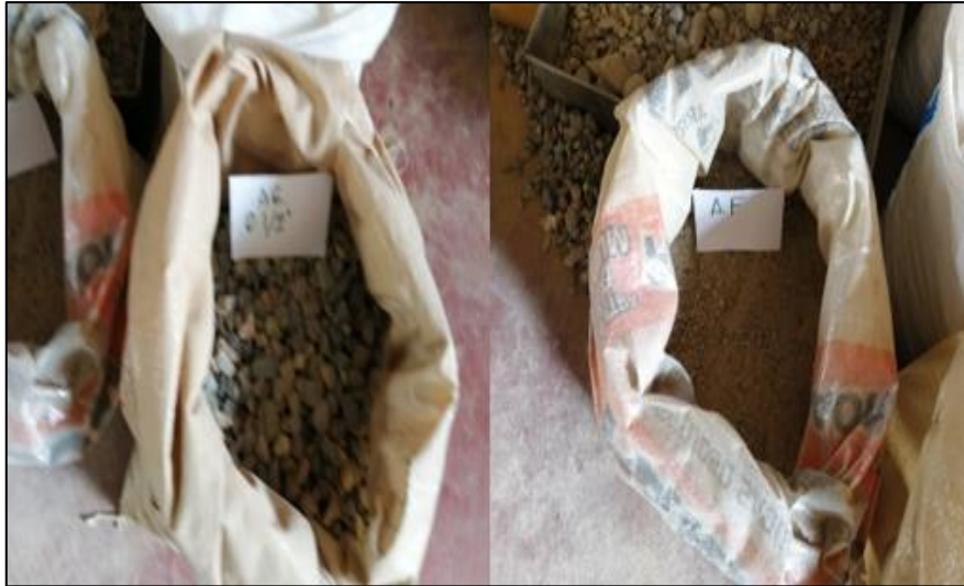
Fotografía 20. Piedra chancada de 1/2" (AG) - arena chancada (AF).
