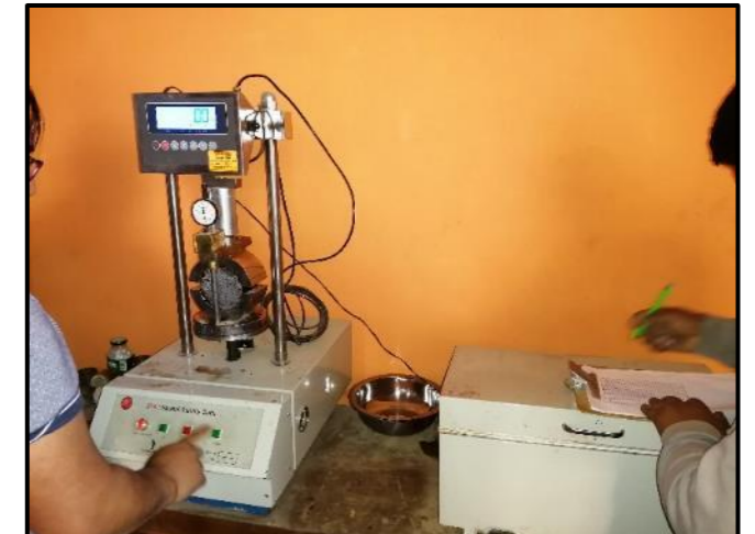
Fotografía 11. Rotura de briquetas de MAC convencional en la prensa Marshall para determinar la Estabilidad y Flujo.
