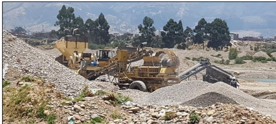
Figura 14. Producción de piedra chancada de 1/2" y arena chancada.
