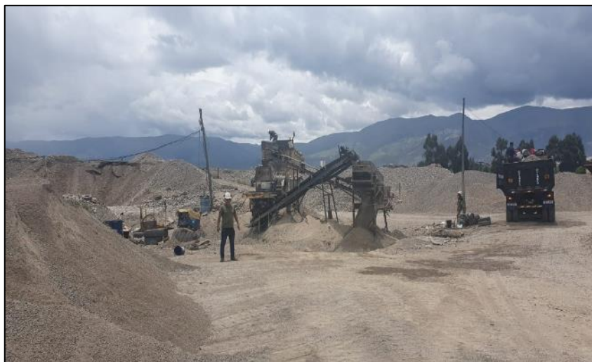
Fotografía 19. Producción de piedra chancada de 1/2" y arena chancada - Planta trituradora agregados Tres de Diciembre – Chupaca.
