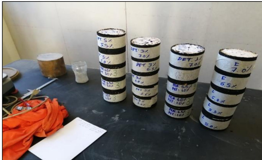
Fotografía 36. Briquetas para el ensayo de Cántabro.
