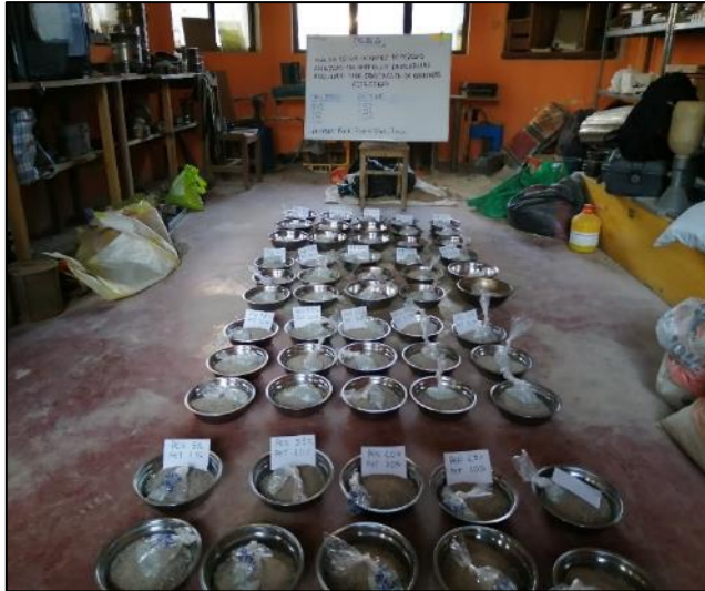
Fotografía 23. Dosificación de agregados y plástico PET en 1 %, 3 %, 5 % y 7 %.
