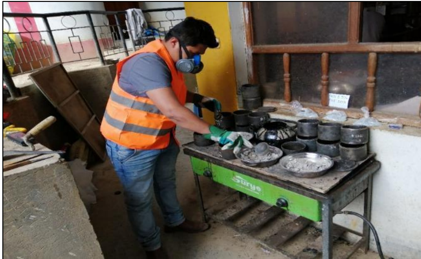
Fotografía 24. Proceso de calentado de agregados, PEN 85/10 y moldes Marshall.
