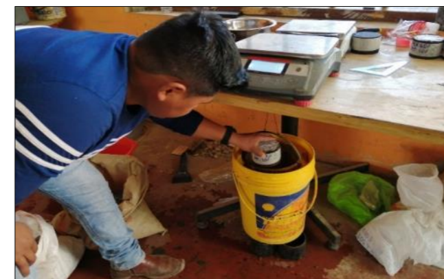
Fotografía 6. Determinación del peso específico de briquetas Marshall convencional.
