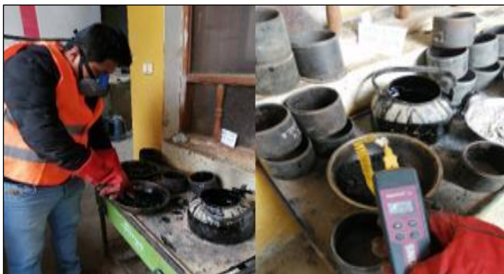
Fotografía 25. Mezclado del cemento asfáltico con los agregados y toma de temperatura.
