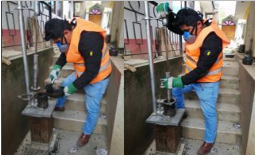
Fotografía 27. Llenado de molde y compactación mecánica manual de las briquetas Marshall.
