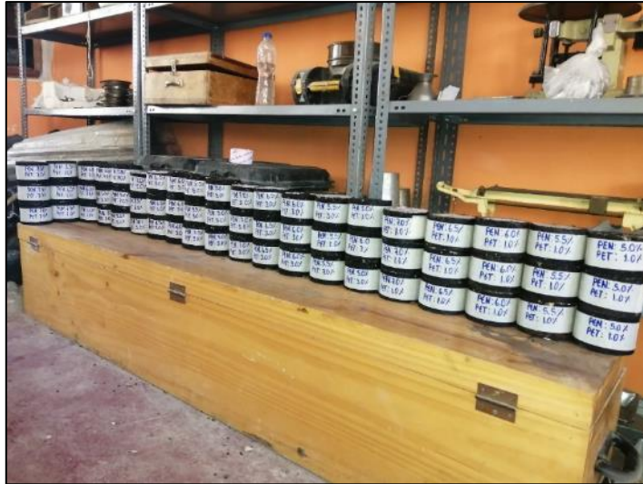
Fotografía 29. Espécimen de mezclas asfálticas incorporadas con PET 1 %, 3 %, 5 % y 7 %.
