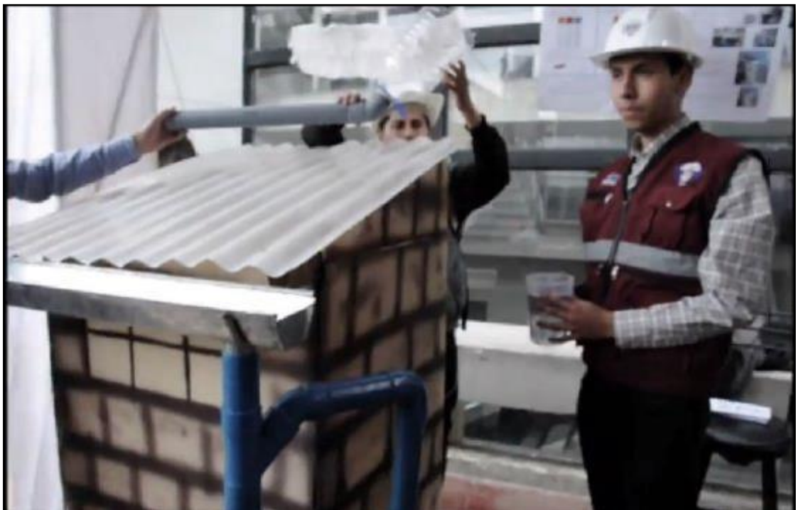
Fotografía N.º 9: Demostración del Sistema de Captación de Agua Pluvial adaptado a viviendas rurales.
