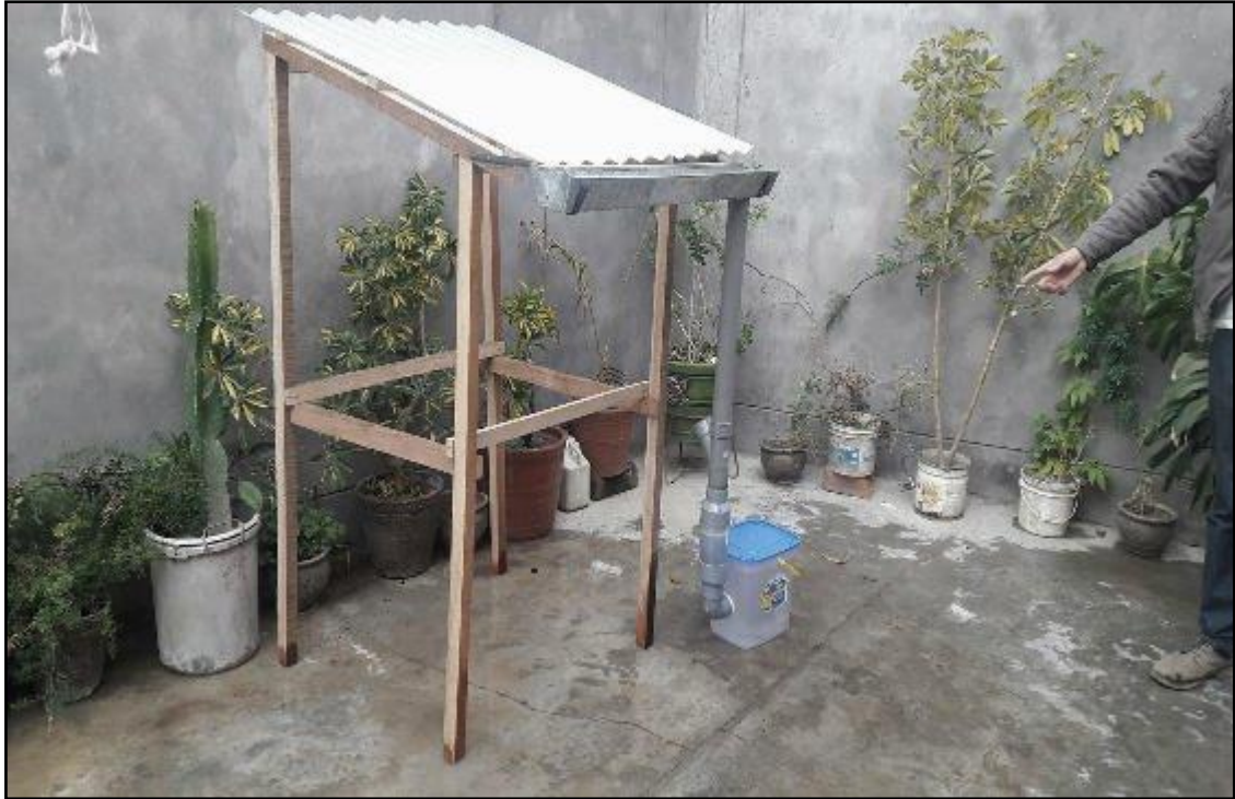
Fotografía N.º 3: Primer Modelo Realizado como Interceptor de Primeras Aguas elaborado para la presentación en la Feria de Talleres Técnico FI-UPLA 2017.
