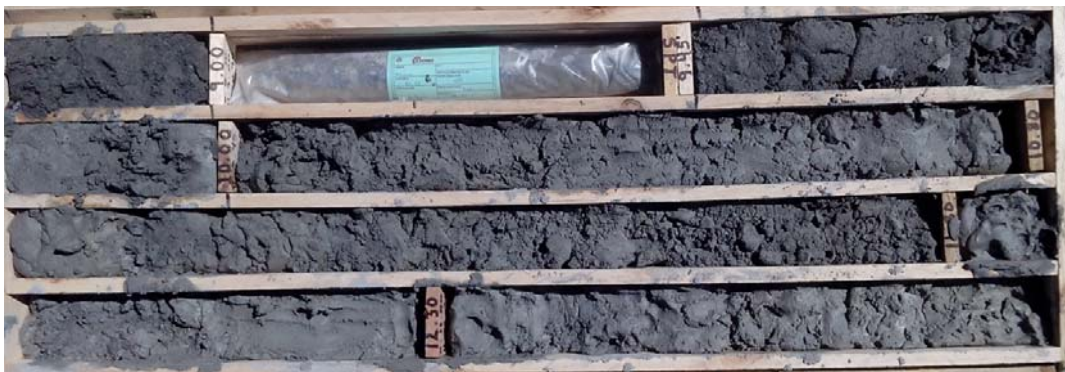
Fotografía 30 – Vista de la Caja de Perforación P-01 del Tramo 8.80 a 12.80 m.
