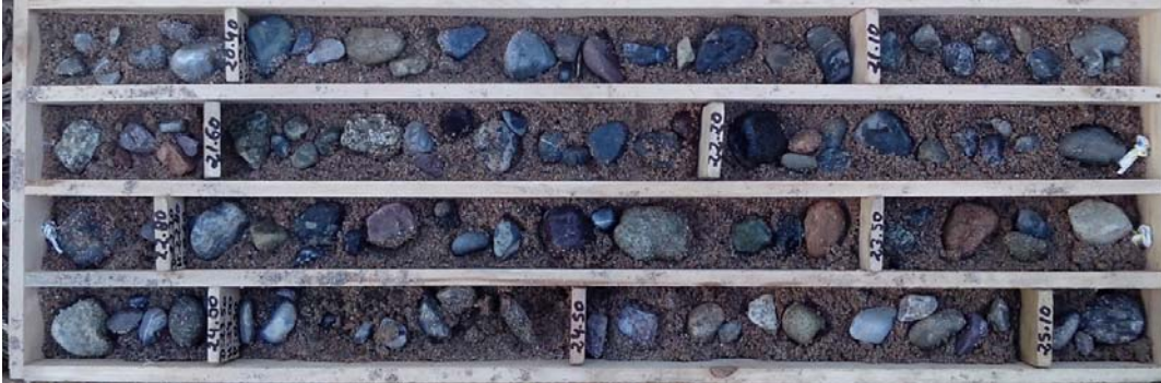
Fotografía 42 – Vista de la Caja de Perforación P-02 del Tramo 20.00 a 25.20 m.
