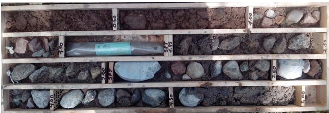
Fotografía 38 – Vista de la Caja de Perforación P-02 del Tramo 0.00 a 5.00 m.
