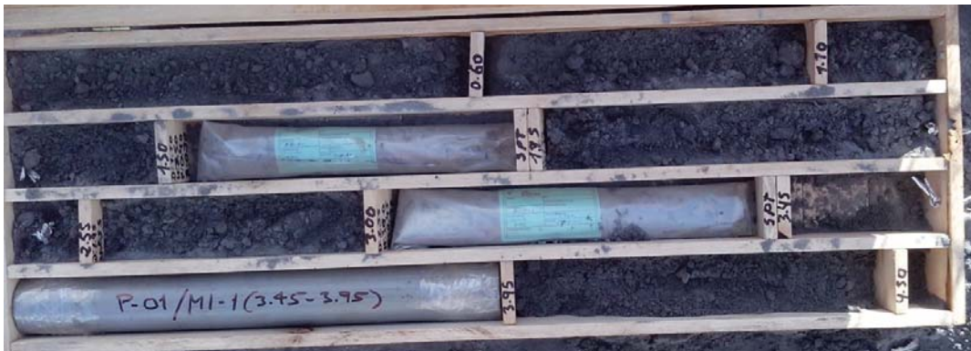
Fotografía 28 – Vista de la Caja de Perforación P-01 del Tramo 0.00 a 3.90 m.
