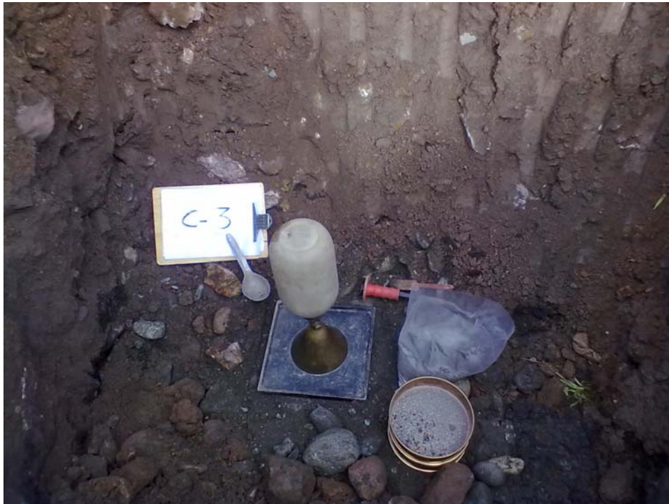
Fotografía 14 – Vista de ensayo de densidad in situ en la calicata C-03.
