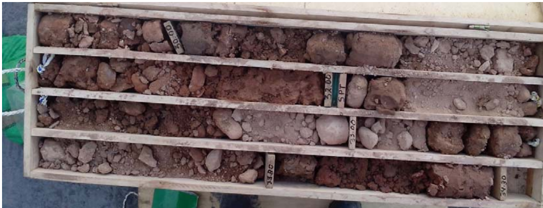
Fotografía 35 – Vista de la Caja de Perforación P-01 del Tramo 29.60 a 34.30 m.
