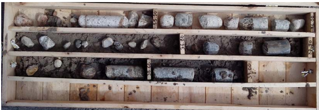
Fotografía 36 – Vista de la Caja de Perforación P-01 del Tramo 34.30 a 39.00 m.
