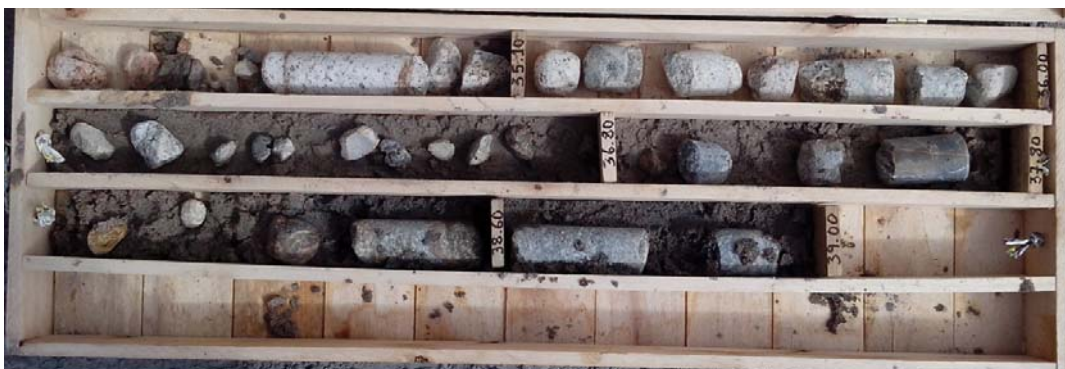
Fotografía 47 – Vista de la Caja de Perforación P-03 del Tramo 9.70 a 14.30 m.
