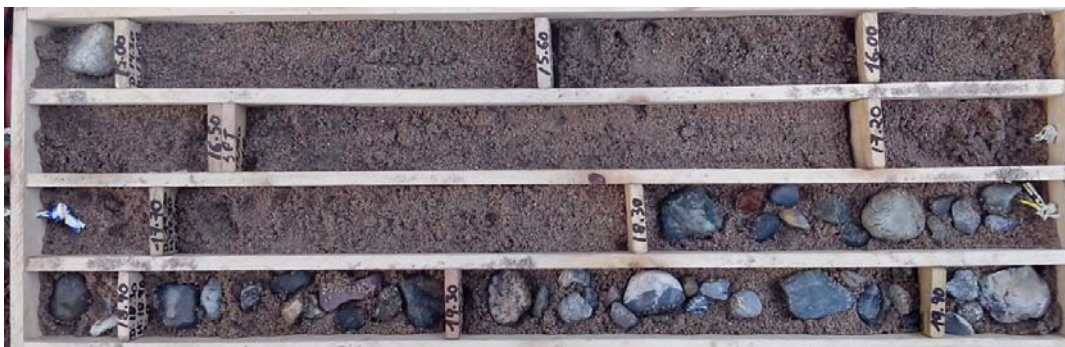
Fotografía 41 – Vista de la Caja de Perforación P-02 del Tramo 14.80 a 20.00 m.
