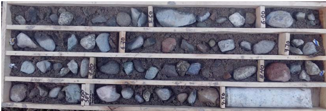
Fotografía 39 – Vista de la Caja de Perforación P-02 del Tramo 5.00 a 9.70 m.
