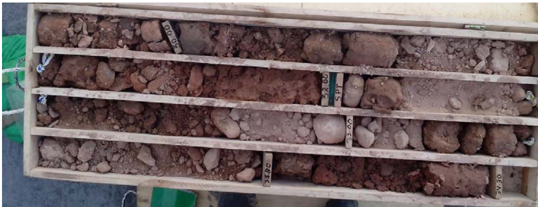
Fotografía 46 – Vista de la Caja de Perforación P-03 del Tramo 5.00 a 9.70 m.
